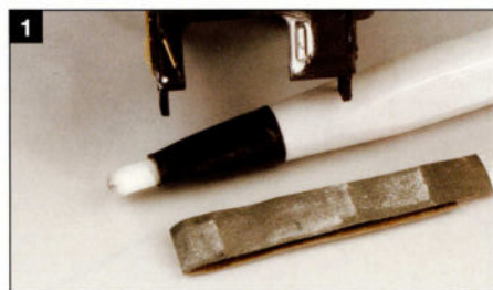
1. Les orifices de montage obturés des déflecteurs sont ensuite travaillés avec une bandelette de très fin papier abrasif, pour qu'ils deviennent parfaitement plans. Les restes d'enduit dans les coins et les endroits difficiles d'accès peuvent être éliminés au moyen
