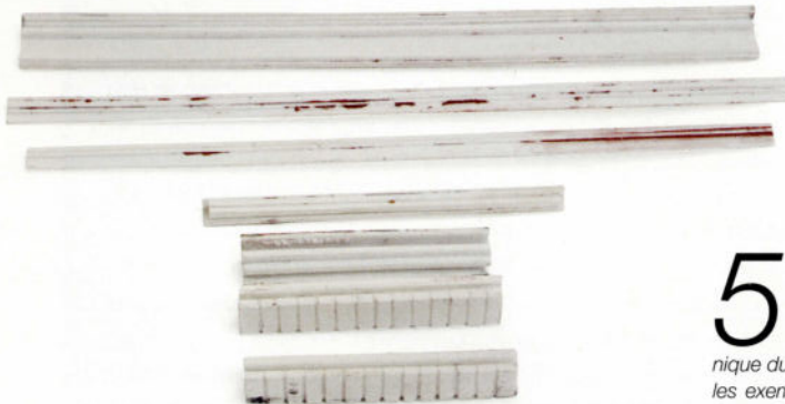
4. Une vue des pièces-mères. Remarquez les encoches dans les colonnes, pour les coins. Ces encoches ont une épaisseur de 1,5 mm, ce qui permettra d'y insérer des parois en plasticard de même épaisseur.
