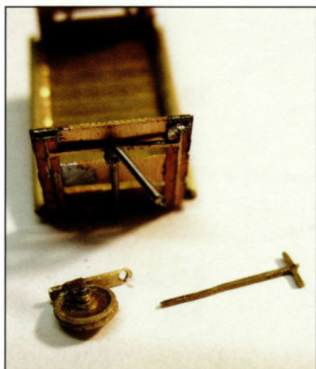
Un fil d'acier de 0,5 mm d'épaisseur servira d'axe d'essieu.
