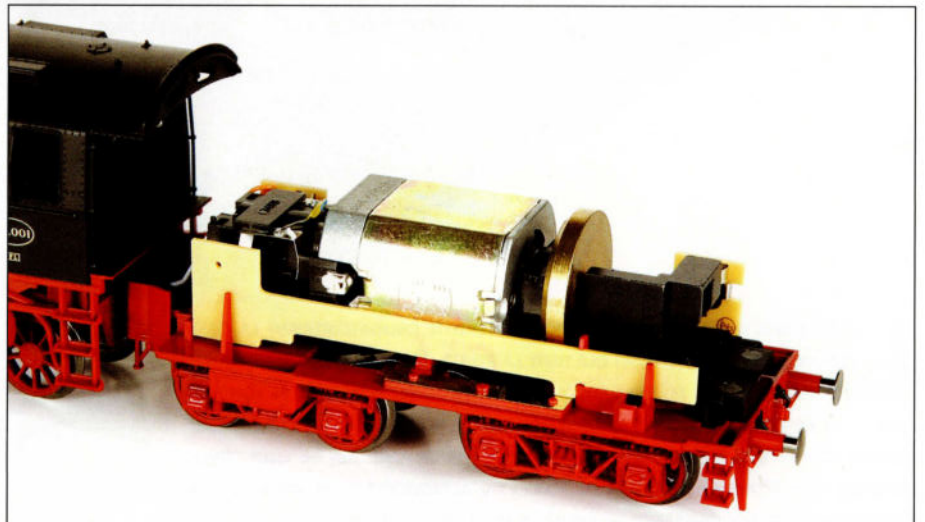
La motorisation est constituée d'un moteur cylindrique, disposé dans le tender. La transmission se réalise par deux vis sans fin sur les essieux extrêmes du tender.
