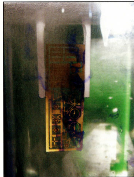
La plaque qui vient d'être gravée peut être débarrassée des restes de vernis, en la plaçant à nouveau dans le bac de développement.
