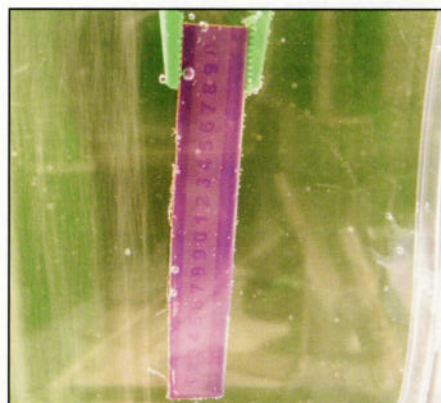
La plaque d'essai peut maintenant être agitée dans le révélateur.
