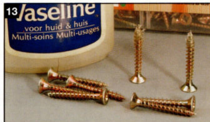
13 Les vis peuvent se lubrifier lors de la rentrée mécanique dans le bois. Il suffit pour cela de recouvrir la pointe de la vis d'une goutte de vaseline.
