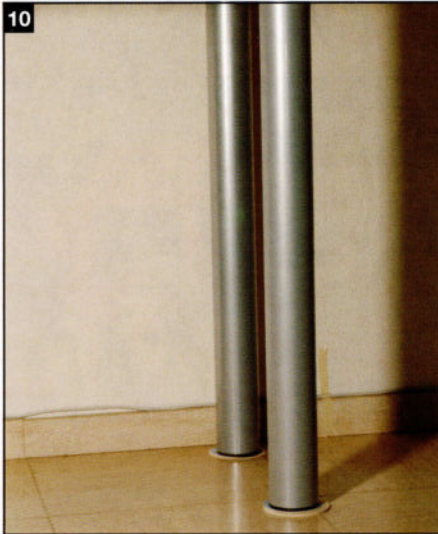
10 Fixez de préférence les pieds à vingt centimètres de profondeur à l'intérieur du cadre. Vous éviterez ainsi tout risque de cognement.
