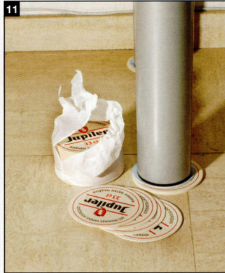
11 L'utilisation de dessous-de-verre pour réaliser la mise à niveau est une méthode peu orthodoxe, mais très pratique.
