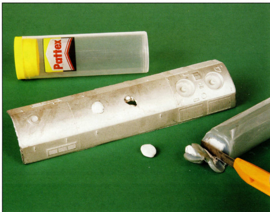
Un trou occasionné dans une toiture par un fer à souder peut être rempli par de l'acier modelable, de façon invisible.
