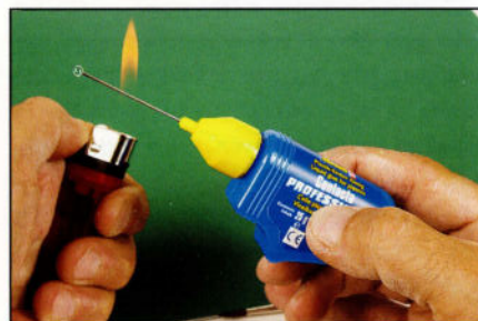
Un embout bouché peut être découché en dissolvant la colle solidifiée à l'intérieur au moyen de la flamme d'un briquet.
