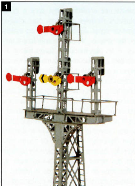
1. La construction d'un chandelier à trois mâtereaux de Jocardis. Son assemblage est bien expliqué au moyen de photos. Il s'agit d'un signal à deux positions, ce qui se voit aux rondeurs des palettes.
