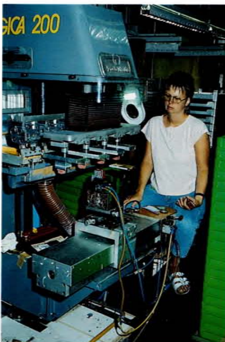
6. Deze tampografiemachine laat vier verschillende bedrukkingen toe.
