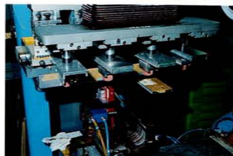
7. Op deze foto bemerkt u duidelijk de rode rubberen stempels waarmee de opschriften op de modellen worden aangebracht.
