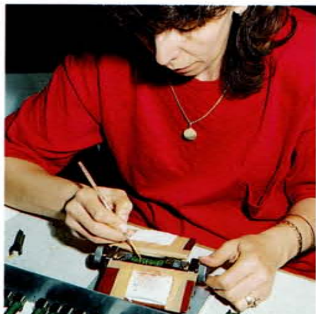
12. Een spitsvondig systeem voor het aanbrengen van de lijntjes op de ketel van deze MINI-CLUB-modellen.
