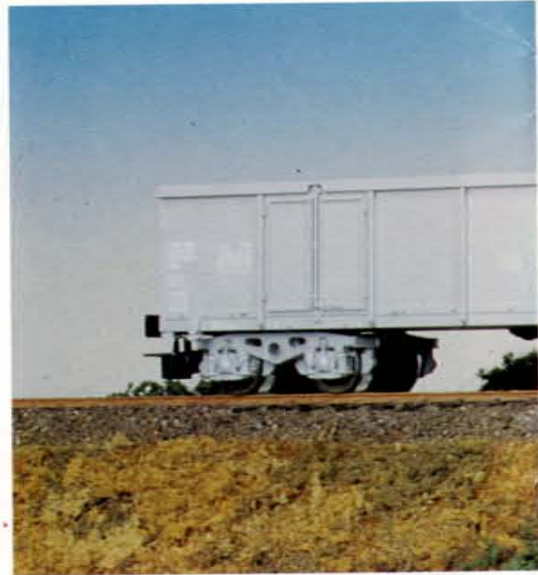
7. Possédant une livrée très originale, ces modèles suisses sont correctement équipés de bogies type "Y 25 moulé".
