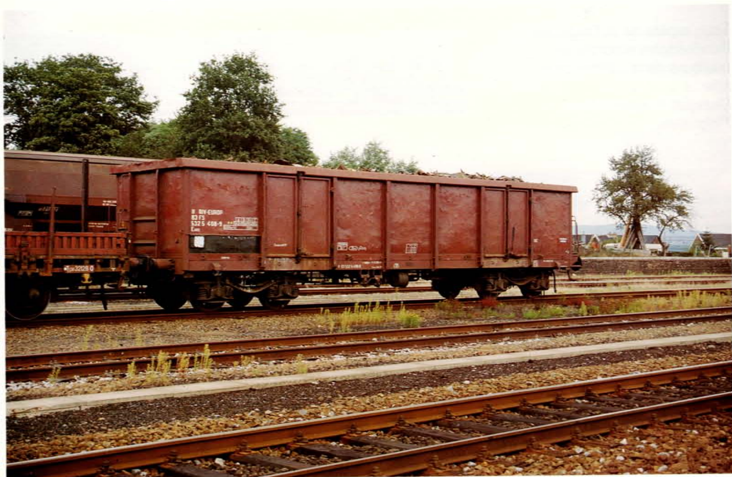
1. Wagon Eaos immatriculé aux FS. Hormis les tampons de forme circulaire, ce modèle s'apparente à la forme la plus courante des types Eaos.
