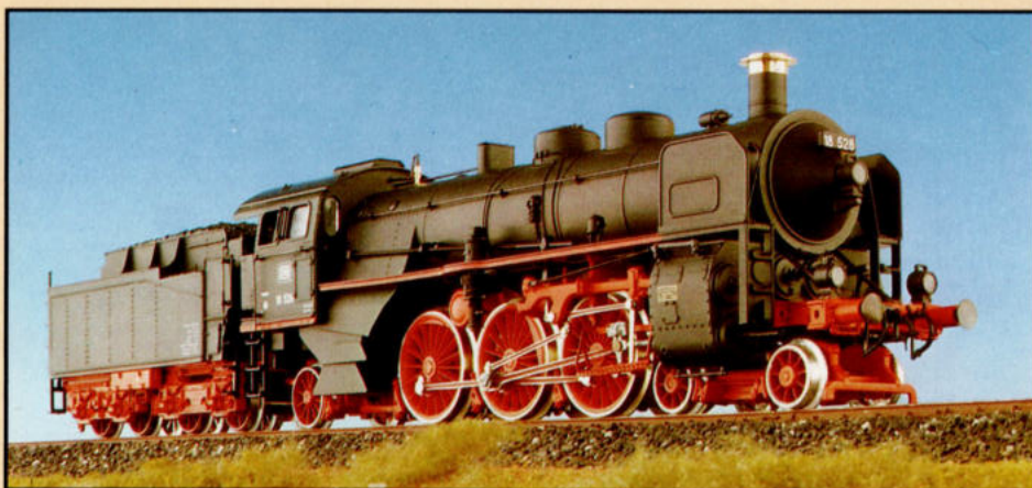
31. De 18 528 is het eerste model dat met het nieuwe aandrijvingsmechanisme van RIVAROSSI is uitgerust.
