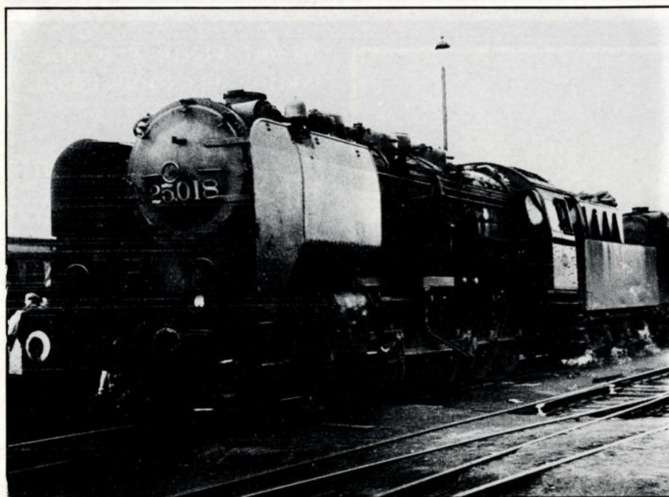
2. De 50.1539 van de „DR” werd op de Duitsers buitgemaakt en kreeg bij de N.M.B.S. het nummer 25.018. Deze lok is een typisch voorbeeld van de klassieke uitvoering van de BR 50 met grote windleiplaten, vier opbouwen op de ketel, een stoombel enz. De foto werd gemaakt in de stelplaats van Schaarbeek in 1947. Foto : F. Keutgens
