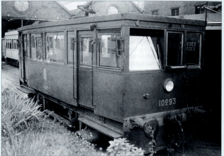
De tweede elektrische tractor, de 10293, werd gebouwd op het chassis van het rijtuig C.2005. Op deze foto zien we rechts één van de rijtuigen van de reeks C.2000 t/m C.2005. Foto H.-G. HESSELINK, verzameling TSP.
