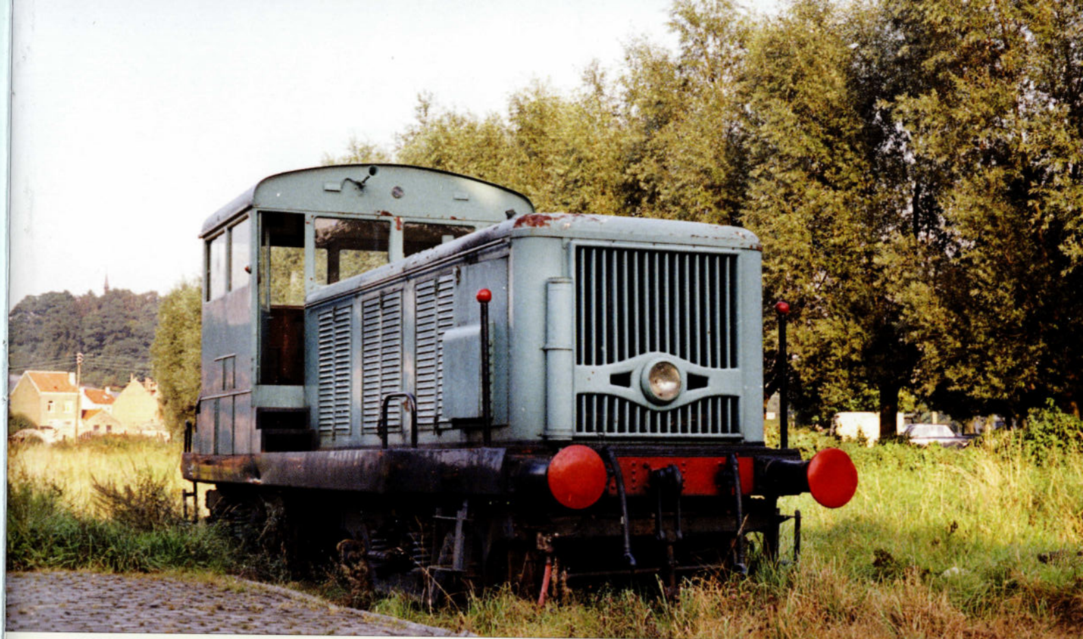
FOTO 131-60 Met de bedoeling de stoomtractie af te schaffen op de normaalsporige buurtspoorweglijn Groenendaal - Overijse liet de NMVB in hun werkplaats te Kuregem een diesellocomotief bouwen. Zij droeg het nummer ART.500, was uitgerust met twee GM-dieselmotoren van 175 pk elk en een hydraulische overbrenging. Zij kwam in dienst op 3 juni 1949. Na haar buitendienststelling werd zij, samen met het baanvak Hoeilaart - Groenendaal, verkocht aan de zagerij Marien te Hoeilaart die over een spooraansluiting beschikte. Zij zou er ingezet worden voor het vervoer van hout tussen Hoeilaart en Groenendaal, maar werd nooit gebruikt. In januari 1968 werd zij aangekocht door de firma Graver te Willebroek. Zij reed op eigen kracht van Hoeilaart naar Willebroek. Deze foto werd genomen in september 1966 te Hoeilaart. Foto André WITMEUR, verzameling TSP.
