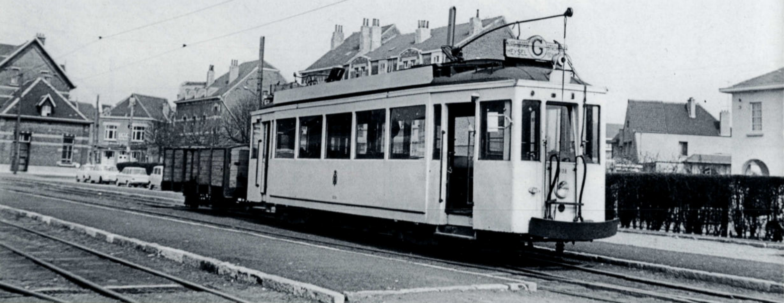
Op 5 februari 1965 staat de motorwagen 10139 van de NMVB stil te Grimbergen. Hij draagt het koersbord "G" wat staat voor de lijn Grimbergen - Brussel-Noord via de Heizel. Hij maakt deel uit van een onderreeks van 22 motorwagens gebouwd door Baume et Merpent in 1935 en genummerd van 10126 t/m 10147. Foto H.-G. HESSELINK, verzameling TSP.
