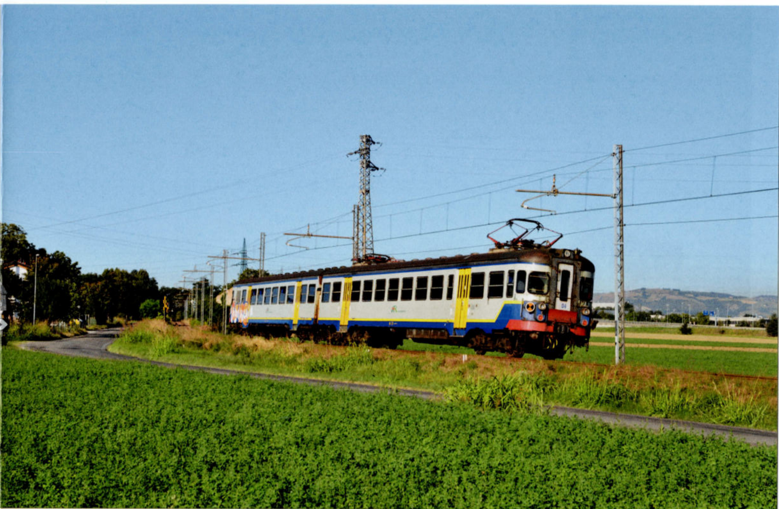
FOTO 131-38 De 04 kon, ondanks zijn overname door TPER, zijn GTT-tooi bewaren. Op 8 september werd het stel, tijdens een rit naar Sassuolo, vereeuwigd tussen Formigine en Sassuolo. De motorstellen rijden steeds, gezien in de rijrichting, met de achterste stroomafnemer opgeheven. Gwenaël PIERART.
