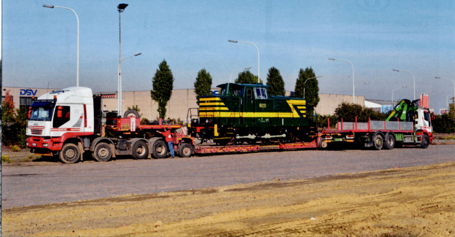
FOTO 131-04 De 8051 wacht, geladen op een dieplader, op haar vertrek vanuit Schaarbeek naar haar nieuwe verblijfplaats te Oostmalle. Om het wegverkeer niet te hinderen, gebeurde de verplaatsing 's nachts. TSP, 2 november 2015.
