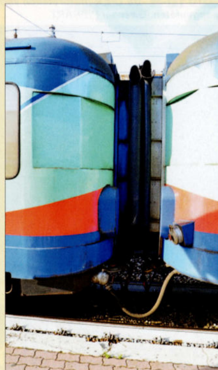
FOTO 131-41 De oude postmotorstellen 961 en 965 werden permanent aan elkaar gekoppeld. Zodoende konden beide stuurposten, gelegen aan de gekoppelde kant, verwijderd worden. Deze omvorming gebeurde al in de RSI-werkplaats van Oostende (zie OP DE BAAN 68 pagina's 36-37).
