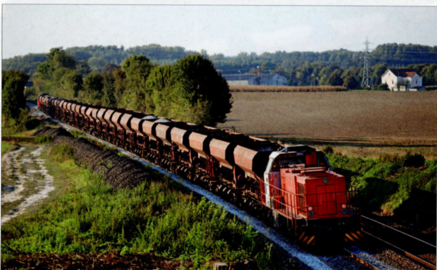
Een typische opdracht voor locomotieven "petits calibres": twee machines G1206 met ballastrein 800264 tijdens werken op de lijn Tergnier - Laon op 3 oktober 2014. De positie van de twee locs laat toe om gemakkelijk van rijrichting te kunnen veranderen. Gilbert LAURENT.
