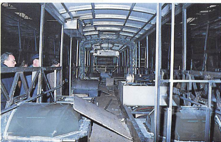
Het onderstel van een gelede bus. Het koetswerk tijdens de inrichting.
