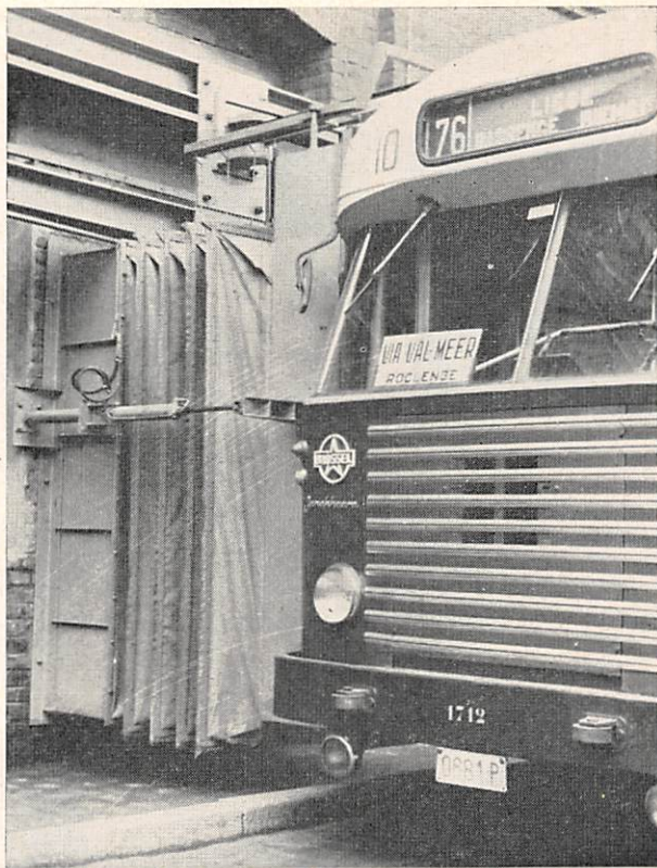
De rekbare tunnel is verbonden met de voordeur van de autobus.
