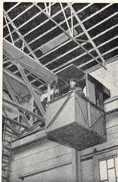
De elektrische rolbrug die de ruwe platen naar de automatische machine brengt.
