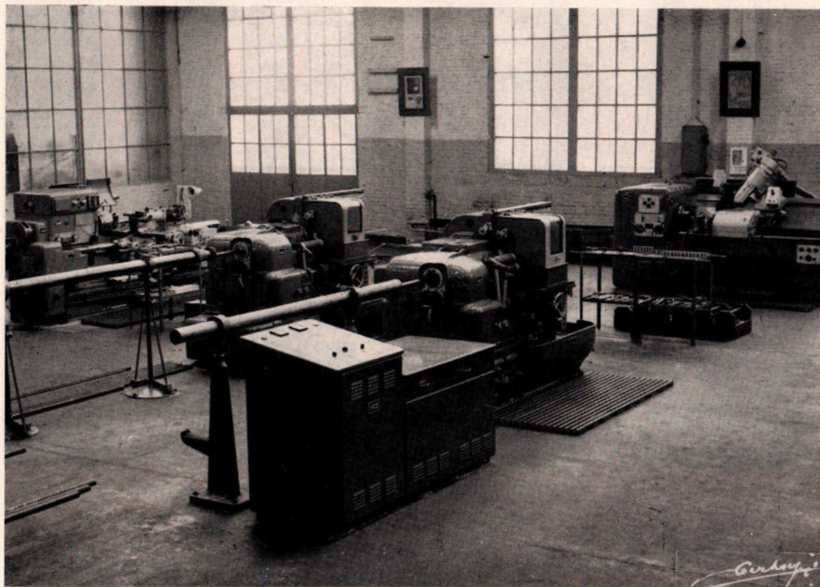
Fig. 2. — Werkplaats te Destelbergen (Gent) — Revolverdraaibanken met groot productievermogen.
