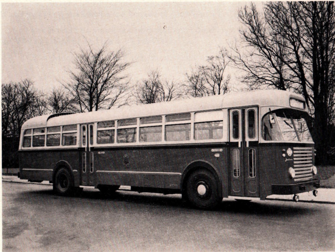
Fig. 21. — Buitenstedelijke autobus 89 plaatsen — Verlaagde kas — Verbeterd windscherm.
