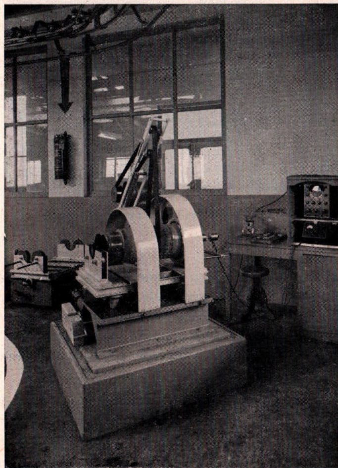
Fig. 8. — Werkplaats te Kuregem — Statische en dynamische balanceermachine voor ankers van tractiemotoren.
