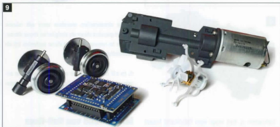
9. De aandrijving gebeurt met een krachtige Maxon-motor met een cardanverbinding naar de vier assen. Naast de motor blijft er voldoende plaats over voor de ventilatoren, een XL-decoder en een luidspreker.
