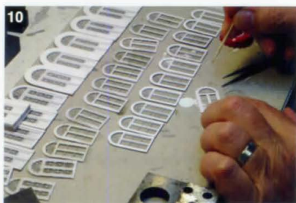
10 Ramen en deuren worden voorzien van glas en gefixeerd met secundelijm.
