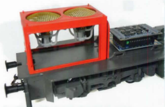
10. Elk model krijgt twee ventilatoren die via de ESU XL-geluidsdecoder afzonderlijk worden aangestuurd.
