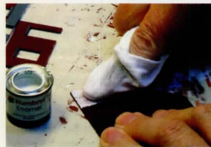
Afwrijven van de overtollige verf.
