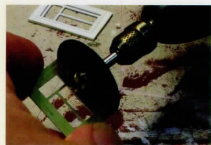
Afslijpen van de bramen met het mini-slijpschijfje.
