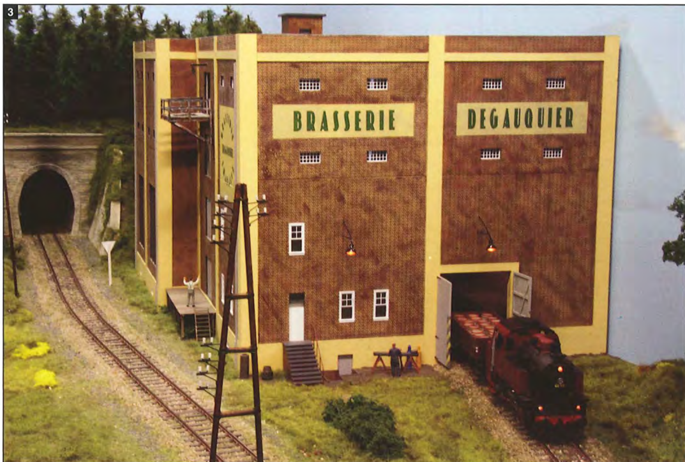
3. De brouwerij is gebouwd op een basis van 8mm multiplex. Baksteenmotief komt van Slaters, de betonnen structuur is 2 mm dik ingekleurd karton. De opschriften werden met de PC opge- maakt en op decal afgedrukt. Stoomloek GF02 (ex BR80) neemt een lading biervaten mee.
