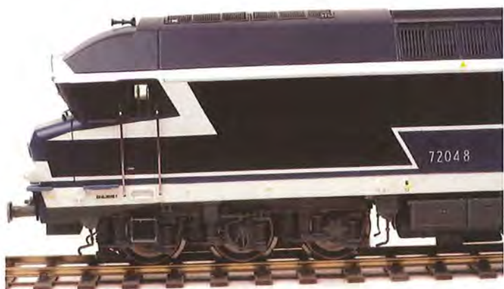
Zijaanzicht op de draaistellen en de zijdelingse verluchtungsroosters.
