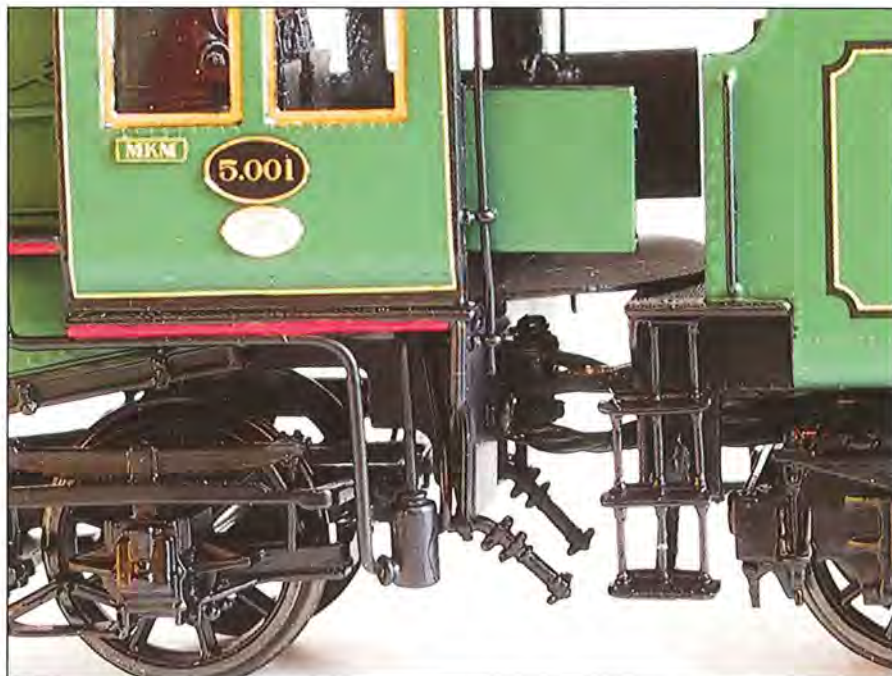
Loc en tender zijn op een realistische manier vast gekoppeld. De getorste stroomdraden vallen echt niet op. Het draaiplateau tussen loc en tender kan omhoog worden geklapt.
