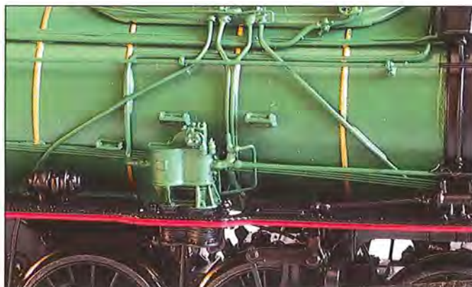
Op de omloopplaat is links een turbo-generator van het merk Pyle merkbaar. Centraal staat de bicomponent Westinghouse luchtpomp.
