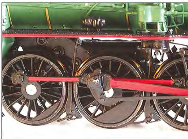
Merk de leiding van de zandstrooiinstallatie. Deze loopt van de zandkist over de ketel door tot onderaan het wiel. Van een realistische aanpak gesproken.
