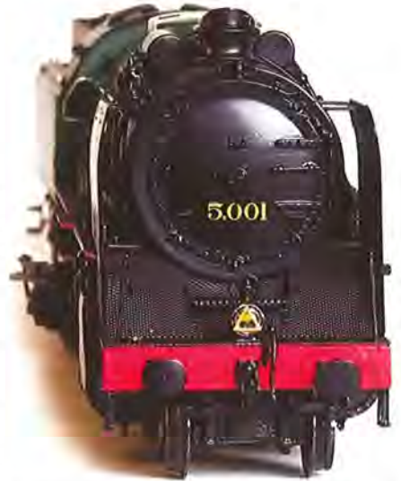
Voorraanzicht van de 5.001. Merk de centrale lamp op de bufferbalk. Op de rookkast merk je het bevestigingspunt voor de lamp op de rookkastdeur. Deze is in model niet voorzien.
