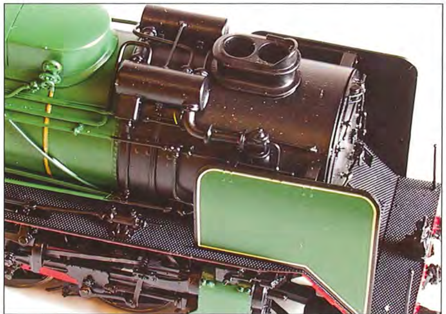
Alle noodzakelijke leidingen zijn bij de ACFI voorverwarmingsinstallatie aanwezig.
