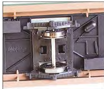
De middelste as van het GCI rijtuig is verschuifbaar in de breedte. Je merkt dat deze as over de bovenste treeplank tot tegen de onderste treeplank schuift. Door deze beweeglijkheid gaat het rijtuig prima door alle bochten en wisselstraten.
