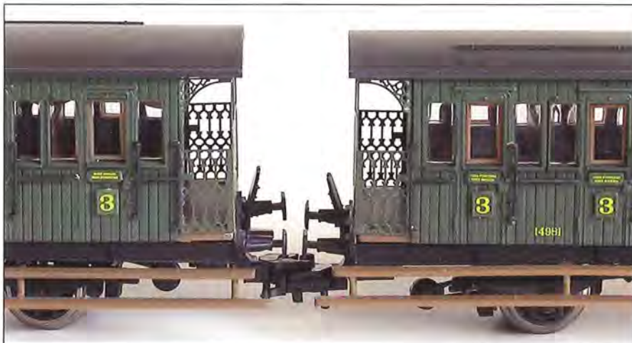
Kortgekoppeld ziet de verbinding er zo uit. De mindere nauwkeurigheid van de Chinese montageploeg blijkt uit één van de buffers. Deze had wat rechter mogen staan.
