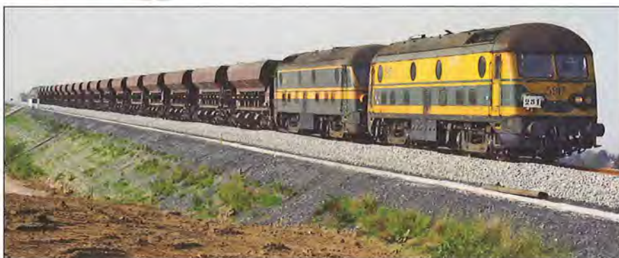
Op het einde van hun loopbaan werden locomotieven van de reeks 59 ingezet voor het slepen van ballasttreinen bij de constructie van de hoge snelheidslijnen. Hier zien we een fraaie treinschakeling van de 5917 met de 5946 te Sully (hogesnelheidslijn L1) op 12 oktober 2012. Achteraan de trein bevindt zich een gelijkaardig duo.
