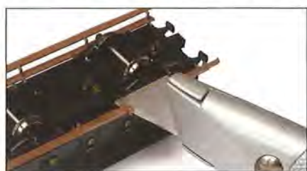
De treeplanken worden afgeschuind door af-schaven met behulp van een cutter.
