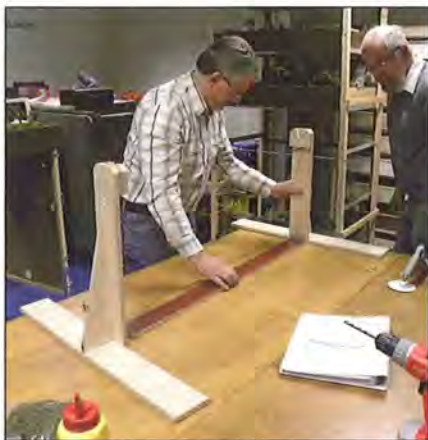
Opstellen van de montagebok
