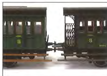
De voornaamste taak voor het superen van deze modellen bestaat erin de treeplanken dunner te doen lijken en ze te weatheren. Als optie: het plat leggen van de overstaptreden en het zwart schilderen van het ijzerwerk.
