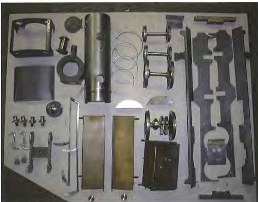
Dit zijn de onderdelen, één voor één geneden, gezaagd, gefreesd, gedraaid, ... waaruit een life-steam loc ontstaat.
