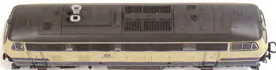
Onder de opengewerkte dakrooster bevindt zich één van de twee luidsprekers.
