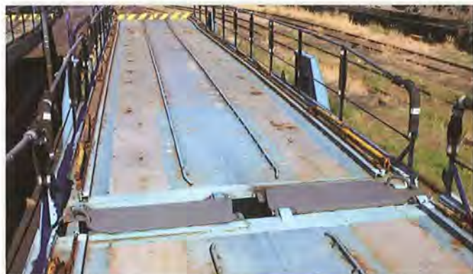
Het bovendek van de Laaers van Cobelfret. Let op de autoklemmen aan beide zijden van de wagen, Sati Antwerpen 27 september 2008 (foto verz. GVM).
