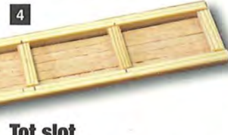
3 & 4. Met grenen latjes (3 x 4 mm) wordt een frame gelijmd als basis voor de zijborden van de nieuwe laadbak. De binnenbeplanking wordt uitgevoerd met fijne latjes (Billing Boats 0,7 mm x 3 mm). Alles wordt verlijmd met witte houtlijm.
