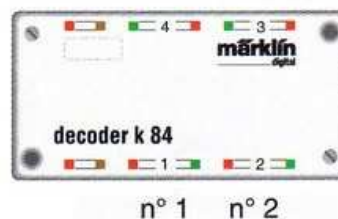
un décodeur k 84 peut remplacer un décodeur k 83 et quatre signaux
