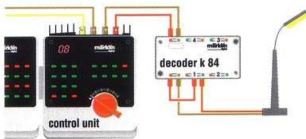
raccordement normal d'un éclairage au décodeur k 84
