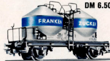
Behälterwagen für Feinschüttgut · 2-achsig · Modell des Kds 54 der DB in der Ausführung eines Privatwagens der Firma Franken-Zucker · Behälter silbern mit blauem Mittelteil · Untergestell schwarz · Länge 10 cm
