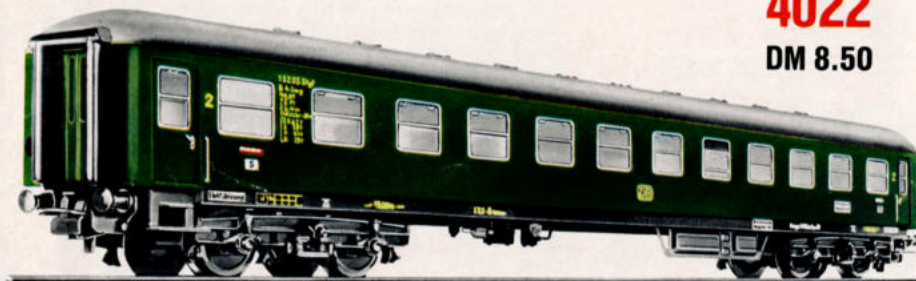
4022 D-Zug-Wagen · 2. Klasse · Modell der Deutschen Bundesbahn (B 4 üm) · 4-achsig · Abnehmbares Dach · Eingesetzte Fenster mit plastischen Rahmen · Dunkelgrün · Dach silbern, grau getönt · Länge über Puffer 24 cm
