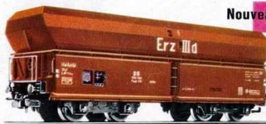
Wagon couvert à grande capacité · 4 essieux · Maquette du wagon 00tz 50 de la DB · Brun avec inscriptions d'un transport de minerai · Longueur: 13,3 cm
