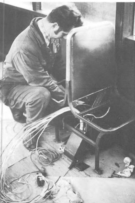
Het maken van de elektrische verbindingen onder de kleine middenzit.
