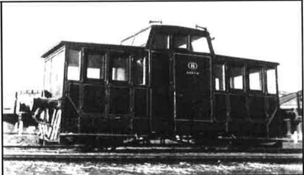
**Tracteur type 7 : moteur essence 100 CV, transmission par chaîne, vitesse maxi 40 km/h. Il servait à transporter wagons et matériaux destinés aux chantiers de travaux des voies.**
