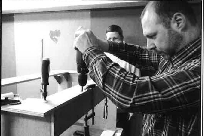
Ne pas oublier de fraiser pour permettre à la vis d'être au niveau de la plaque afin de ne pas s'accrocher les vêtements...
