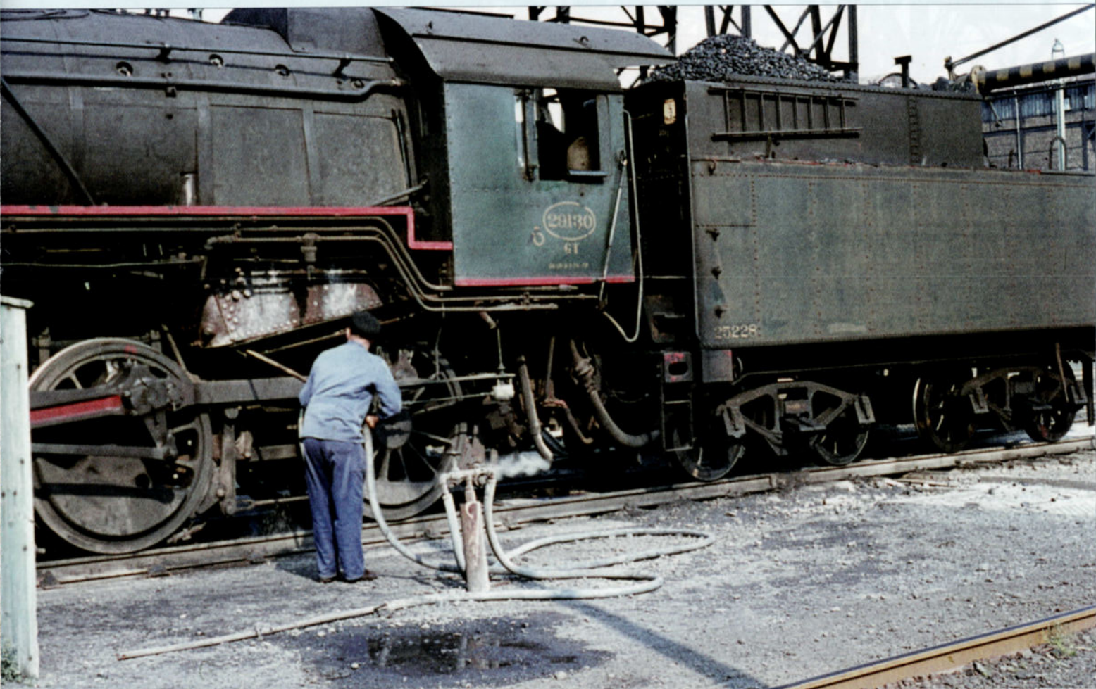
PHOTO 136-47 Ci-dessous, nettoyage de la grille du foyer à l'aide d'un tuyau de vapeur, un geste du métier qui disparaîtra dans moins d'un an... Photos Hugo NAUWELAERTS, collection PFT.
