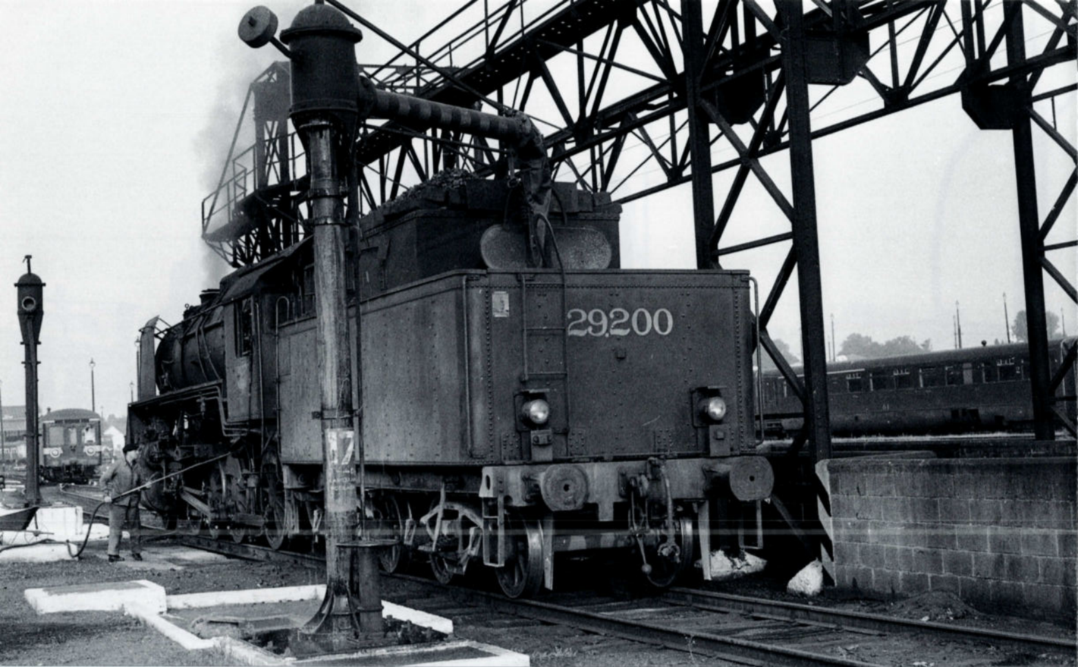
PHOTO 136-48 ↑ - PHOTO 136-49 ↓ Le 10 septembre 1966 à Kortrijk, la 29.200 de la remise d'Aalst se prépare pour le voyage du retour : prise d'eau et nettoyage de la grille du foyer. Tout un monde qui n'avait plus que pour quelques semaines à vivre. Cette type 29, construite par Canadian Locomotive Company (n° 2327), débuta sa carrière au dépôt d'Ottignies le 20 août 1946. Elle sera par la suite mutée aux remises de Kortrijk (12 juin 1957), Ronet (27 février 1958), Bertrix (24 novembre 1958), Latour (27 septembre 1963), Ronet (15 janvier 1965) et enfin Merelbeke (2 février 1966) où elle acheva sa carrière à l'annexe d'Aalst. Considérée comme réserve réseau, elle fut mutée le 6 février 1967 à Leuven et fut réformée le 20 avril 1967. Photos Hugo NAUWELAERTS, collection PFT.
