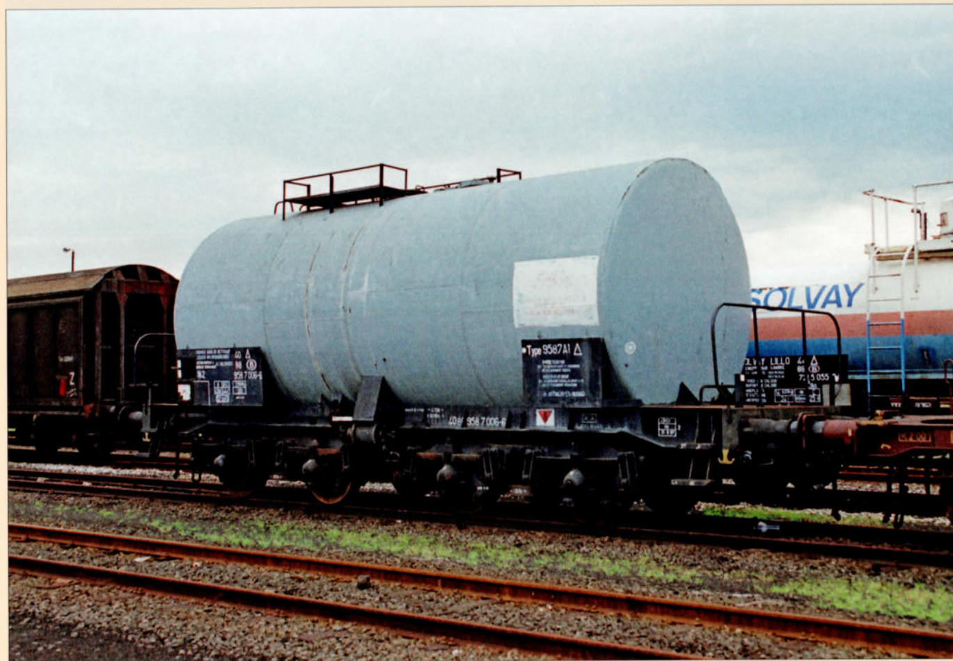
Un de ces wagons fut préservé par le Patrimoine Historique de la SNCB. Il s'agit de l'ex. 93343, n° 40 88 958 7006-6. Il a conservé ses bogies d'origine et est équipé de boîtes d'essieux à rouleaux. Le voici à l'atelier de wagons d'Antwerpen-Noord le 29 mai 1992. Il fera sous peu partie de la collection du PFT. Michel THIRY.
