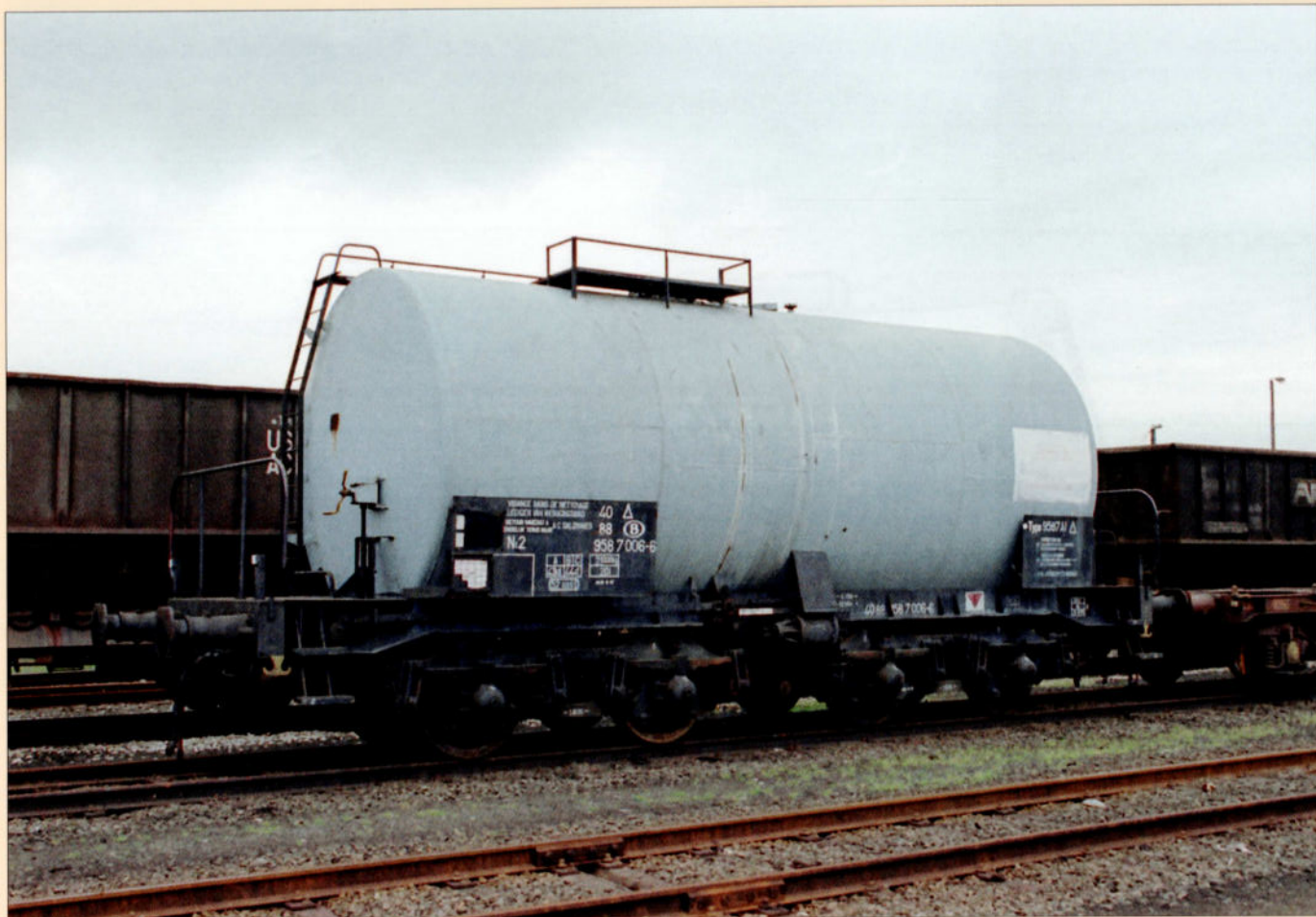
Un de ces wagons fut préservé par le Patrimoine Historique de la SNCB. Il s'agit de l'ex. 93343, n° 40 88 958 7006-6. Il a conservé ses bogies d'origine et est équipé de boîtes d'essieux à rouleaux. Le voici à l'atelier de wagons d'Antwerpen-Noord le 29 mai 1992. Il fera sous peu partie de la collection du PFT. Michel THIRY.
