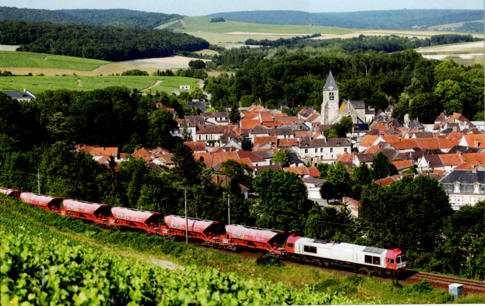
Autre mouvement Givet – Brétigny qui traverse ici la gare d'Avenay-Val-d'Or (sur la voie unique Epernay - Reims) le 17 juin 2015 en marche 64210. La traversée des installations s'effectue en circulation à droite en application d'une consigne régionale (passage sur la voie la plus éloignée du bâtiment voyageurs). Gilbert LAURENT.
