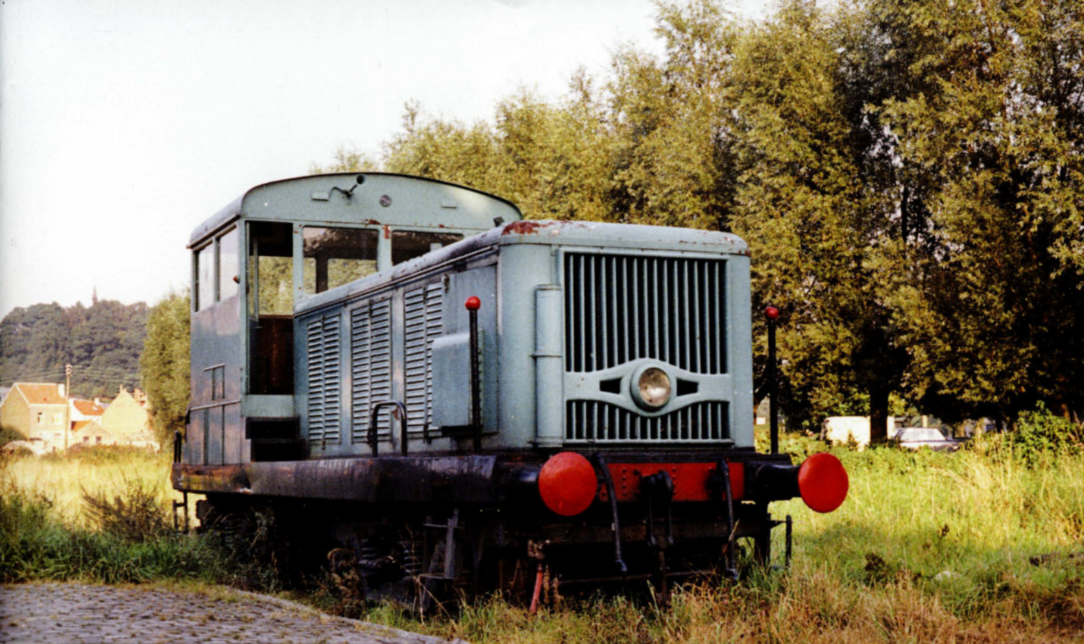
PHOTO 131-60 Dans le but de supprimer la traction à vapeur sur la ligne vicinale à écartement normal Groenendael - Overijse, la SNCV fit construire dans ses ateliers de Cureghem une locomotive Diesel. Numérotée ART.500, elle était équipée de deux moteurs Diesel GM de 175 CV chacun et d'une transmission hydro-mécanique. Elle fut mise en service le 3 juin 1949. Après sa mise hors service, elle fut vendue, ainsi que la section Hoeilaart - Groenendael, à la scierie Marien à Hoeilaart qui possédait un raccordement. Elle aurait dû servir pour le transport de bois entre Hoeilaart et Groenendael, mais elle n'a jamais été utilisée. Par après, en janvier 1968, elle fut acquise par la Compagnie Graver à Willebroek. Elle se rendit par ses propres moyens de Hoeilaart à Willebroek. Cette photo a été prise en septembre 1966 à Hoeilaart. Photo André WITMEUR, collection PFT.
