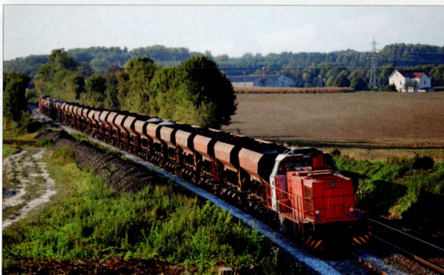
Une occupation de base pour les "petits calibres" : deux G1206 placées de façon à assurer la réversibilité sont ici en charge d'une rame de ballast lors de la régénération de la ligne Tergnier - Laon. Train 800264 du 3 octobre 2014. Gilbert LAURENT.
