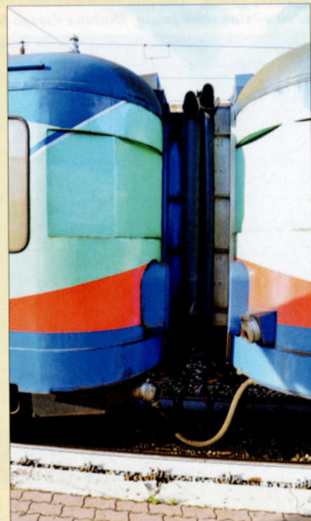
PHOTO 131-41 Les anciennes automotrices postales 961 et 965 ont été accouplées en permanence. De ce fait, sur chacune d'elles, le poste de conduite situé côté accouplement a été supprimé. Cette transformation avait déjà été réalisée à l'atelier RSI d'Oostende (voir EN LIGNES 68 pages 36-37). Pierre HERBIET.
