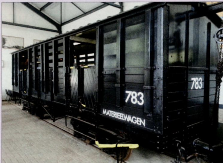
↑ Le wagon à bogies 783 a été fourni par La Métallurgique en 1906 et faisait partie du train de secours. Ouddorp, 21 avril 2014. Photo MAURITZ90.
