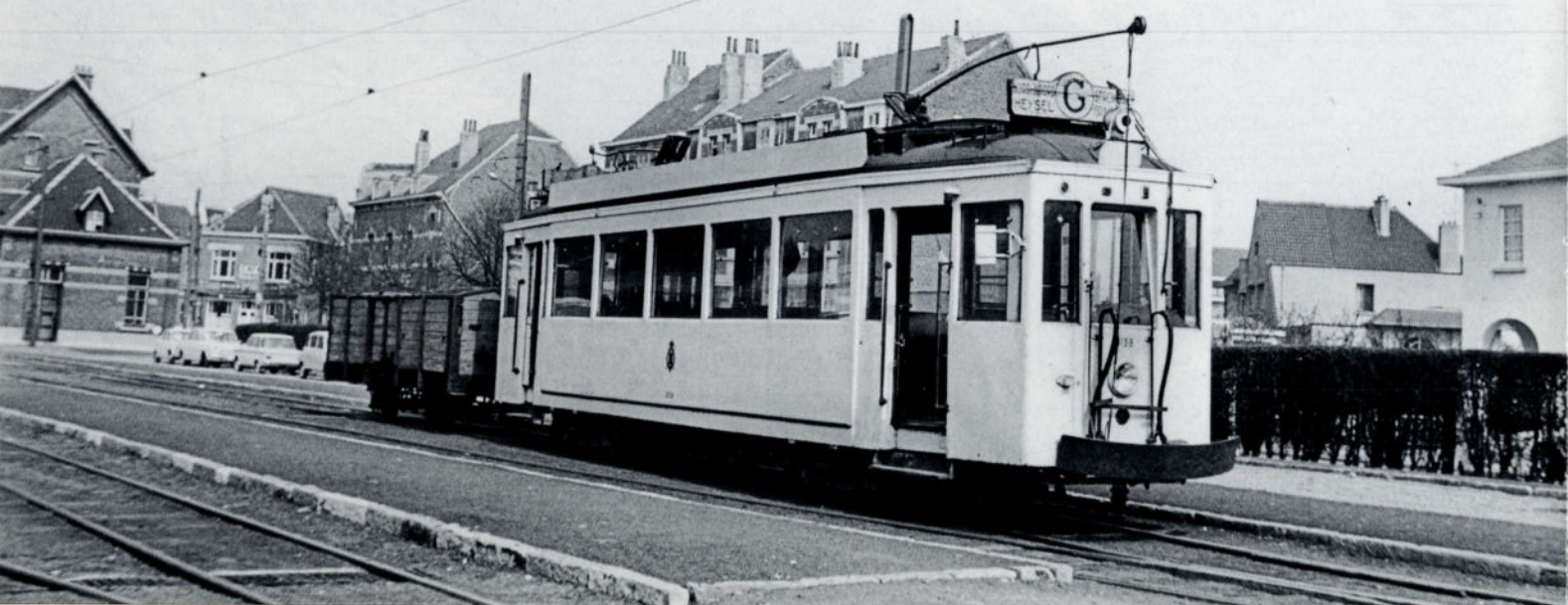
Le 5 février 1965, la motrice 10.139 de la SNCV stationne à Grimbergen. Elle porte la plaque G desservant la ligne Grimbergen - Bruxelles-Nord via le Heysel. Elle fait partie d'une sous-série de 22 motrices construites par Baume et Merpent en 1935 et numérotées 10126 à 10147. Photo H.-G. HESSELINK, collection PFT.
