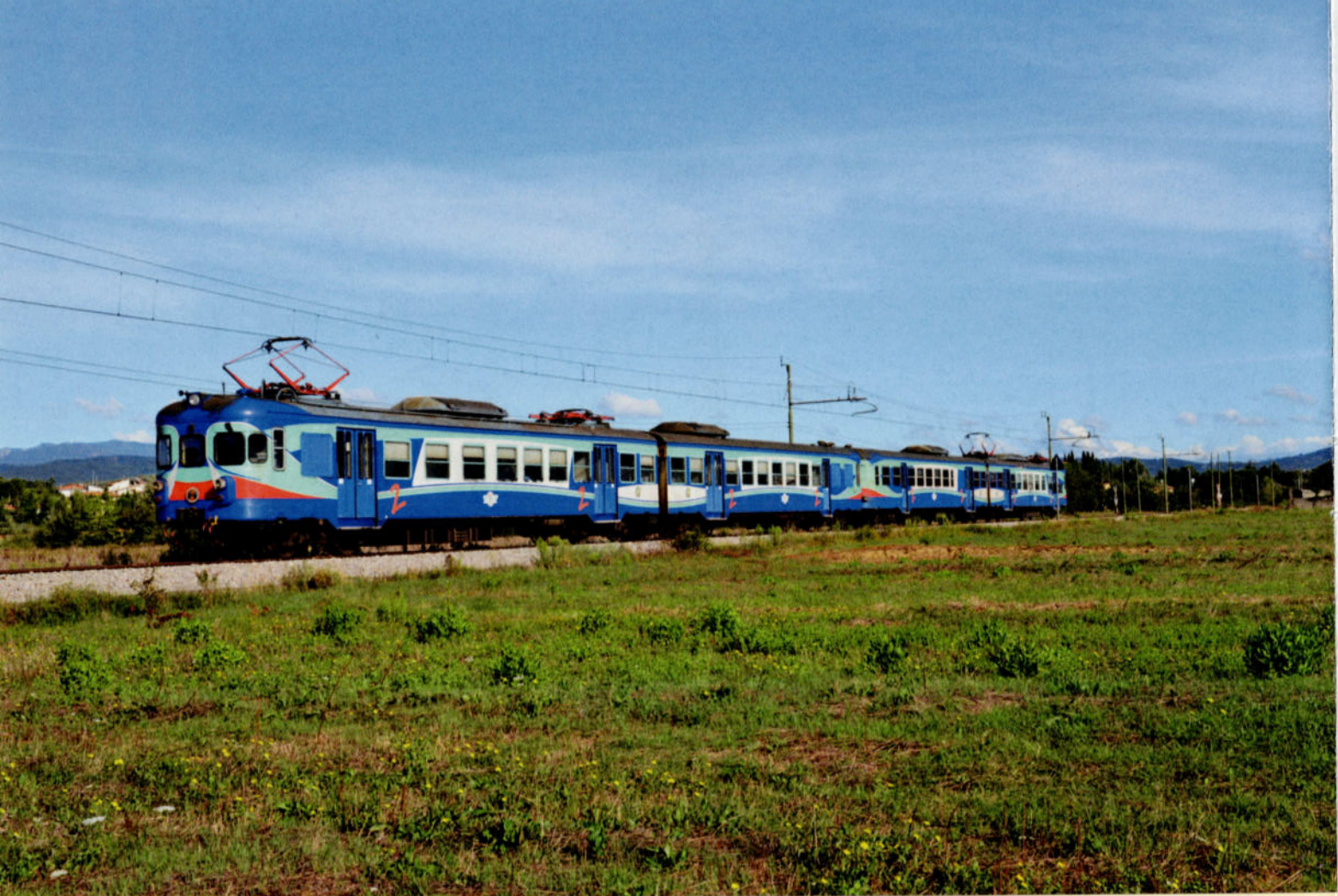
PHOTO 131-40 Voici l'automotrice quadruple ALe 54.961 en passage à Puglia Ceciliano. Il s'agit des anciennes automotrices postales 961 et 965 transformées et accouplées en permanence. Gwenaël PIÉRART.
