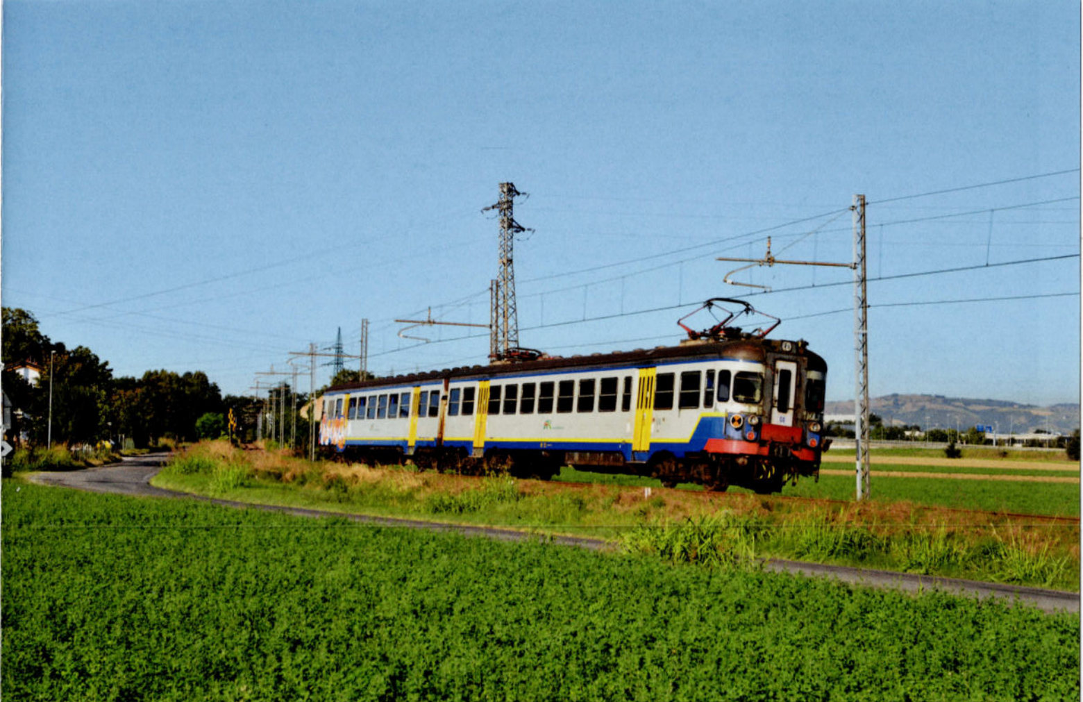
PHOTO 131-38 Depuis son rachat par le TPER, la 04 a conservé sa livrée GTT. Le 8 septembre 2015, elle est photographiée entre les gares de Formigine et Sassuolo. Les automotrices circulent toujours avec le pantographe arrière levé dans le sens de marche. Gwenaël PIÉRART.
