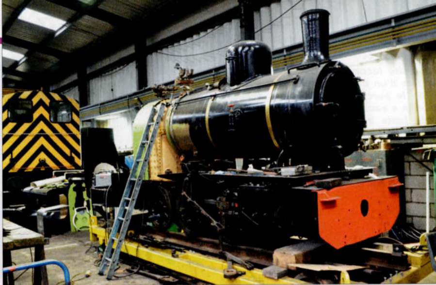
PHOTO 127-56 ↑ La Ty 3297 en cours de révision dans l'atelier du North Norfolk Railway à Sheringham, où se trouve également la chaudière de notre 26.101. Gwenaél PIÉRART, 1er septembre 2014.
