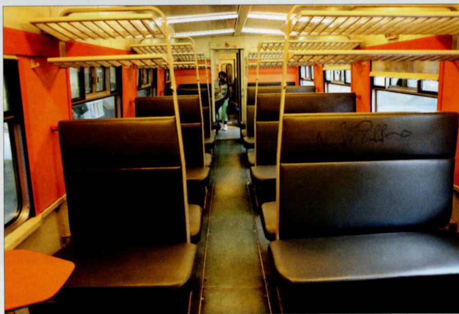
PHOTO 127-16 ↑ - PHOTO 127-17 ↓ Deux vues comparatives d'un compartiment de seconde classe. Les porte-bagages sont maintenant placés longitudinalement.
