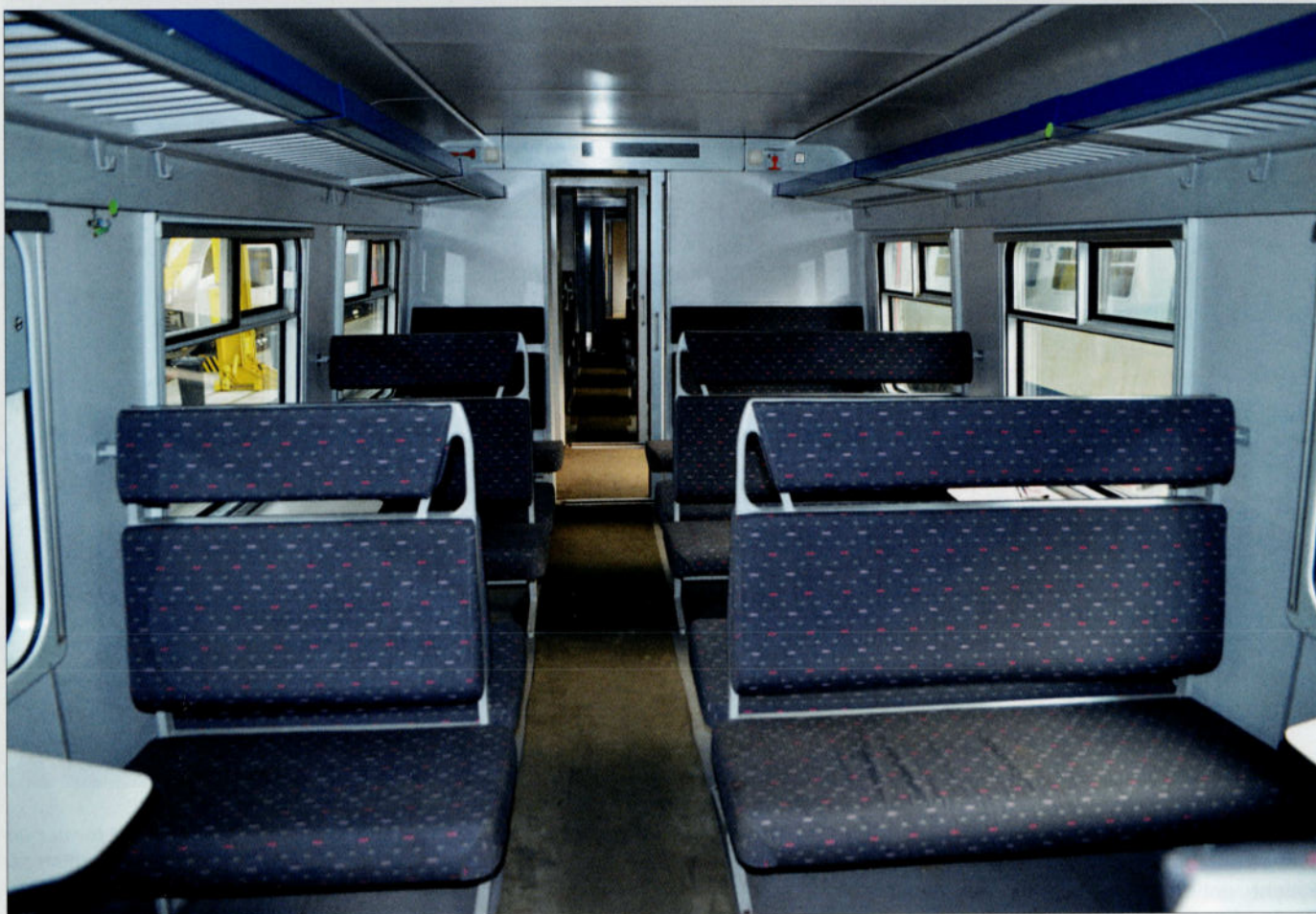
PHOTO 127-16 ↑ - PHOTO 127-17 ↓ Deux vues comparatives d'un compartiment de seconde classe. Les porte-bagages sont maintenant placés longitudinalement.
