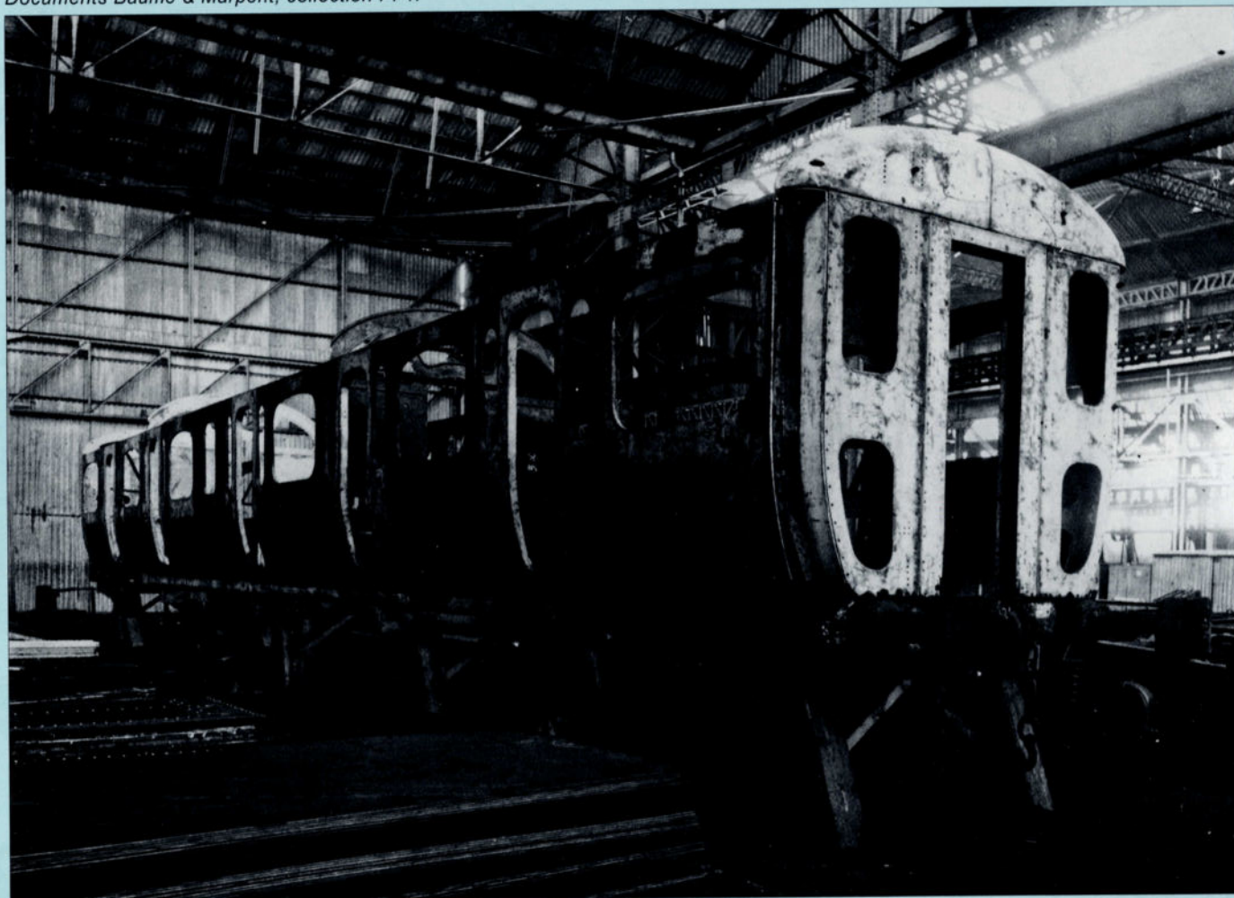
Une des six caisses d'une voiture de 3e classe de la série 15 à 20 du Nord-Belge, dans l'usine de Baume & Marpent. Documents Baume & Marpent, collection PFT.
