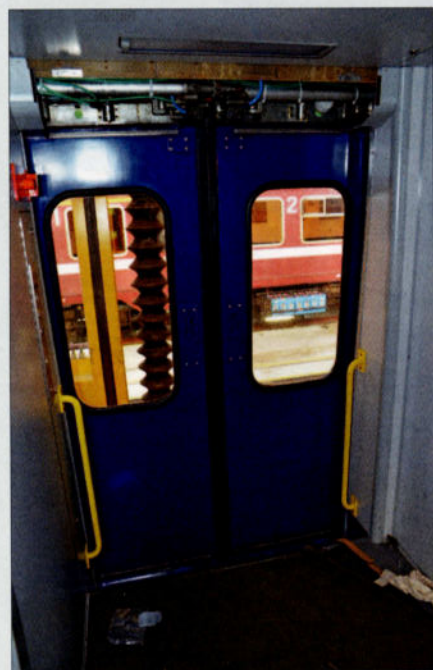
PHOTO 127-22 ↑ Les portes ont été conservées. Leurs poignées d'ouverture ont été remplacées par des boutons-poussoirs installés sur la paroi de gauche.
