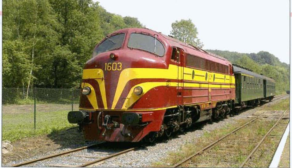
**PHOTO 80-03** L'arrivée de la P8 a quelque peu éclipsé la mise en service de la 1603 CFL, acquise par un membre et confiée en gestion au PFT. Elle a subi une réfection complète du nez qui avait été endommagé en 1958 et sur la Vennbahn. Le reste de la caisse sera restauré cet hiver. Dorinne-Durnal, 1er juin 2007. Photo PFT.
