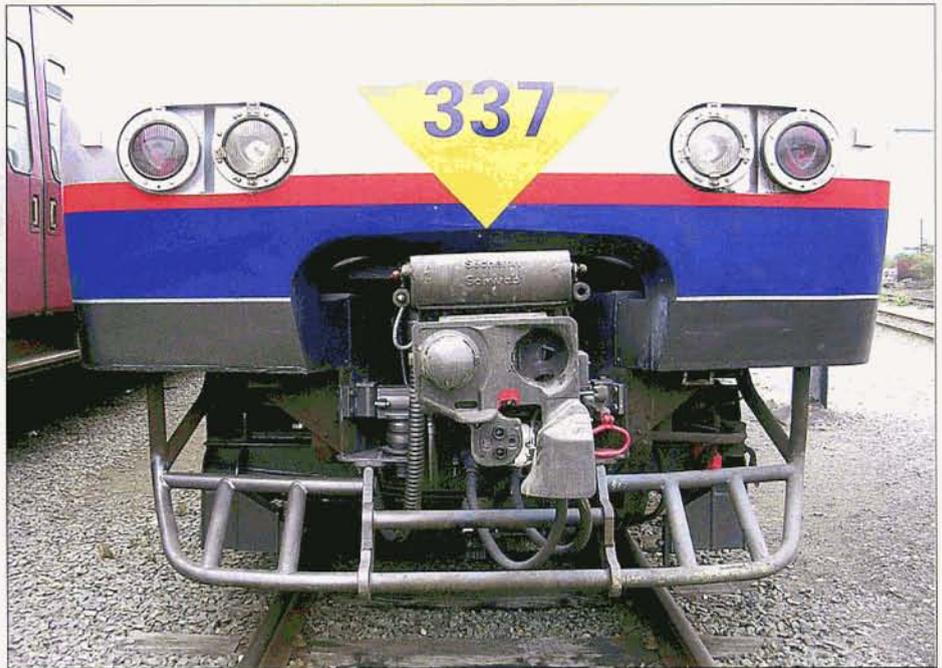
*Dans le cadre de la rénovation prochaine des automotrices Break, la 337 est ressortie de révision de l'Atelier Central de Mechelen le 19 juin 2007. A cette occasion, le carénage du bas de ses faces avant a été supprimé, ce qui n'est pas particulièrement esthétique. On peut comparer la photo de la 337 avec celle ci-dessous de la 409.* Michel SIMAR.
