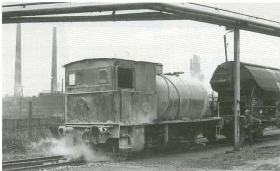
Gros plan de la locomotive. Les cylindres sont disposés à l'arrière, sous la cabine de conduite. La distribution est du type Walschaerts. A l'arrière plan : la cokerie du Marly.
