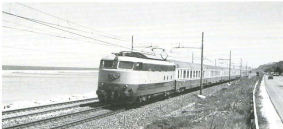
PHOTO 26-05 La toute dernière "Tartaruga" non transformée fut la E444.005. Ce prototype construit par TIBB en 1975 fut la première locomotive italienne équipée d'un hacheur. Elle est ici visible en tête d'un IC longeant la mer Adriatique non loin de Pesaro le 26 juin 1990. Photo : Jean-Luc VANDERHAEGEN.
