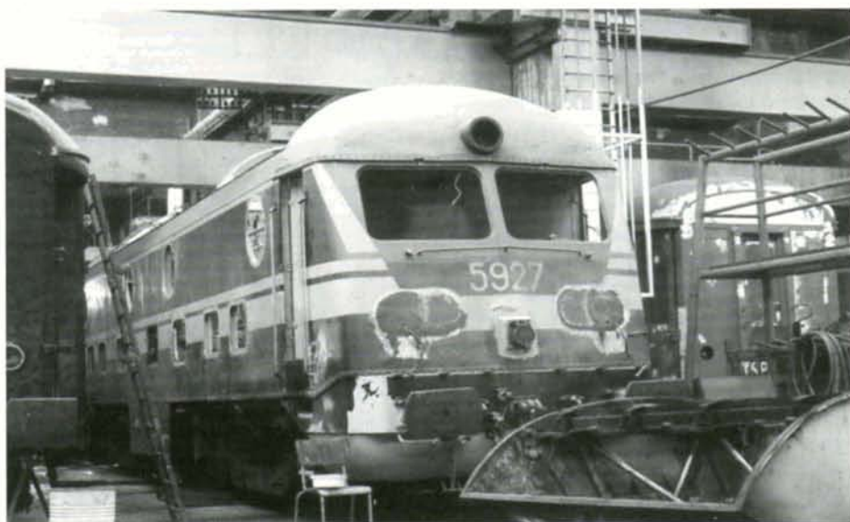
PHOTO 26-12 La 5927 tel qu'elle se présentait en avril : les doubles phares sont supprimés, les pare-brise, hublots, grilles d'aspiration d'air et l'ensemble de la toiture sont démontés, la salle de machine est à ce stade déjà entièrement révisée et repeinte.
