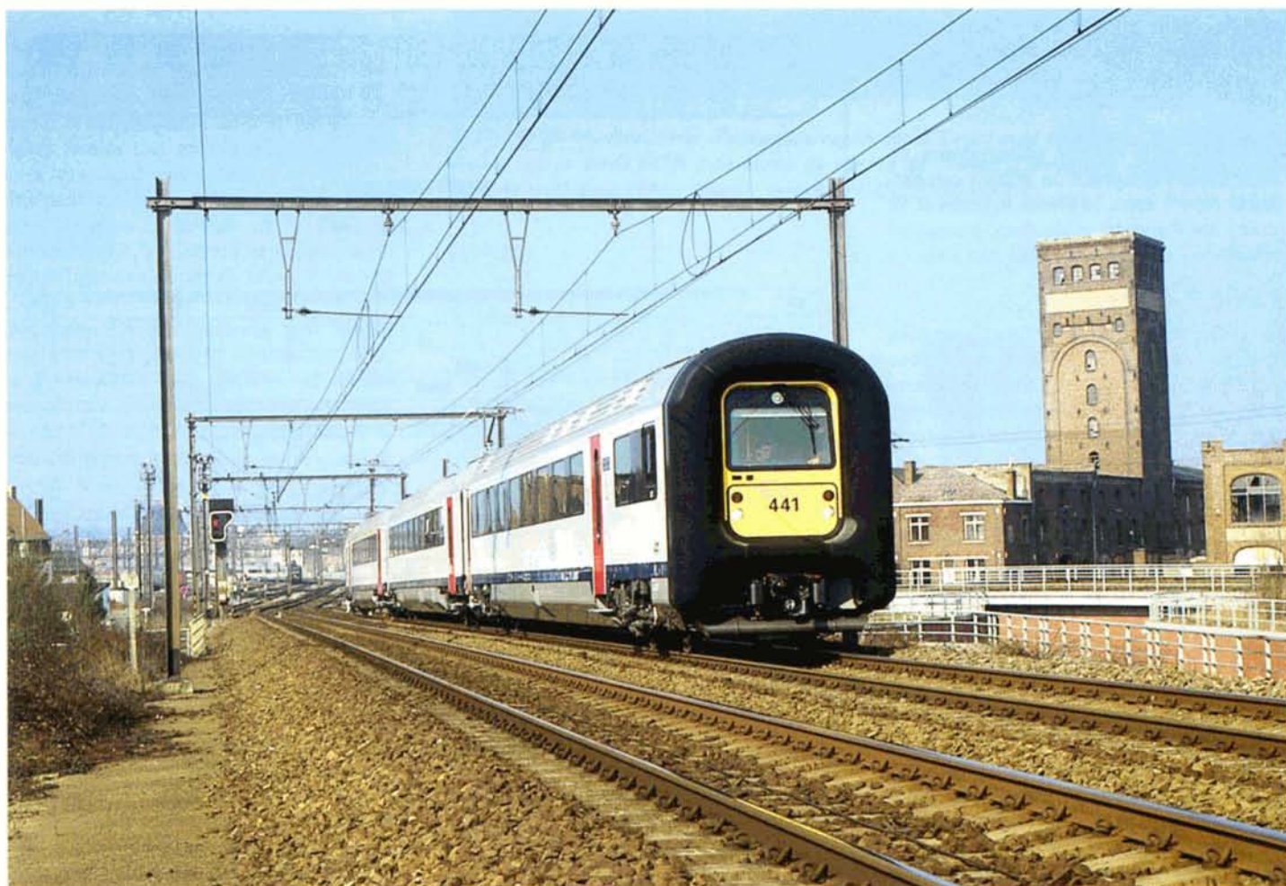
La 441, première automotrice du type 1996 de la sous-série bitension 3 kV = / 25 kV 50 Hz (numéros 441 à 490), photographiée à la sortie de Ath en direction de Silly, lors des essais de compatibilité électromagnétique, le 8 mars 1996. Photo : Christian DOSOGNE.
