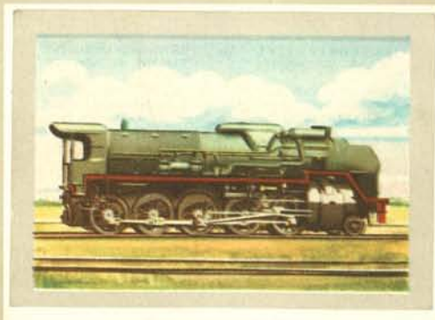
Type 150-P (marchandises) - S.N.C.F. - Equipée d'un chargeur mécanique. Type 150-P (voor goederen) - S.N.C.F. - uitgerust met mechanische lader.
