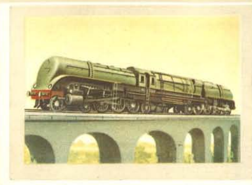
Type 231-132 « Garratt » - (Algérie) - peut circuler dans les courbes de faible rayon. Type 231-132 « Garratt » - (Algérie) - voor deze locomotief zijn scherpe bochten geen bezwaar.
