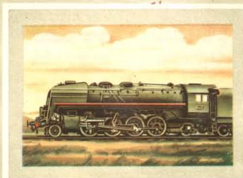
Type 141-R - S.N.C.F. - Locomotive pour trains de voyageurs et de marchandises. Type 141-R - S.N.C.F. - voor reizigers- en goederentreinen.
