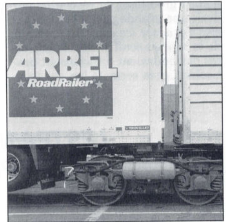
Le bogie placé, les roues remontées, les camions deviennent wagons
