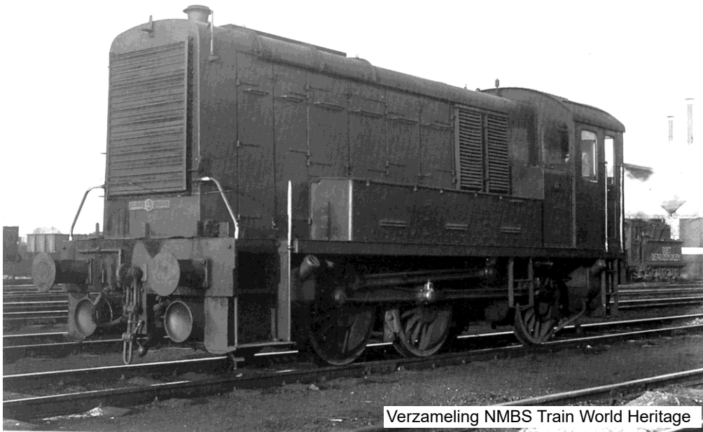
Type 230 / 231: rangeerdiesel locomotieven van het Britse War Department, asindeling C. Gestationeerd in FNSD van 1945 tot 1952. Hier locomotief 70213, nadien 230.01 en 230.001, gefotografeerd tussen mei 1946 en medio 1948 voor de loods van het depot van Antwerpen-Zuid. Foto: NMBS Train World Heritage.
