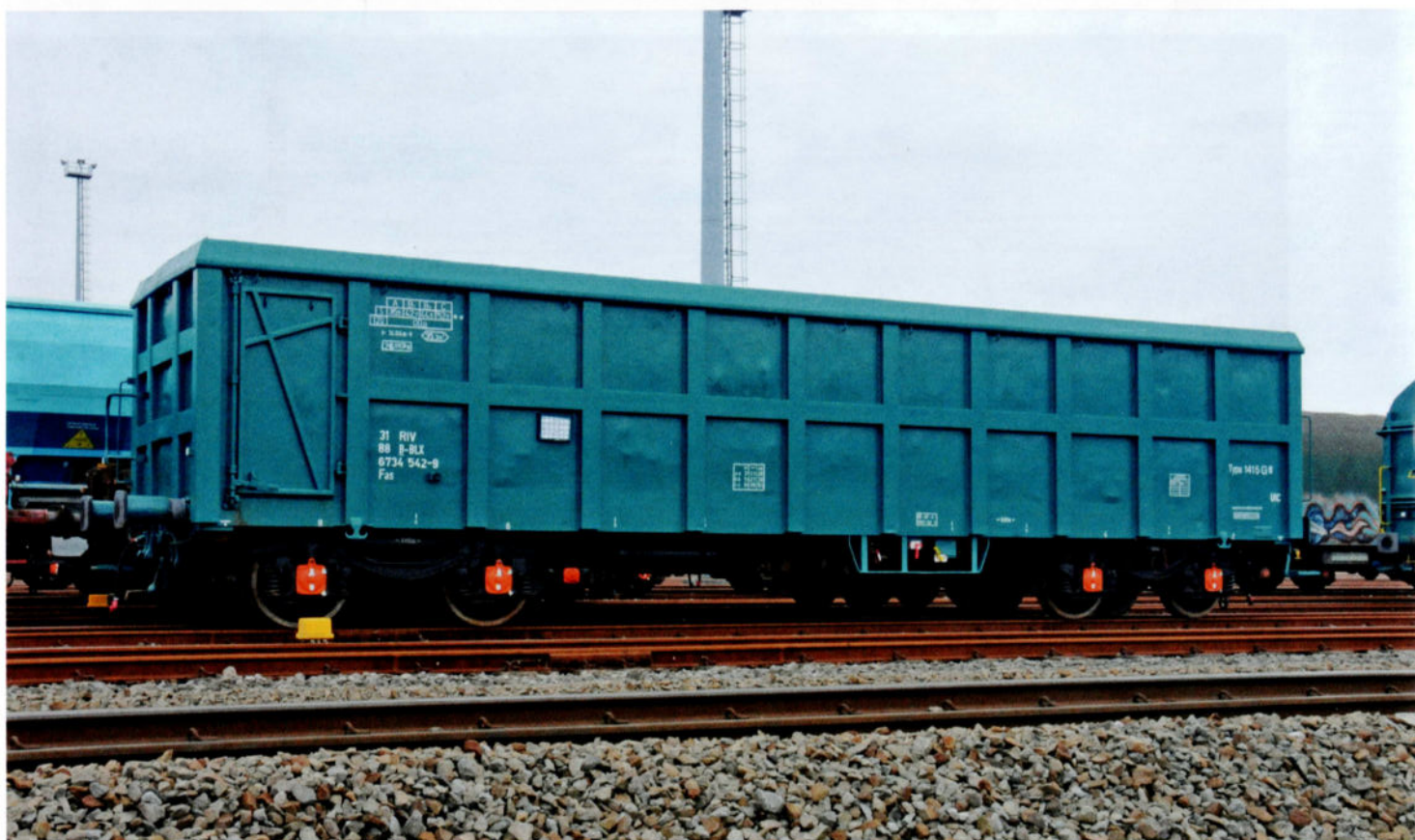
Een pas gereviseerde bulkwagen type 1415G8 met wagennummer 31 88 B-BLX 6734 542-9. Er werden hierbij nieuwe hittebestendige wielstellen aangebracht. Antwerpen haven, 21/03/2016.
