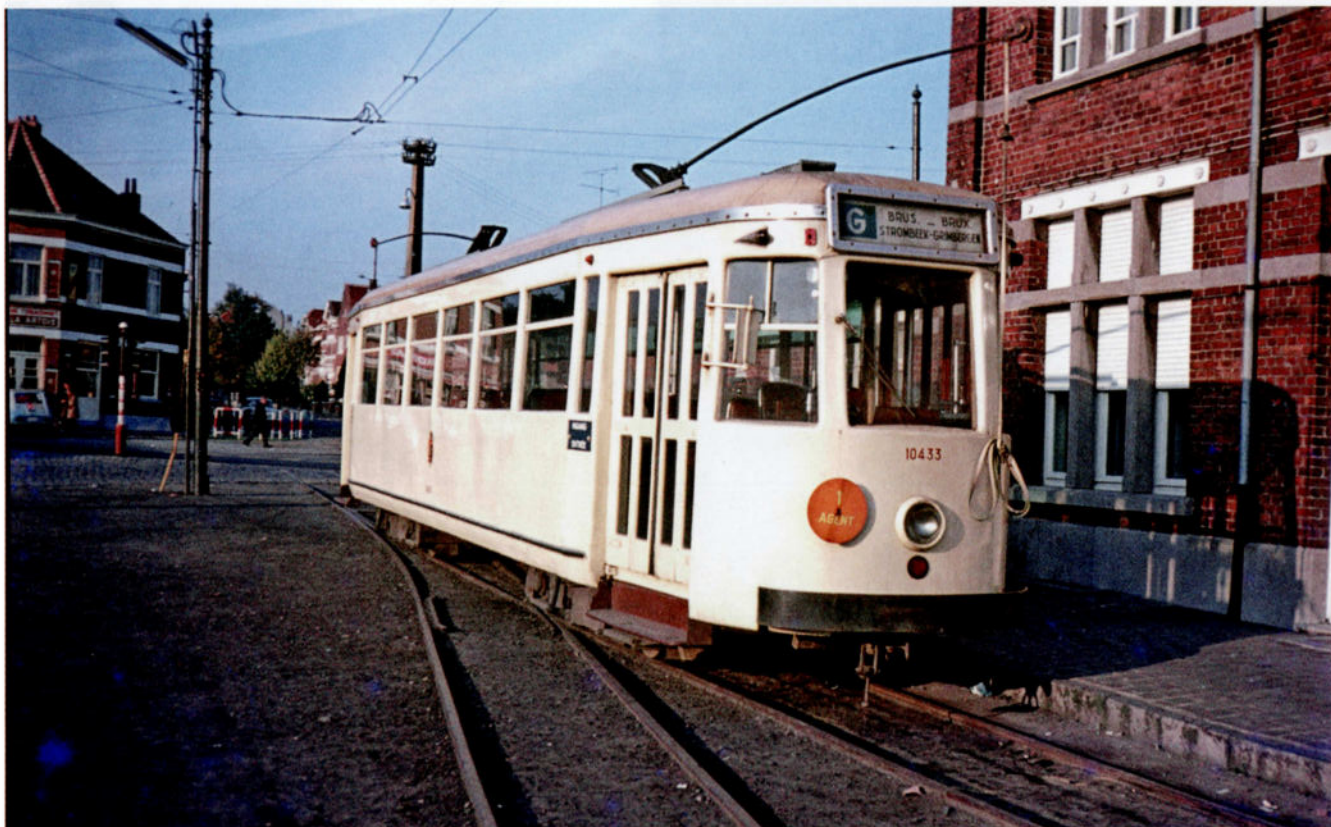
In januari 1973 werden de resterende N-motorrijtuigen, waaronder de afgebeelde 10433, uitgerust met nieuwe lijnfilms op 'autobusformaat', waarop de lijnaanduidingen iets te klein waren voor de filmkasten. Hierdoor was er boven en onder de lijnfilm een smalle witte strook te zien. Inmiddels was op de lijnen G en G doorstreept (ex S) eveneens het 'vooraan opstappen' ingevoerd, ook al was er vaak een ontvanger aan boord. Sindsdien droegen de betrokken trams een ronde schijf met de tweetalige tekst '1 AGENT' en een groen opzetbordje 'INGANG ENTRÉE' naast de ingangsdeur. Tramstation van Grimbergen, omstreeks 1975. Foto: Michel Van Ussel
