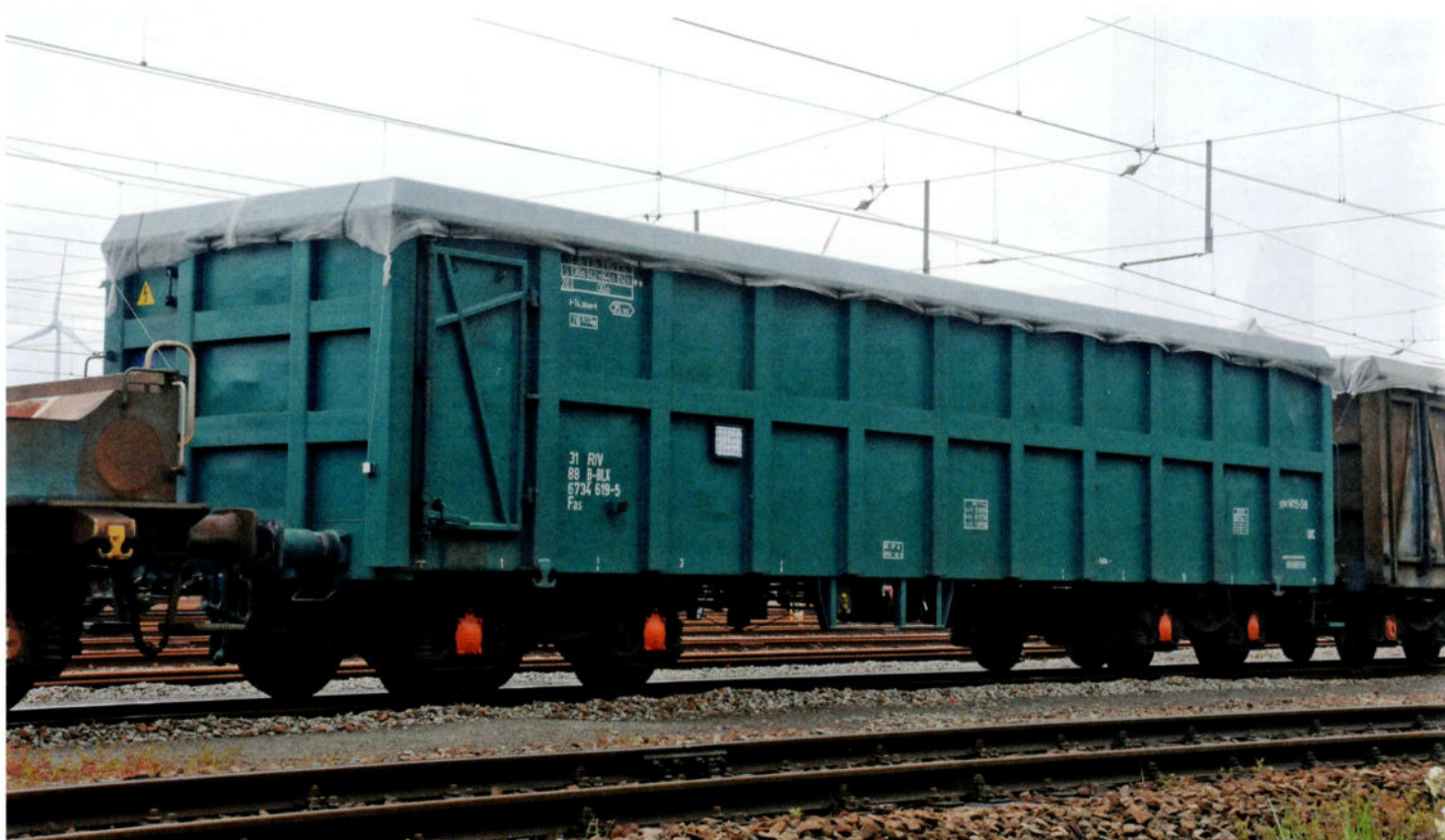
De 31 RIV 88 B-BLX 6734 619-5 heeft net zijn groot onderhoud gekregen bij 887 (ZOS TRNAVA). Er werd een dekzeil geplaatst omdat de wagens vrij vol waren geladen. Ekeren, 03/05/2017.
