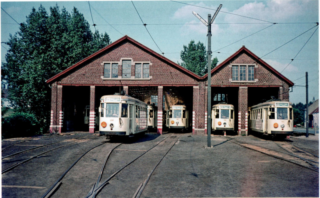
De stelplaats van Wemmel, omstreeks 1976. Van links naar rechts zien we de inmiddels vernummerde N-motorrijtuigen 9284 (ex 10481), 9285 (ex 10482), 9277 (ex 10474) en 9282 (ex 10479). De afgebeelde motorrijtuigen werden in 1964 verbouwd tot éénmanswagens en twee exemplaren zijn inmiddels uitgerust met nieuwe koplampen. De films van lijn BW, ingevoerd in januari 1973, waren identiek aan die van de toenmalige autobuslijn BW, ook al volgde deze laatste gedeeltelijk een ander traject dan de trams. Uiterst links in de loods herkennen we een Type S (met remslangen). Foto Michel Van Ussel
