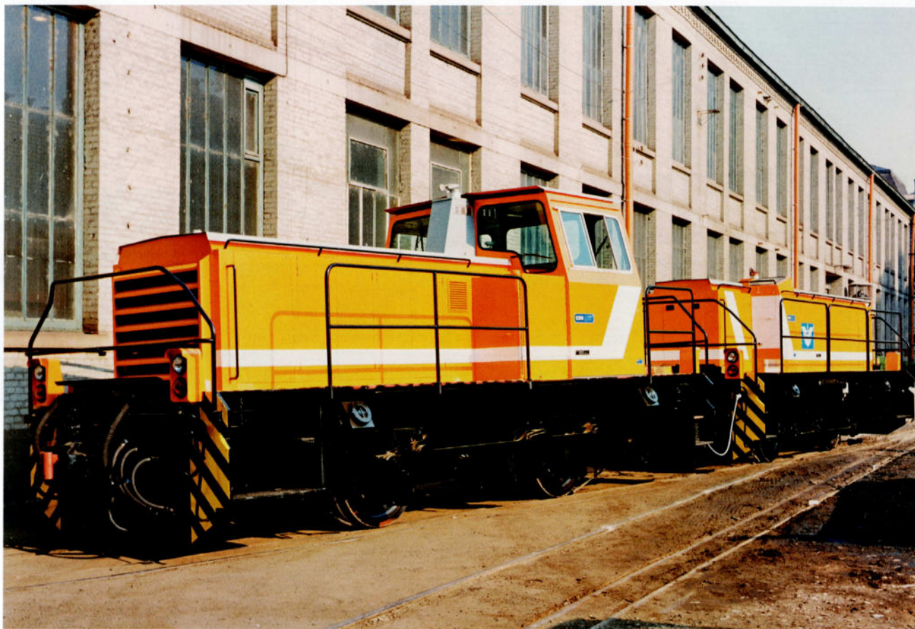
In 1982 werd de afdeling 'Construction Mécanique' van Cockerill een filiaal van het staalbedrijf Cockerill Sambre en kreeg toen de naam 'Cockerill Mechanical Industries' (CMI). We zien hier één van de zes normaalsporige tractie-eenheden, samengesteld uit een locotractor en een 'kalf' (locotractor zonder stuurpost), die in 1985 door CMI gebouwd werden voor de spoorwegmaatschappij OCTRA, de uitbater van de 'Trans-Gabon'-spoorlijn. Foto: CMI - Verzameling: GTF.
