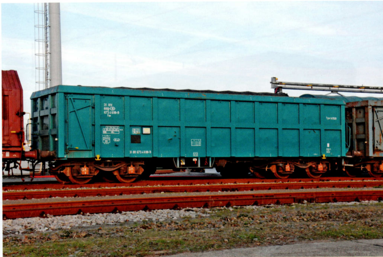
Deze 1415G8 met rembordes, heeft een klein onderhoud gehad te FUG op 08-05-2014 wagennummer 31 RIV 88 B-(NMBS) 673 4 698-9. De aspotdeksels hebben de oranje kleur van XPEDYS. Het B-Cargo logo werd verwijderd maar het oude wagennummer bleef behouden. Nog geen BLX vermeld in het wagennummer. CHW Antwerpen, 18/01/2016.
