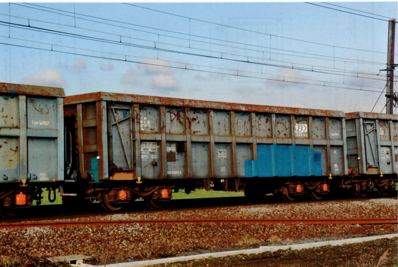
Deze 1415G8 vertoont op diverse plaatsen herstellvlakken. Wagennummer 31 RIV 88 B-(NMBS) 673 4 622-9 is zwaar geladen, te zien omdat de T-stukken op de aspotten hoog geplaatst zijn. Heeft niet-hittebestendige wielassen en oranje Xpedys wielaspotten. Ekeren, 24/01/2014.
