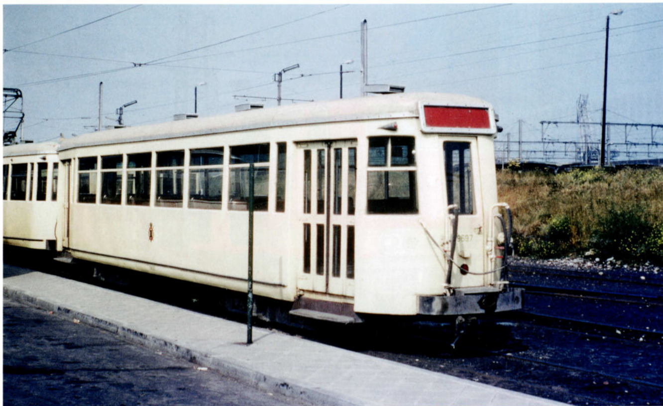
La remorque N 19697 de la ligne de la Côte est garée sur le faisceau du Brandariskaai à Ostende, le 3 septembre 1972. Les boîtes à film n'étaient pas utilisées et avaient été repeintes en rouge. Observez la porte d'about avec deux boyaux de frein de part et d'autre ; ces portes étaient utilisées uniquement par les receveurs pour passer d'une voiture à l'autre. La ligne du tram vers Knokke était située sur le talus visible à droite de la remorque. Les larges portiques caténaïres visibles à l'arrière-plan sont ceux de la SNCB, en gare d'Ostende. Photo : Dirk Eveleens Maarse.
