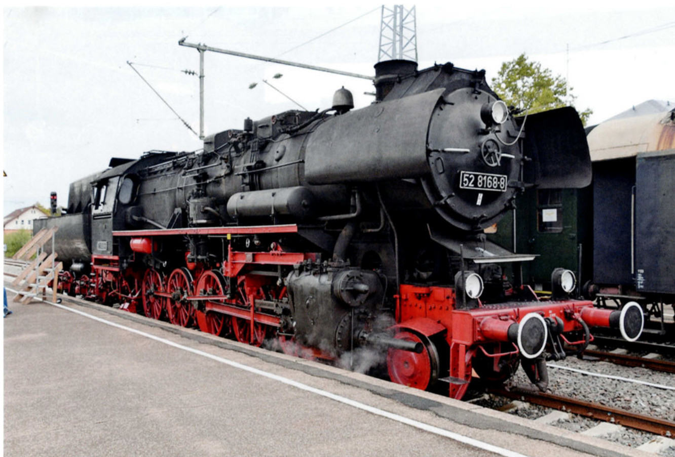
La 52.8168 vient de l'ancienne RDA: au cours des années '60 du siècle dernier, la DR (Deutsche Reichsbahn) fit équiper 200 locomotives de la série 52 d'une nouvelle chaudière, les locos concernées étant renumérotées dans la série 52.80. Göppingen, le 16 septembre 2017. Photo: Rik Vermeylen.
