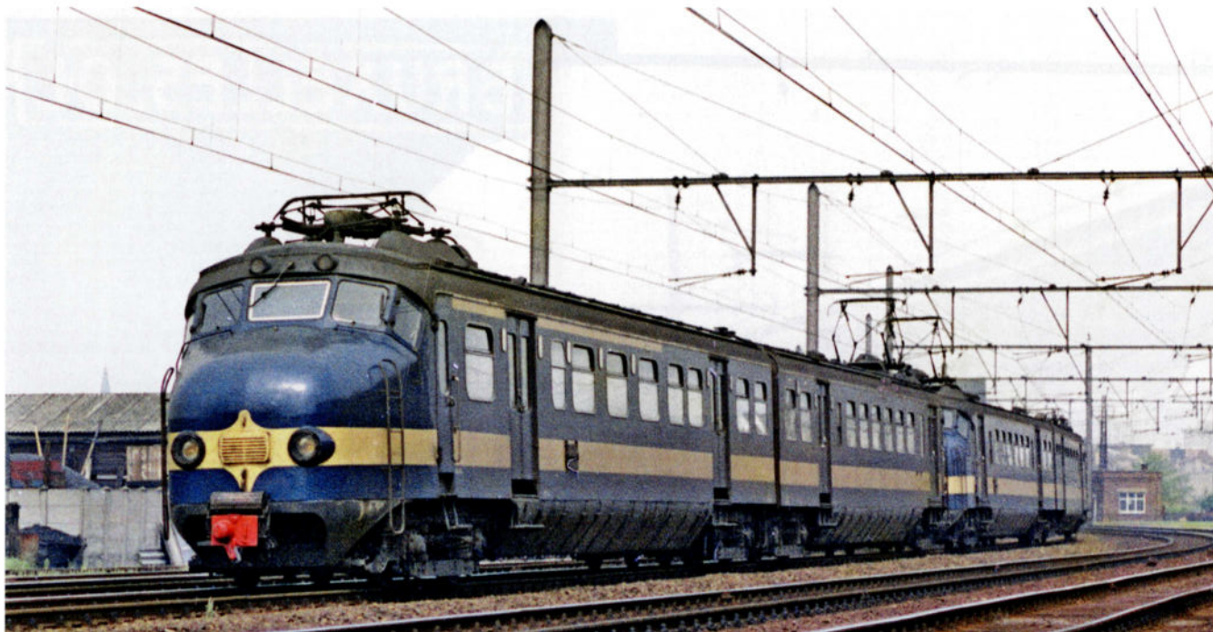
A l'origine, les automotrices 'têtes de chien' n'étaient pas pourvues d'un troisième phare frontal ; ce dernier leur fut ajouté ultérieurement. Anvers-Stuyvenberg ; avril 1958.
