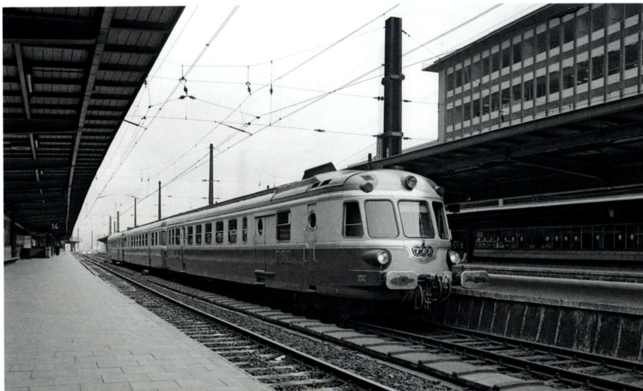
La X 2775 et une autre motrice RGP TEE encadrent une remorque en gare de Bruxelles-Midi, à une date inconnue, mais postérieure à 1961/'62, moment où les motrices des RGP TEE ont été pourvues d'un 3 ème phare. Cette composition triple fut celle du TEE 128 'Brabant' Bruxelles-Midi - Paris-Nord du 26 mai au 31 août 1963 inclus. Photo : SNCB - Train World Heritage.
