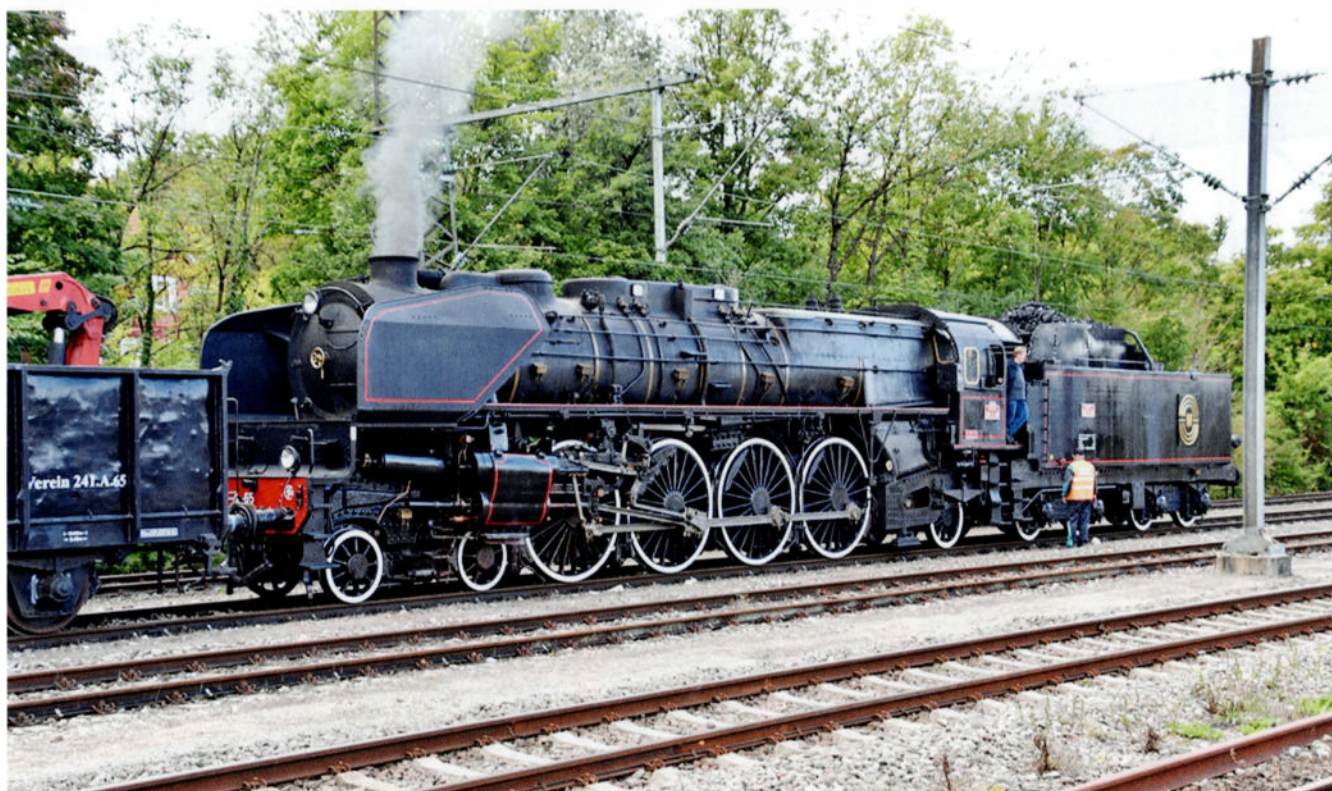
La 241 A 65 française fut construite en 1931 par Fives-Lille et fait partie d'une série de 90 locomotives semblables. Elle fut en service à la SNCF jusqu'au 23 juillet 1965 et sauvée de la ferraille par un Suisse. Après révision, cette loco sortit le 22 septembre 1997 des ateliers de Meiningen et devint la propriété de l'association 241 A 65 le 1 er avril 2003, qui l'utilise pour remorquer des trains spéciaux. Göppingen, le 16 septembre 2017. Photo: Rik Vermeylen.
