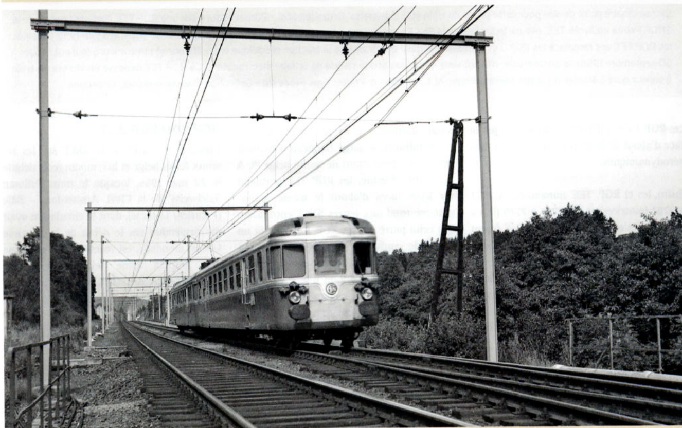
Lors de la prise de cette photo, les RGP TEE (reconnaissables à leur robe plus foncée que celle des RGP 1) ont déjà repris à leur compte le train 'Edelweiss': témoin cette RGP TEE (remorque en tête), reconnaissable au fait que la vitre de gauche de la face d'about de sa remorque était opaque, car c'était la vitre du compartiment WC; dans les remorques des RGP 1 vertes, le WC était en effet situé à un autre endroit. Cette RGP passe à Grupont (ligne 162 entre Jemelle et Libramont) en assurant le train M31 Bruxelles – Zurich (photo prise après le 2.06.1956). Photo : SNCB – Train World Heritage.
