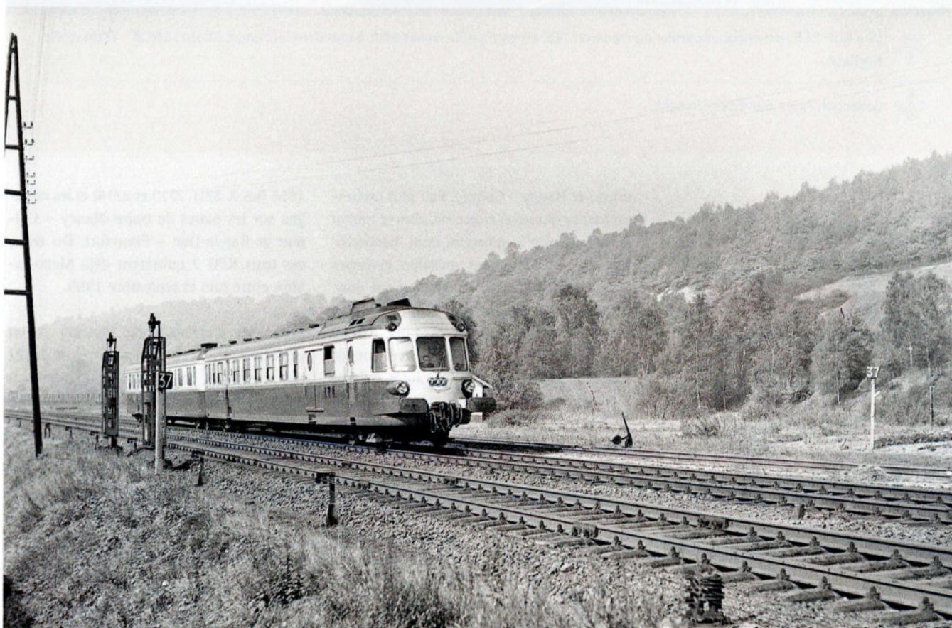
Un TEE de la relation France - Allemagne (le M155 'Parsifal' ou le M185 'Paris-Ruhr') assuré par une RGP TEE longe la Meuse à Java (ligne 125 entre Andenne-Seilles et Huy), en route vers l'Allemagne. La motrice n'est pas encore équipée d'un troisième phare frontal, mais bien du capteur magnétique propre au système 'Indusi', que l'on peut voir à hauteur du 1 er essieu. La photo a été prise avant 1961/'62, lorsque les RGP TEE furent équipées d'un 3 ème phare. Photo : SNCB - Train World Heritage.
