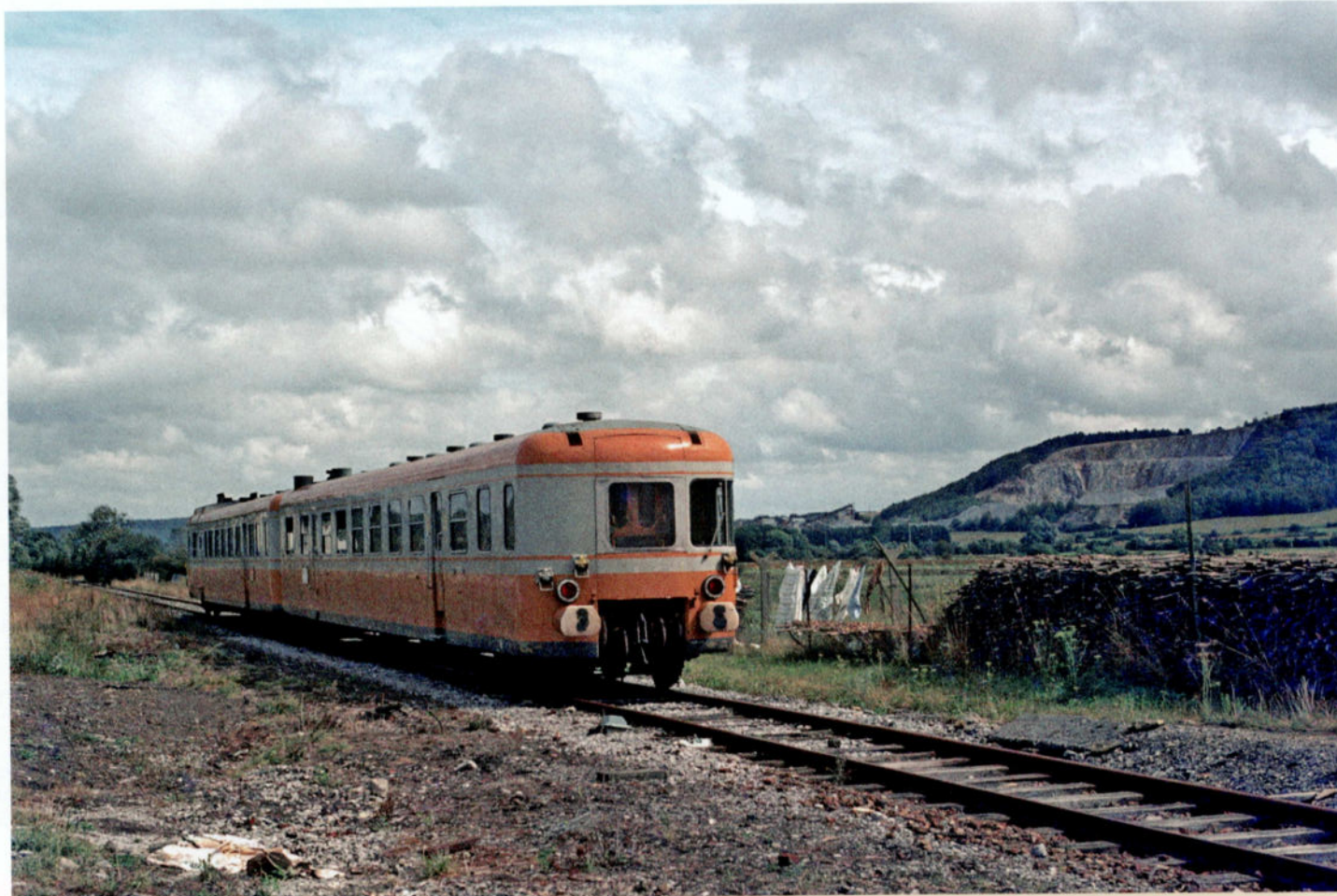
Lors de sa rénovation, la RGP X 2773 (ex-TEE) avait été adaptée pour assurer des trains spéciaux: sa remorque XR 7773 avait été rendue 'borgne', par obturation de la fenêtre de son compartiment WC. Frasnes (L.156 entre Chimay et Mariembourg), le 10 septembre 1983. Photo : Michel Van Ussel.
