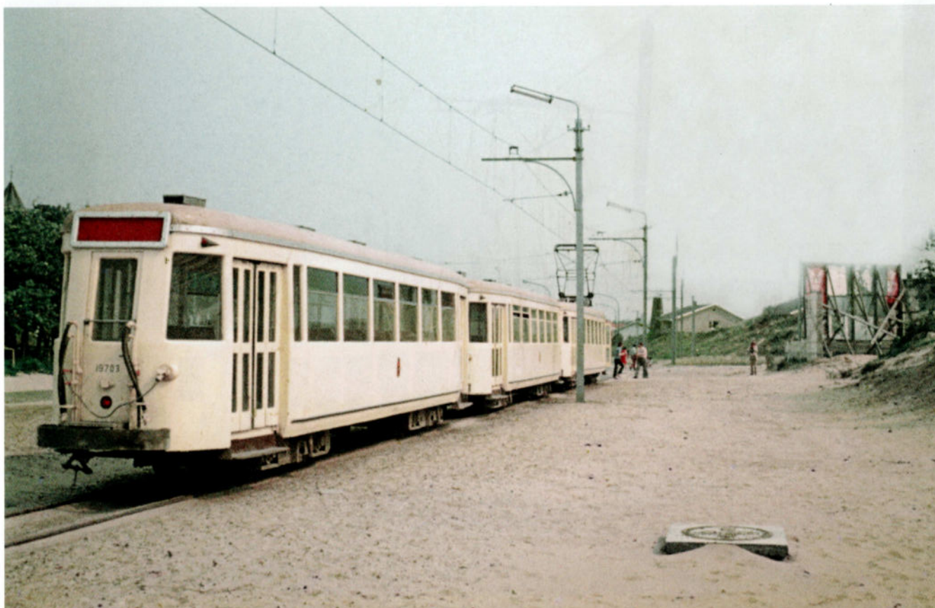
Des rames composées d'une motrice SO et de deux remorques N étaient très élégantes, mais aussi très rares sur la ligne de la Côte : pendant la saison estivale, la SNCV préférait placer une remorque Standard en 3 ème position, car elle offrait plus de places assises et les baies d'ouverture des portes étaient plus facilement accessibles aux voyageurs chargés de bagages ou aux poussettes d'enfants. La remorque N de queue visible sur ce cliché est la 19703. Terminus de La Panne-Esplanade, vers 1970. Photographe inconnu - Collection Dirk Eveleens Maarse.
