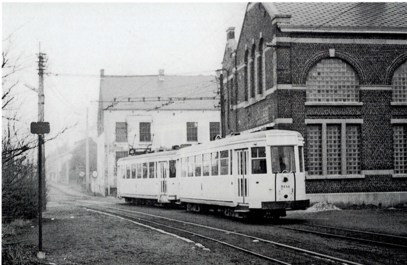
La remorque N 9444 (ex 19718) tractée par une motrice du type SM (avec marchepieds rabattables pour les quais 'métro') assure en février 1978 un service sur la ligne 90 de Charleroi vers La Louvière et passe ici à hauteur de la sous-station de Trivières. Contrairement aux remorques type N de la Côte, les remorques N du Hainaut n'étaient pas pourvues de portes d'about, raison pour laquelle elles n'avaient que deux boyaux de frein (au lieu de quatre) à chaque bout, tandis que les coupleurs électriques (pour l'éclairage, le chauffage, les portes pliantes électropneumatiques et la sonnette de demande d'arrêt) pouvaient être placés au milieu, entre lesdits boyaux. Autre différence : les boîtes à film non utilisées de ces remorques étaient peintes en crème. Photo : Dussart-Desart - Collection : www.tramania.com (photo 09070).
