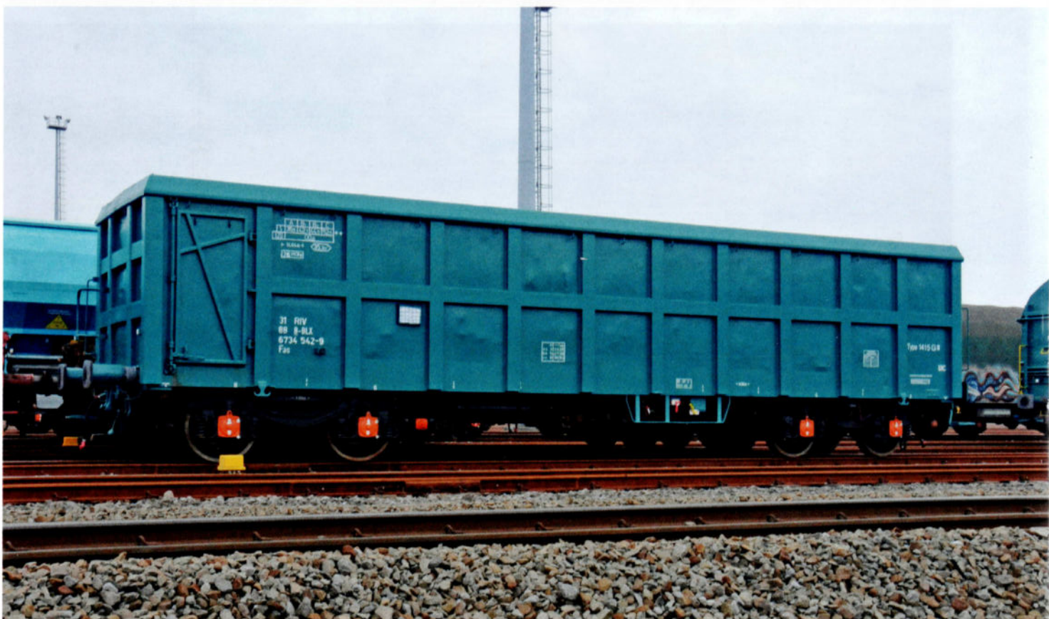
Un wagon pour transport de vrac du type 1415 G8 récemment révisé: il est immatriculé 31 88 B-BLX 6734 542-9. Des nouveaux essieux résistants à l'échauffement lui ont été montés. Port d'Anvers, le 21 mars 2016.
