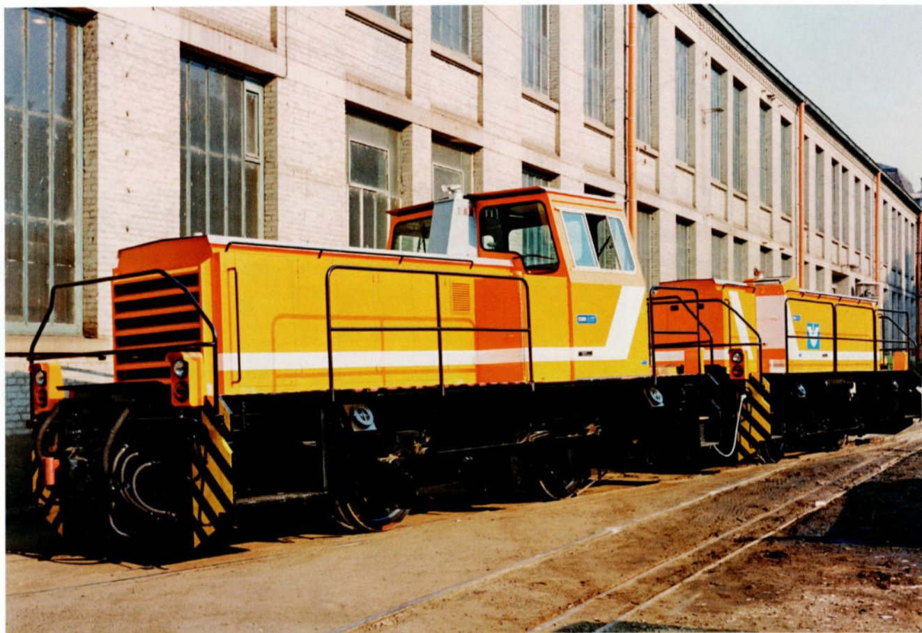
En 1982, La Division 'Construction Mécanique' de Cockerill devient une société filiale du sidérurgiste Cockerill-Sambre et prend le nom de Cockerill Mechanical Industries (CMI). Voici une des six unités de traction (composées d'un locotracteur et d'un 'veau', un élément motorisé sans cabine de conduite) pour voie normale, construites par CMI en 1985 pour l'Octra (le 'Transgabonais', les chemins de fer du Gabon). Photo: CMI - Collection: GTF.
