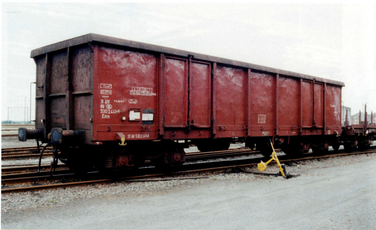
Encore un véritable wagon 1415 A3, immatriculé 31 RIV 88 (SNCB) 530 2 441-8, garé devant l'atelier des wagons d'Anvers-Nord. Le code d'interopérabilité 31 signifie que ce wagon est pourvu de bogies et qu'il est apte au trafic international. CHW d'Anvers-Nord, le 19 mai 1997.
