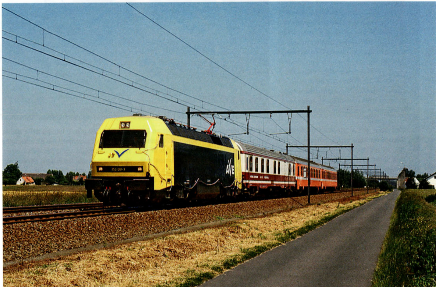
Vu depuis la ruelle dénommée 'Langs de spoorweg' ('Le long du chemin de fer') à Sint-Martens-Latem, voici le 3 ème passage en vitesse vers Courtrai, réalisé le 17 juin 1992. La voiture de mesures est classée juste derrière la loco, afin de recueillir les données des mesures. Photo : Carlo Hertogs.
