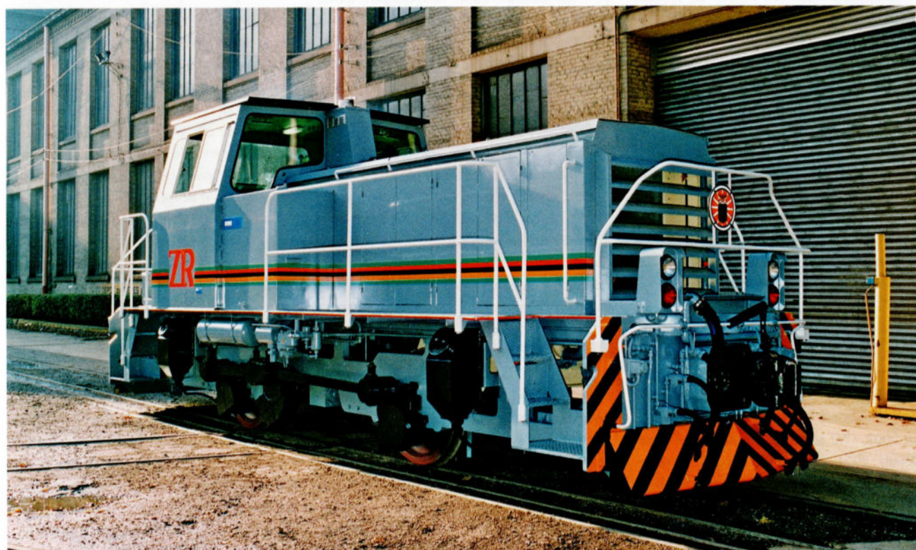
Un locotracteur à voie de 1,067 m d'écartement destiné aux ZR (Zambia Railways), vu à sa sortie de l'usine CMI de Seraing, au cours des années '80. Ces engins étaient encore utilisés il y a quelques années dans la région de Lusaka, où ils assuraient indifféremment des trains locaux de marchandises ou de voyageurs, pour autant que des voitures soient disponibles... Photo: CMI - Collection: GTF.
