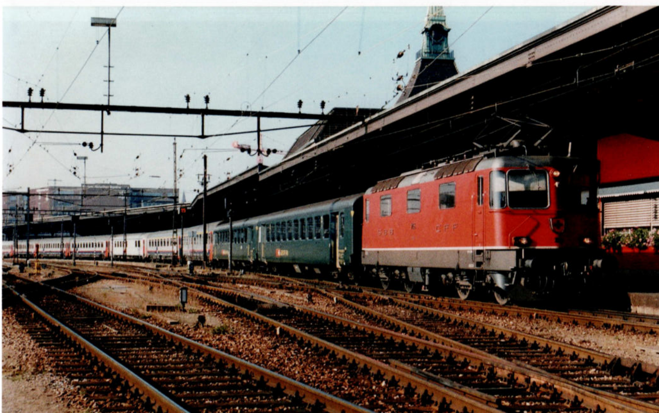
Le train 91 'Vauban' Bruxelles-Milan est arrivé à Bâle SNCF, sur la voie numéro 30. La BB 15000 de la SNCF ayant remorqué le train depuis Luxembourg a été retirée du train par une locomotive de manœuvre des CFF. La partie commutable de la caténaire de la voie 30 a été alimentée en 15 kV ~ pour permettre à la locomotive Re 4/4 II des CFF (accompagnée de 2 voitures unifiées I de 2 ème classe renforçant la rame entre Bâle et Brigue) d'aller chercher la rame du 'Vauban' en provenance de Bruxelles. La loco des CFF va tirer la rame jusque dans la partie CFF de la gare, pour permettre aux voyageurs bâlois prenant le train 91 à Bâle d'y embarquer. Bâle SNCF, en 1995. Photo : Emiel Van den Bossche.
