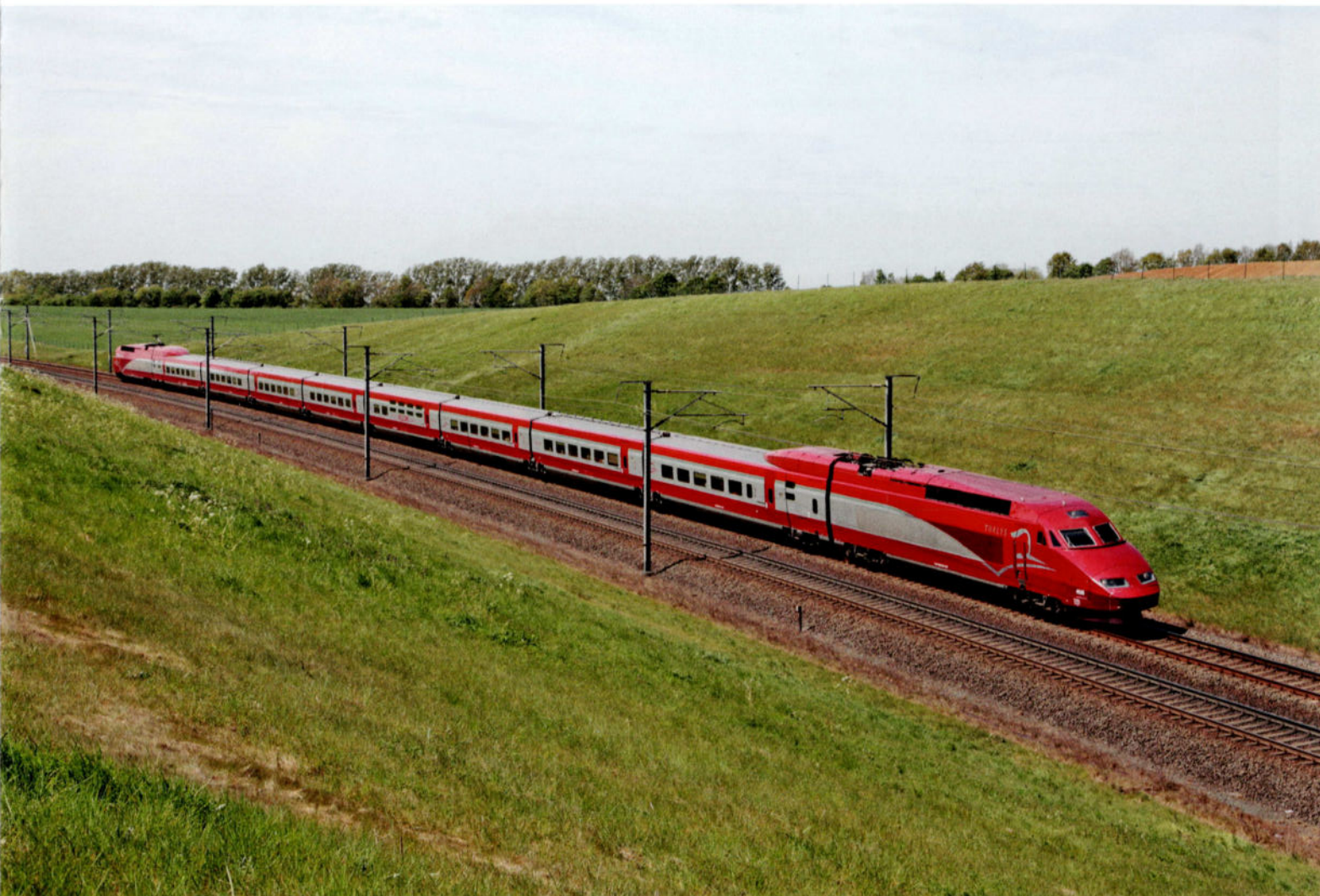
A la BK 18 de la LGV 1, la rame Thalys 4535 a déjà perdu une grande partie de sa vitesse, car elle doit passer de 300 à 160 km/h à hauteur de Lembeek. La vitesse maximale autorisée sur la ligne 1 est en effet de 300 km/h. Cette vue datant du 30 avril 2016 nous montre la nouvelle livrée que Thalys fait appliquer progressivement sur ses rames renouvelées, depuis le début de cette année. Photo: Carlo Hertogs.
