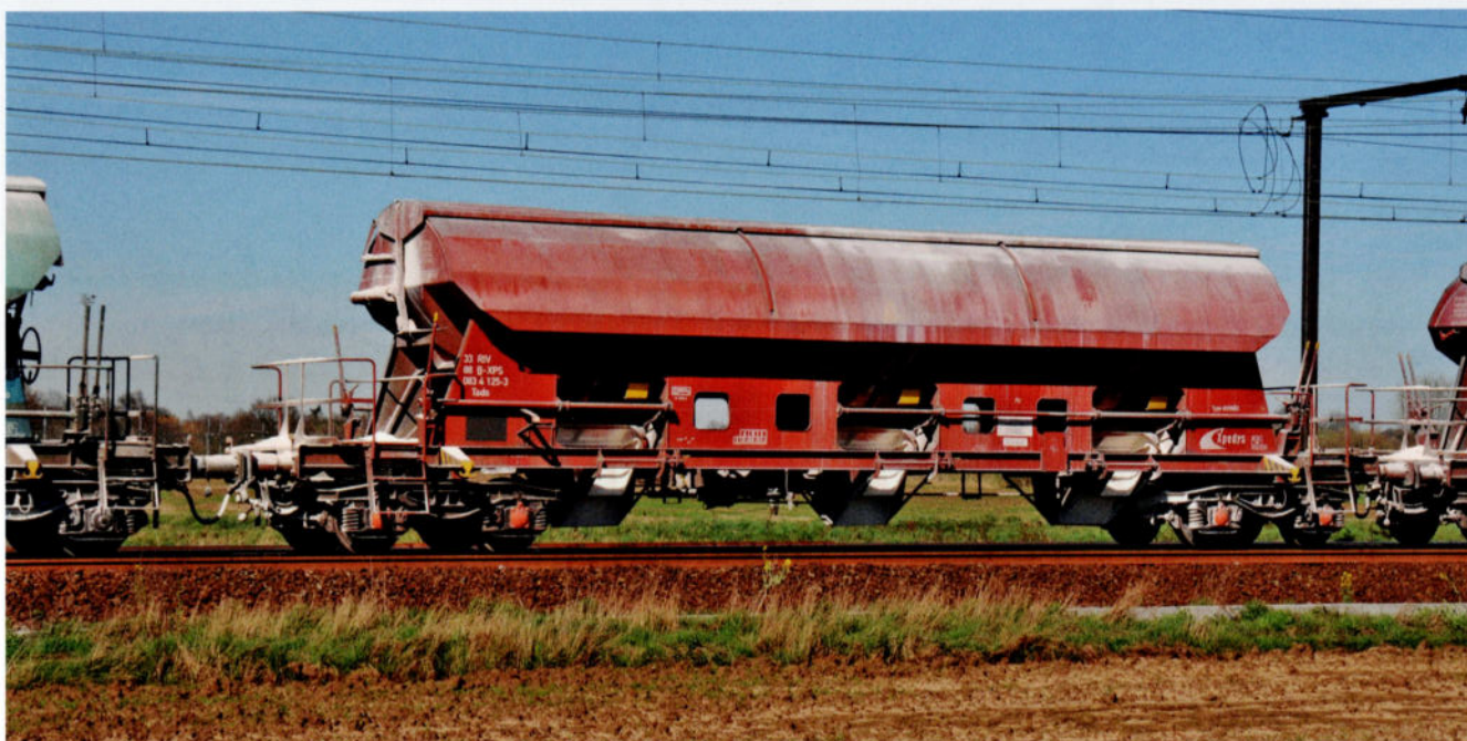
Un wagon équipé de nouveaux essieux et de boîtes d'essieu Xpedys de teinte orange. Ekeren, le 20 mars 2014.
