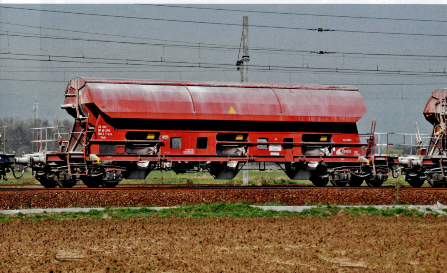
Un wagon qui porte de nettes traces d'utilisation; il est pourvu de roues résistantes à l'échauffement. Ekeren, le 14 mars 2014.
