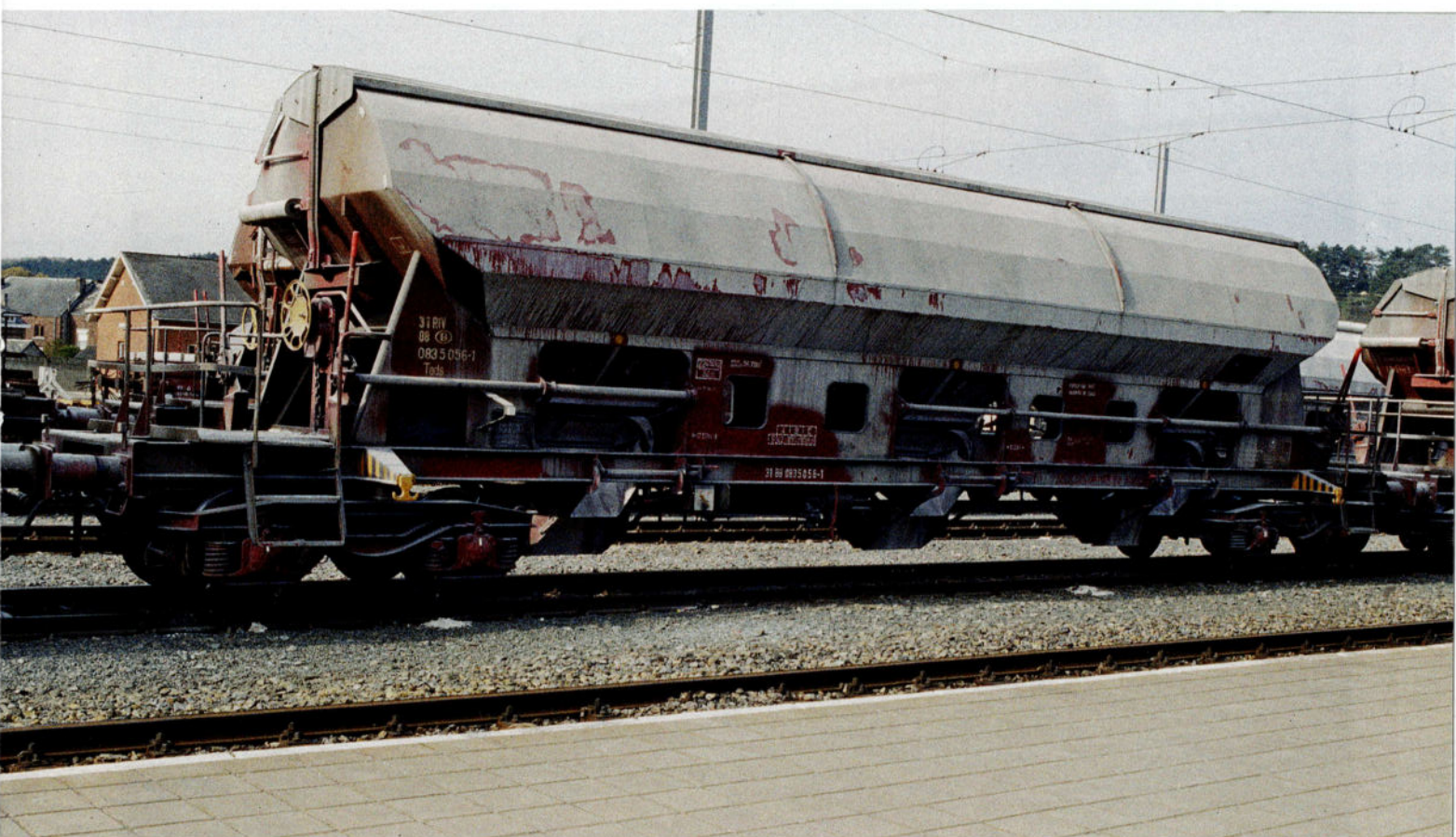
Ce wagon portant l'ancienne numérotation est équipé d'un frein à main et de roues encore bandagées. Jemelle, le 14 octobre 1996.
