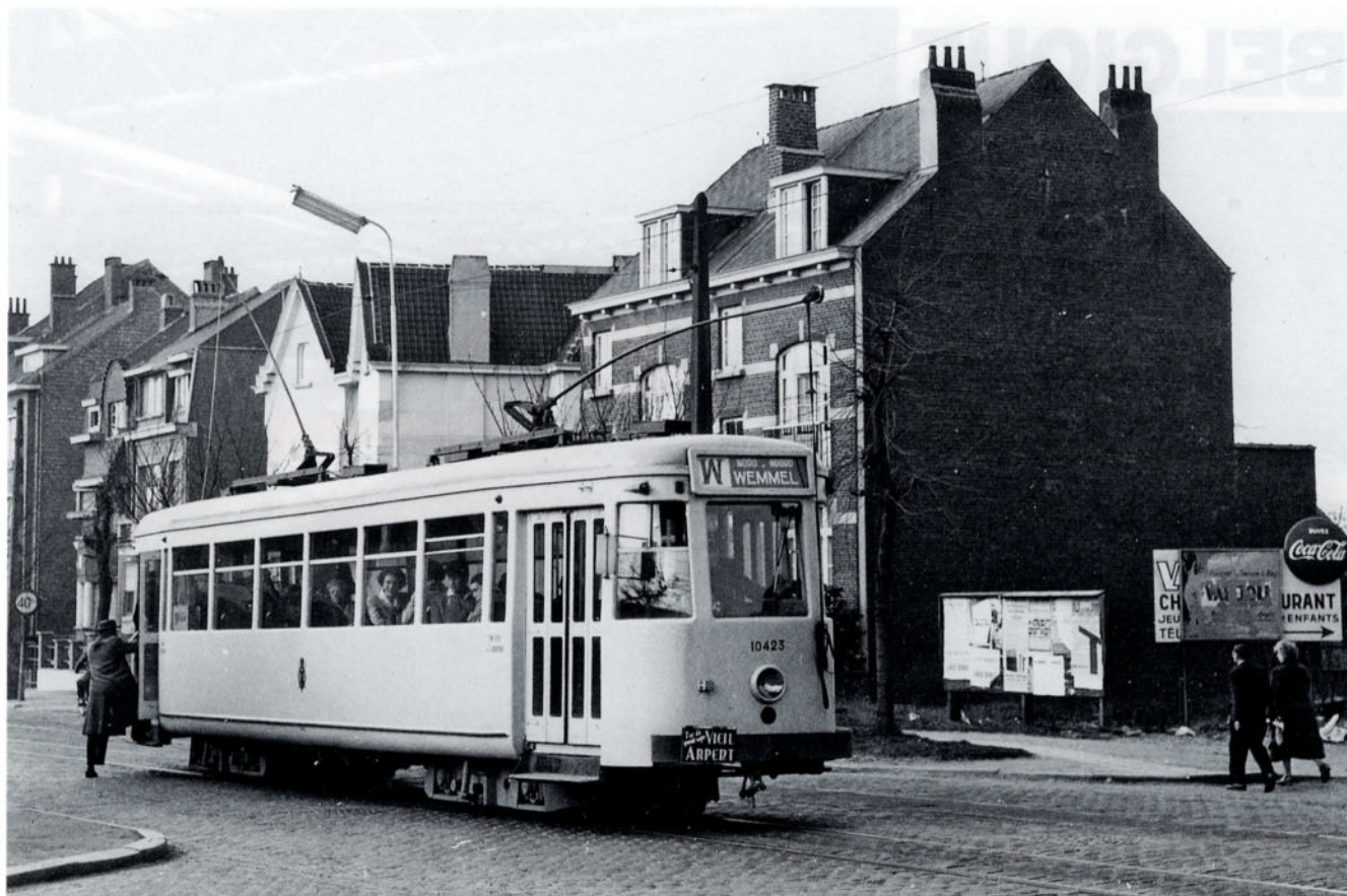
La 10423 sur la ligne W est vue le long de la Limburg Stirumlaan en direction de la gare du Nord et dessert l'arrêt à hauteur de la Jan De Ridderlaan (visible à gauche) à Wemmel, le 30 mars 1958. Les bogies 'élastiques' sont déjà pourvus d'amortisseurs hydrauliques. Suite au placement de ces nouveaux bogies, la caisse s'était retrouvée à une hauteur nettement plus importante qu'auparavant, par rapport au sol : les montées à bord de ces véhicules nécessitaient dorénavant du muscle et... de solides coutures au pantalon ! A noter que la 10423 sera transformée en remorque pour la ligne de la Côte, en 1968. Photo : Jan Voerman - Collection NVBS.
