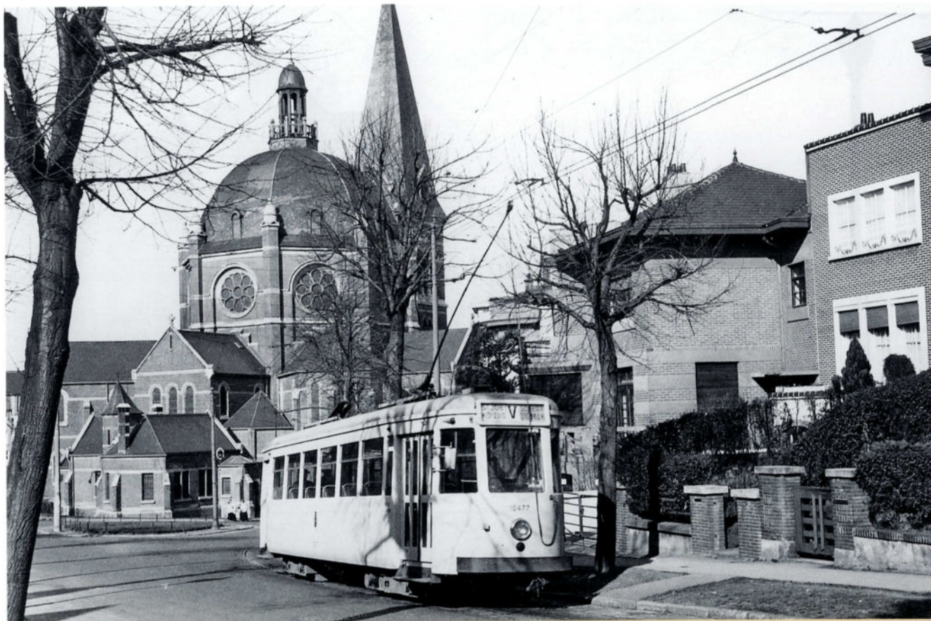
Le 30 mars 1958, la 10477 était déjà pourvue de nouveaux bogies 'élastiques', mais les amortisseurs hydrauliques manquent encore, ainsi que les baguettes de protection latérales. Venant de Dilbeek, cette motrice circule sur la ligne V. Elle parcourt l'avenue Victor Emmanuel III à Uccle et va bientôt arriver à son terminus de Saint-Job. La 10477 est restée en service jusqu'à la suppression des dernières lignes vicinales bruxelloises en 1978 et fut ferraillée en 1982. La majestueuse église de Saint-Job visible à l'arrière-plan fut construite en 1911/'13, la cathédrale d'Aix-la-Chapelle ayant servi de source d'inspiration. Photo: Jan Voerman - Collection NVBS.
