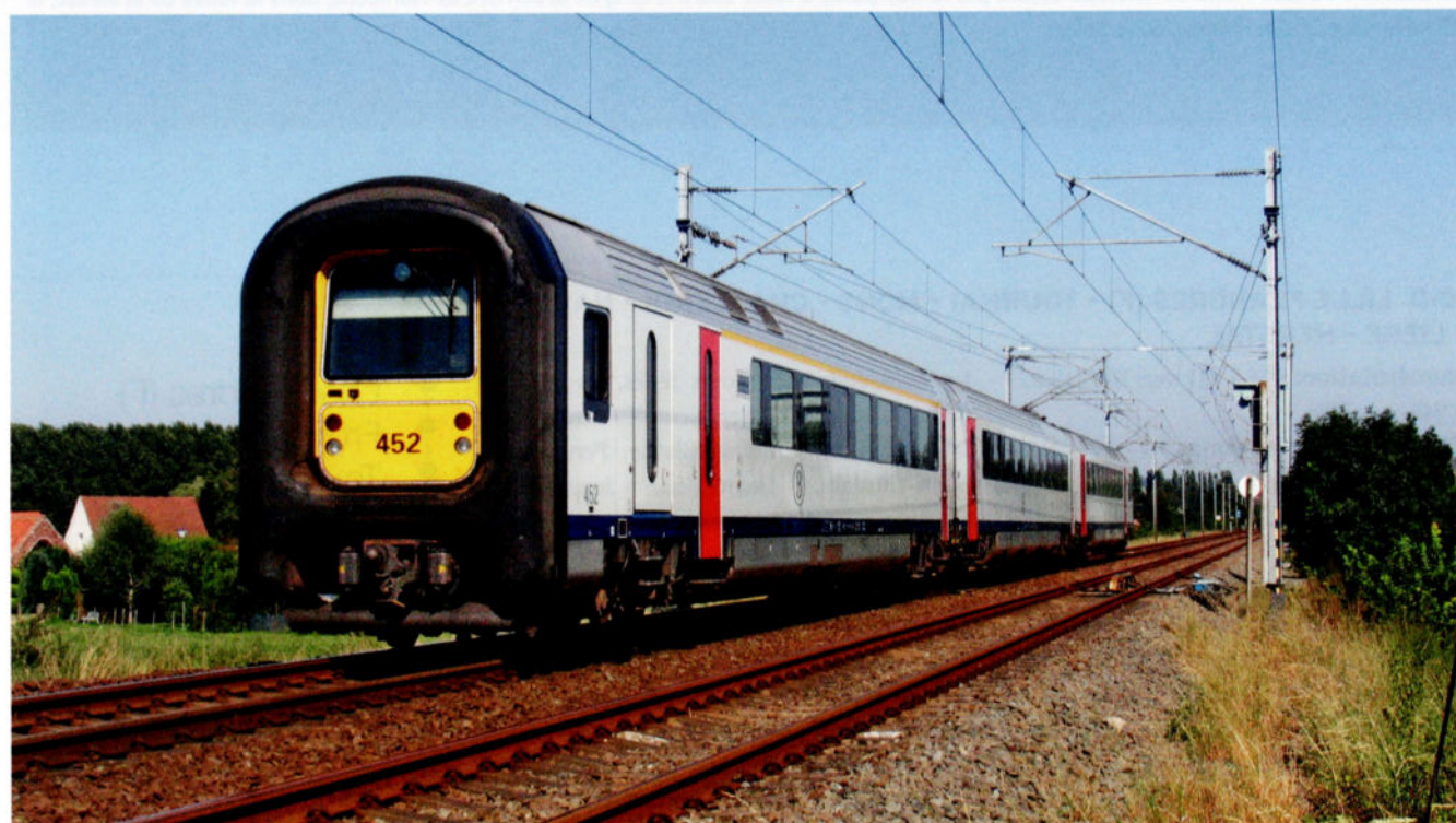
Ne cherchez pas: il n'y a pas de pantographe levé sur cette automotrice, car elle s'apprête à passer le sas de commutation 25 kV alternatif/ 3000 V continu à l'entrée de Froyennes. Sans traction et sur sa lancée, la 452 assure le train IC 918 Lille-Flandres - Mons - Namur - Herstal - Hasselt, le 15 août 2006. Notons que bien que ce train soit déjà en Belgique depuis quelques kilomètres, le 25 kV est fourni par la SNCF. Photo: Cédric Soltys.
