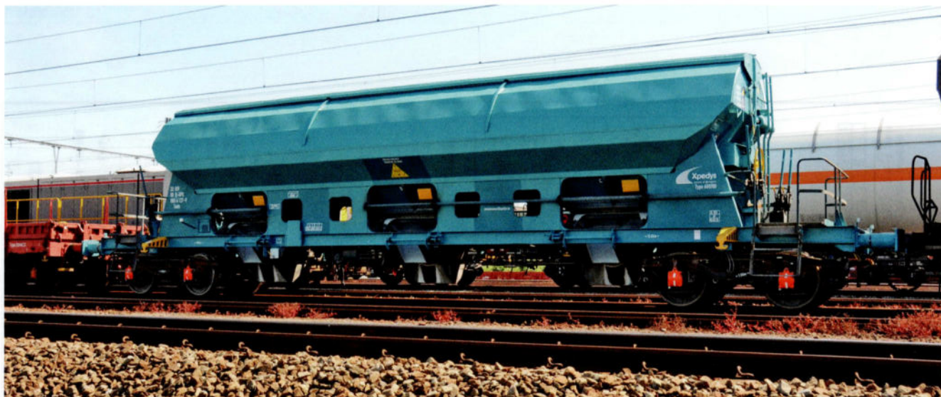
Des mentions spéciales sur un wagon fraîchement révisé : la capacité de chargement et la mention 'Transport de chaux'. Le petit entretien (valable 3 ans) a été effectué par l'atelier CFL de Pétange (L) le 2 juin 2016. Port d'Anvers, le 9 juin 2016.
