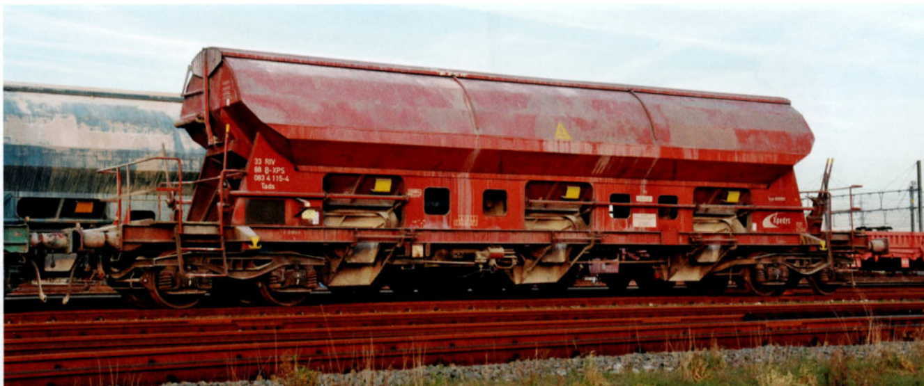
Un wagon pourvu d'anciens essieux à roues résistantes à l'échauffement. Port d'Anvers, le 18 janvier 2016.
