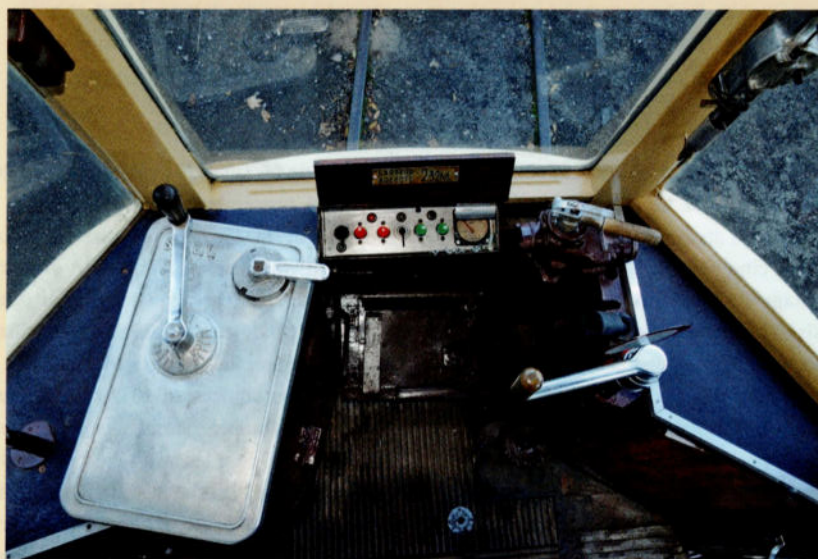
Un des deux postes de conduite de la motrice 10480, préservée par l'ASVi. On aperçoit au milieu le panneau de commande simpliste (portes, indicateurs de direction, éclairage, pression d'air... et quelques vis de réserve !). A droite, le robinet du frein Westinghouse pour la commande du frein pneumatique (ainsi que le clapet de commande des sablières) et la manivelle du frein à main. A gauche, le controller du type ML5, avec manivelle des crans et manette d'inversion. En dessous, le repose-pied (pour conduite assise) avec la pédale d'homme-mort' (installée en 1964, lors de la transformation pour circulations à agent seul), les boutons d'actionnement du gong et du klaxon Cicca. Le dispositif de perception (installé normalement à l'extrême-droite) n'a pas été conservé. A droite du controller, un levier permettant la commande manuelle des sablières. Sur les montants du pare-brise, on voit sur celui de gauche le témoin lumineux indiquant l'alimentation de la motrice (en 600 V) et sur celui de droite, le dispositif renseignant le bon fonctionnement du frein pneumatique. A gauche du controller se trouve la poignée (partiellement visible) pour le réarmement du rupteur de ligne automatique. Tout à fait en bas de la photo, on aperçoit l'orifice prévu pour une pince permettant d'actionner le gong en position debout. Entre le robinet du frein et la manivelle du frein à main, un support est prévu pour divers agrès (clef et pince d'aiguillage, bloc en bois) servant à manœuvrer les aiguillages (seule la clef est présente). Photo : Marco Moerland, le 28 octobre 2012.
