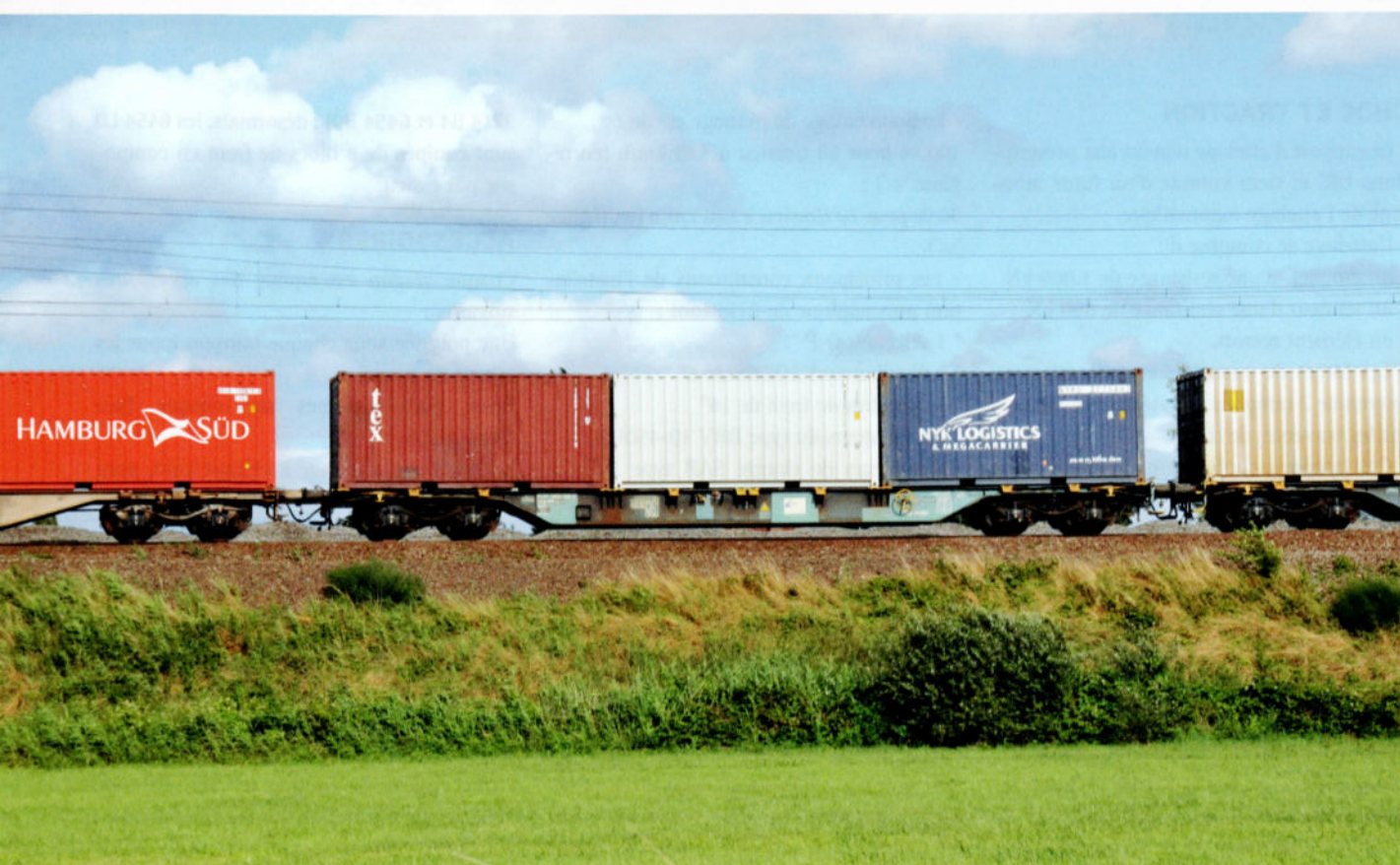
Le wagon 33 RIV 88 B-IFB 4565 780-2 portant le petit logo IFB ; il est pourvu d'un frein à main. Ce wagon porte encore son ancien code-lettres 'Sgnss' et le marquage indiquant la convention spéciale avec la SNCF pour ses lignes de catégorie D. Il est chargé de trois conteneurs de 20 pieds. Ekeren, le 31 juillet 2013.
