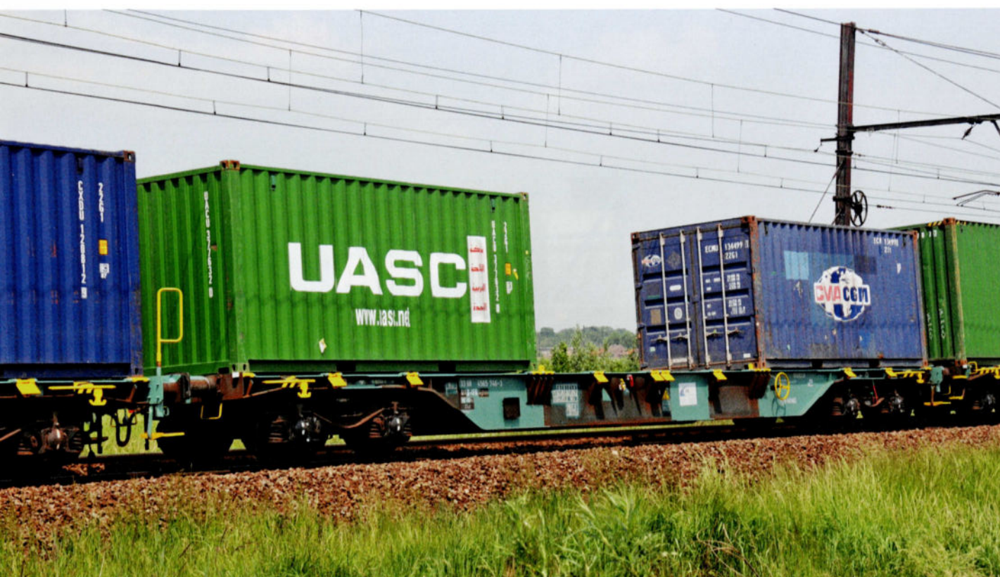
Le wagon 33 RIV 88 B-IFB 4565 746-3 porte le grand logo IFB moderne ; il est pourvu d'un frein à main. Ce wagon a bénéficié d'un grand entretien, réalisé par la firme 887 (Zos Trnava). Il est chargé à ses extrémités de deux conteneurs : un 'UASC' et un 'CMA-CGM'. Ekeren, le 29 mai 2012.
