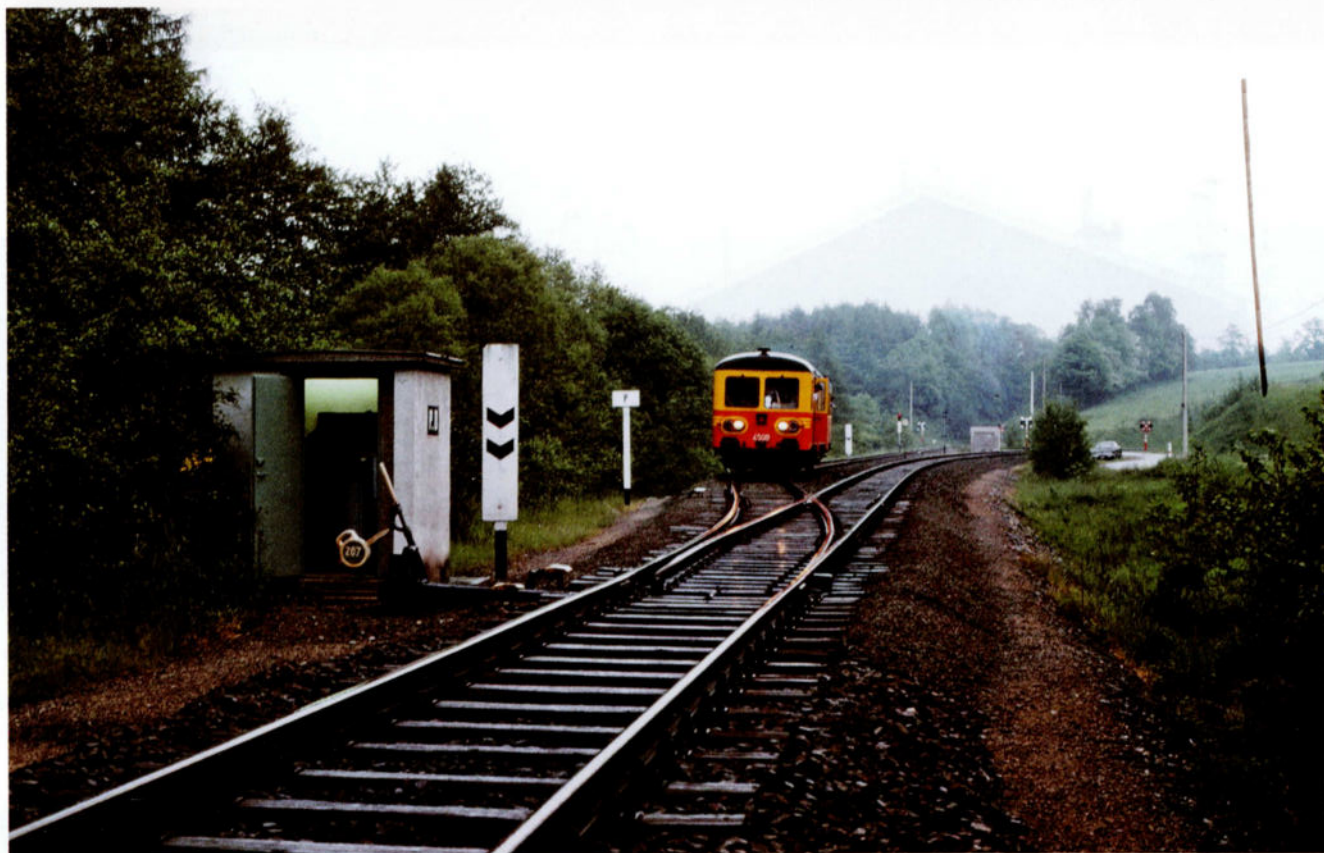
Bif. St-Lambert, le 3 juin 1978: la ligne 136 (à gauche) rejoint la 132 (à droite). A gauche, le poste-satellite d'où se déroulent les communications téléphoniques et les slots de libération des clés des aiguillages. L'autorail en direction de Walcourt a déjà franchi l'aiguille de déraillement.
