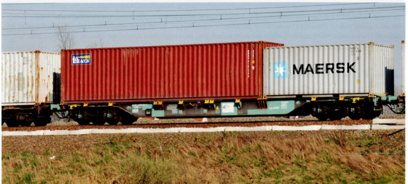
Le wagon 33 RIV 88 B-IFB 4565 561-6 dont le propriétaire est Inter Ferry Boats, avec un grand logo. Le couvercle vert des boîtes d'essieu indique que le propriétaire des roues est IFB. Auparavant, ces wagons (et leurs roues) appartenaient encore à TRW (ce n'est plus le cas que pour quelques-uns). A noter qu'au sein de la SNCB, on parle de TRW/IFB, alors qu'il s'agit de deux filiales distinctes.
