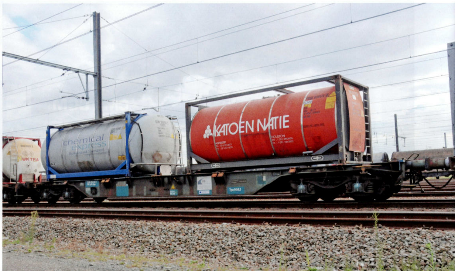
Le wagon 33 RIV 88 B-IFB 4554 607-0 transformé en 6454 L0, chargé de deux conteneurs-citernes 'Chemical Express' et 'Katoen Natie'. On voit clairement que le marquage a été modifié et complété. Ce wagon n'est pas équipé de nouveaux essieux (ce qui se voit à la saleté des boîtes d'essieu). Lorsque les roues auront atteint leur limite d'usure, elles seront reprofilées au tour. Port d'Anvers, le 3 octobre 2016.
