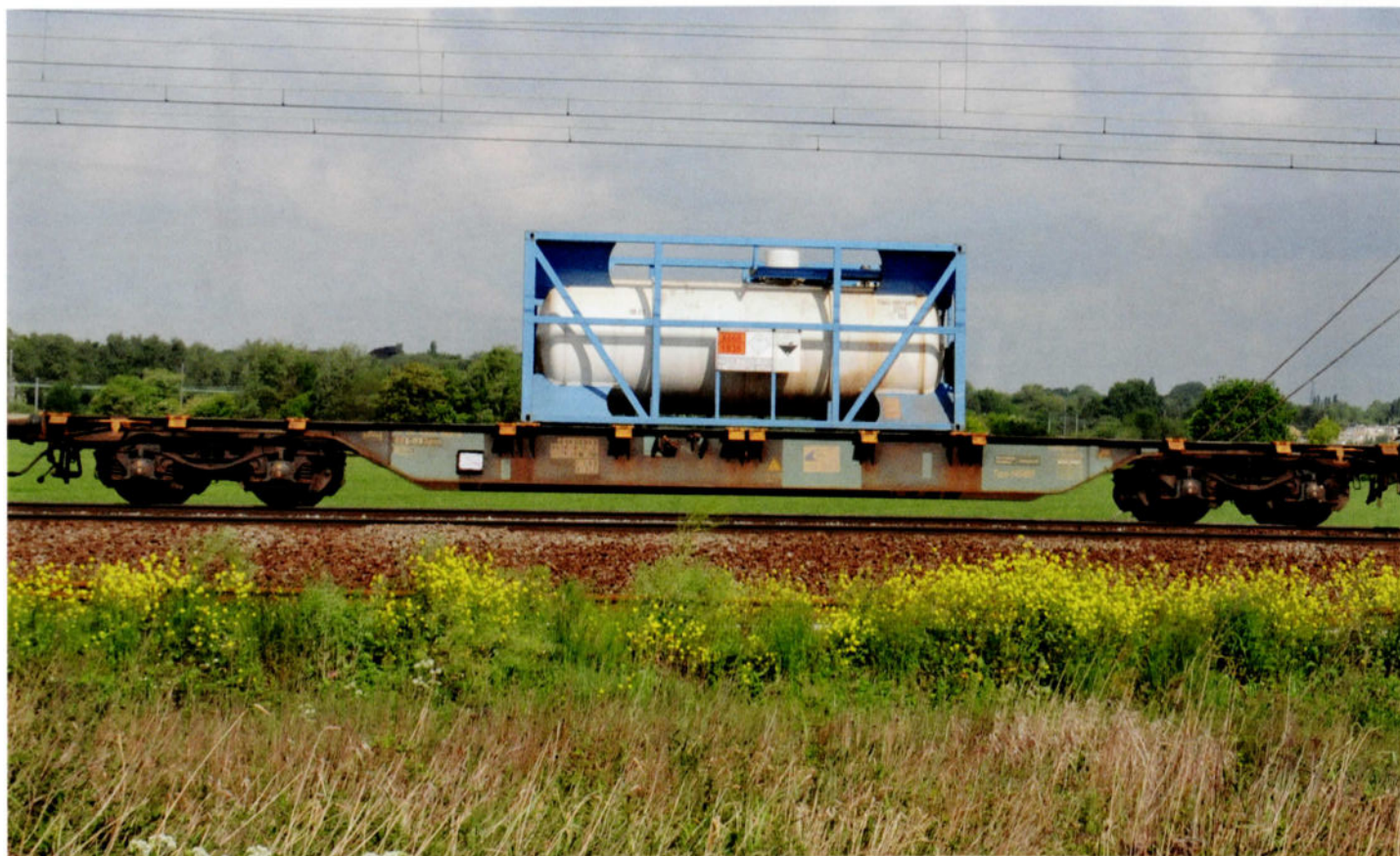
Le wagon 33 RIV 88 B-IFB 4565 668-9 à petit logo, chargé d'un conteneur-citerne contenant un produit RID (du tétrachlorure de titane). Ce wagon est pourvu de tôles pare-étincelles, ce qui est indiqué par le cercle blanc, dont la partie supérieure est blanche. Ekeren, le 14 mai 2014.
