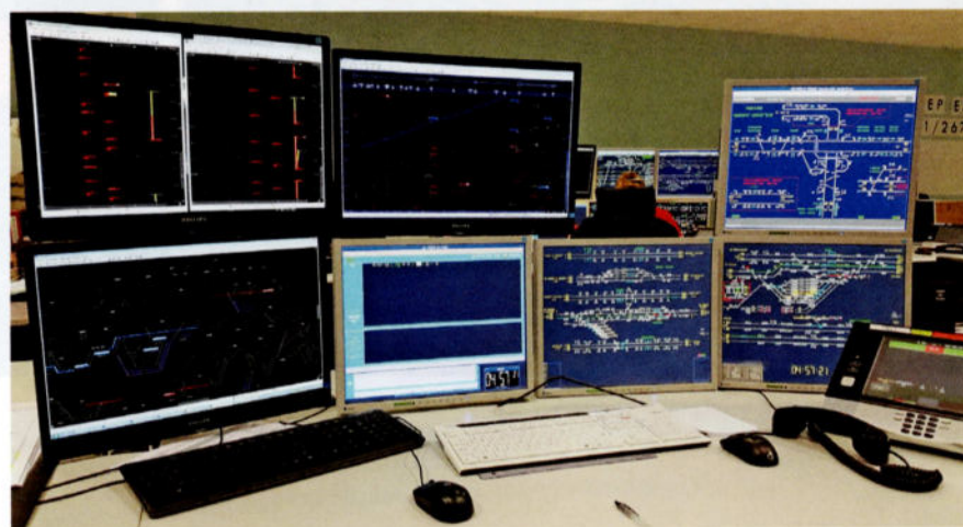
Un poste de travail EBP entièrement dirigé de manière automatisée par le TMS: il s'agit de la ligne 124 et des gares de Braine l'Alleud et de Nivelles.
