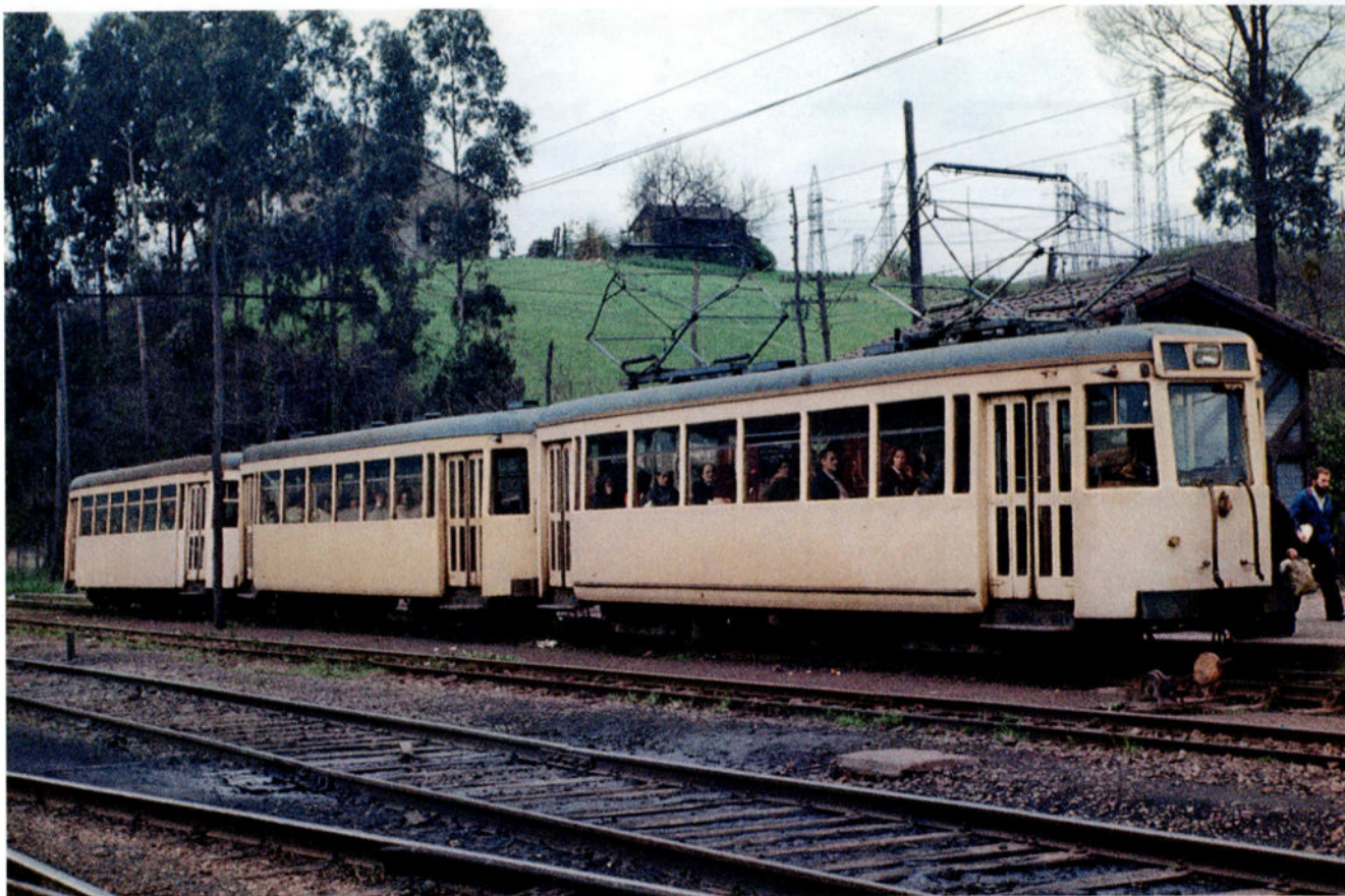
Une rame triple typique du Ferrocarril de Carreño, vue à Aboño, le long de la ligne à voie métrique Gijón - Avilés, à une date inconnue. Cette rame est composée d'une motrice type S, d'une remorque type S provenant du réseau vicinal de Liège et à l'arrière, d'une ancienne prototype du type N (série 10337 à 10339). Au début, le matériel était encore peint en crème. Lorsque cette photo fut prise, les matricules des voitures étaient indiqués par des très petits chiffres apposés sur les longs-pans, ce qui rend l'identification des véhicules extrêmement malaisée. Photo: C. Ariño - Carte postale éditée par l'Asociación de Aficionados a los Ferrocarriles.
