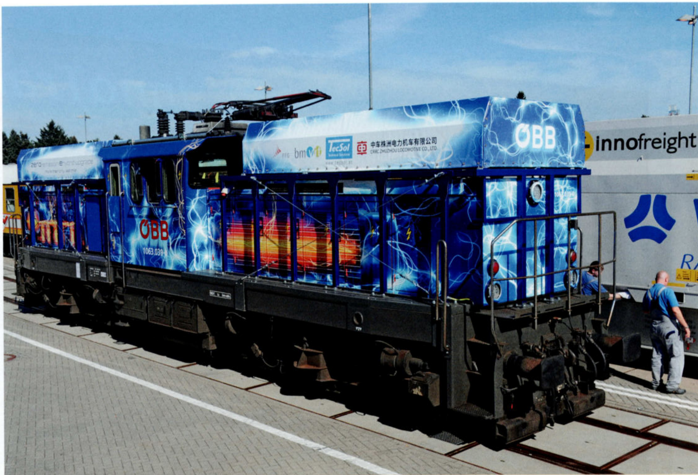
Les locomotives électriques de la série 1063 sont en service depuis des années aux ÖBB. Les chemins de fer autrichiens testant de nouvelles formes de motorisation, la 1063 039 a été équipée de super-condenseurs pour pouvoir circuler sans caténaires. Photo: Quintus Vosman.
