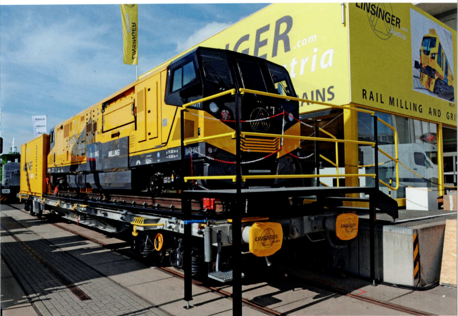
Oltre un train de meulage, la firme Linsinger avait également amené un train de fraisage à Berlin. Cet engin était disposé sur des rails placés sur un wagon plat. Grâce à cette disposition, de nombreux problèmes de transport sont évités, surtout du point de vue autorisation de circulation de l'engin. Photo: Quintus Vosman.
