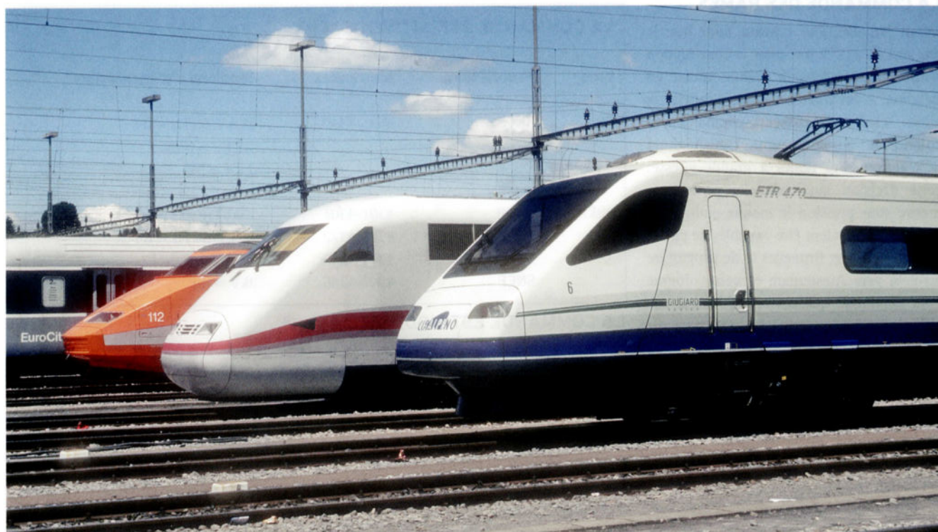
La France fut un précurseur dans la conception des trains à grande vitesse : l'Allemagne et l'Italie ne suivront que plus tard. Sur cette photo prise 13 juin 1997 par Max Delie à Lausanne, on peut voir à l'avant-plan une rame italienne Pendolino pendulaire, ce qui veut dire qu'elle s'incline dans les courbes, pour y circuler plus vite. Cette idée ne sera toutefois jamais couronnée de succès... Derrière elle, une rame ICE allemande de 1 ère génération : ce type de matériel aurait dû constituer un concurrent sérieux du TGV, mais il apparut beaucoup trop tard. Plus loin encore, on aperçoit le nez d'une rame TGV 'Sud-Est' de la SNCF et derrière, une ancienne automotrice TEE du type 'RABe' (ex RAe) des CFF, qui succéda aux rames TEE Diesel 'RAM'. En 1997, ces automotrices n'assuraient déjà plus de services TEE et avaient été repeintes dans une nouvelle livrée.
