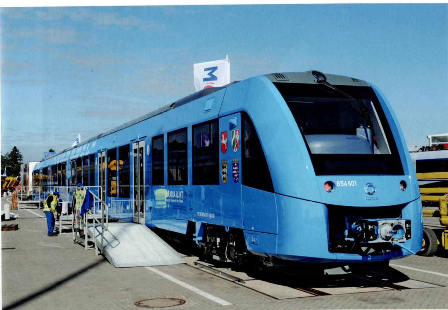
Il fut l'objet de tous les regards: l'autorail 'iLint' d'Alstom, qui fonctionne à l'hydrogène. Alstom se focalise clairement sur ce type de carburant, qui n'émet aucun gaz d'échappement. Photo: Quintus Vosman.
