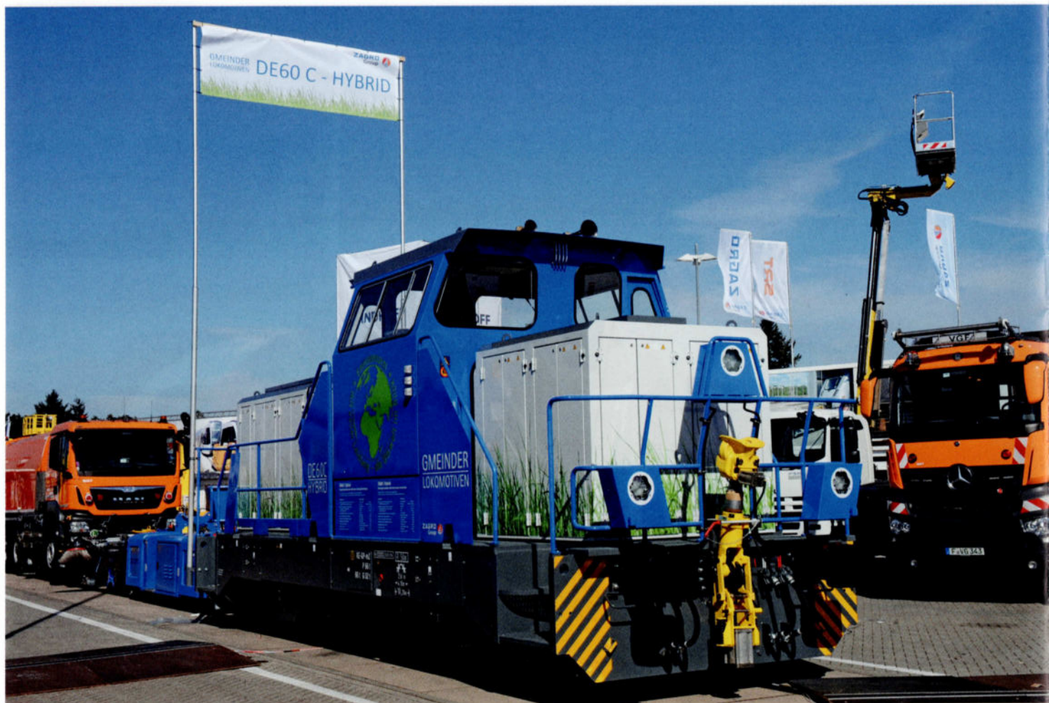
Gmeinder présentait sa locomotive DE60C en livrée hybride. Cette locomotive, construite à l'origine en version Diesel, a récemment été transformée en version hybride. Gmeinder essaye d'engranger des commandes portant sur la transformation de matériel existant en mode hybride. Photo: Quintus Vosman.
