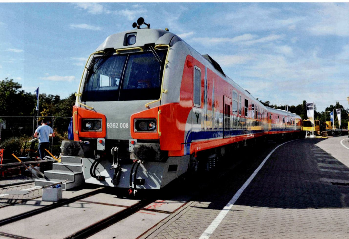
Les MAV (les chemins de fer hongrois) ont formé cet autorail de mesures au moyen de deux voitures déclassées. Cet engin est apte à 120 km/h, mais les mesures s'effectuent jusqu'à 70 km/h. Photo: Bart B.
