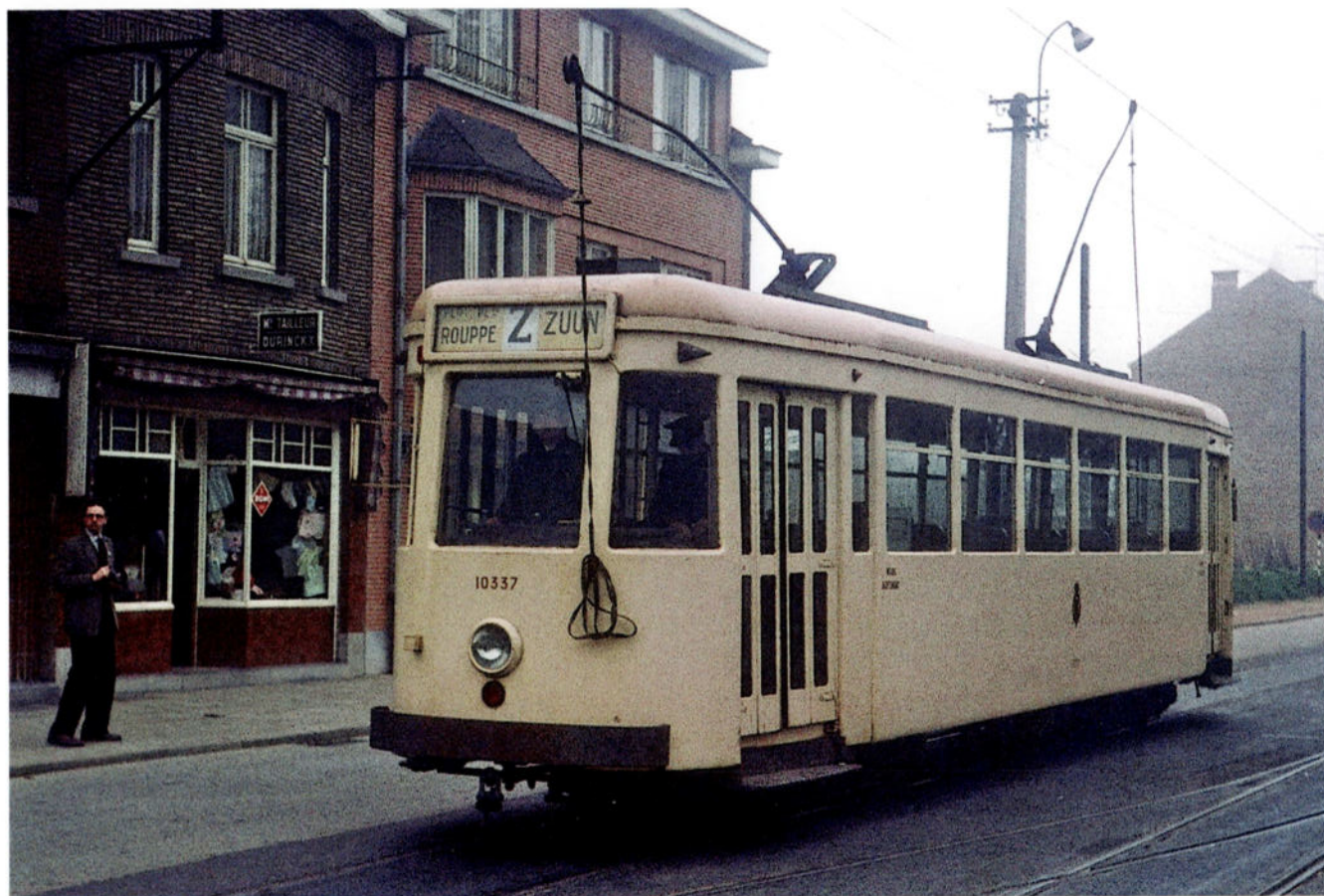
La 10337 stationne au terminus de 'Zuun' (dans la Georges Wittouckstraat à Leeuw-St-Pierre), en avril 1962; elle en repartira bientôt vers la place Rouppe. Par rapport aux motrices type N définitives, les prototypes 10336 à 10339 étaient faciles à reconnaître grâce à leurs flancs planes et au petit retrait de la caisse à hauteur des étroites fenêtres latérales. Ces motrices conservèrent leurs bogies d'origine et ne furent jamais pourvues de baguettes latérales antichocs. La 10337 illustrée ici termina sa carrière en Espagne. Photo: W.J. Wyse - Collection Trama-nia (photo 08266).
