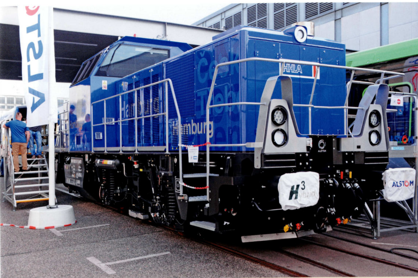
La Prima H3 d'Alstom a trouvé son chemin sur le marché. Une de ces H3, livrée à la HHLA (le port d'Hambourg) était exposée à InnoTrans. Outre ces locomotives à trois essieux, Alstom va en réaliser à deux bogies à deux essieux. Photo: Quintus Vosman.
