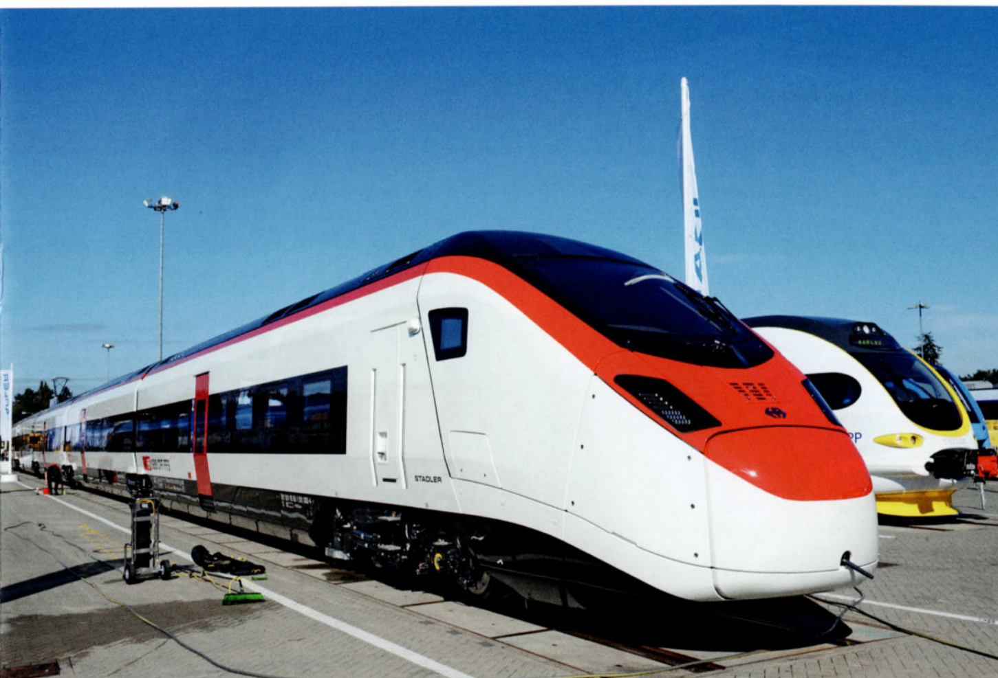
La rame à grande vitesse 'Giruno' était la fierté de Stadler Rail à InnoTrans. Cette rame sera livrée aux CFF et est destinée au service voyageurs à travers le nouveau tunnel de base du Gothard, où elle pourra circuler à la vitesse de 250 km/h. A l'arrière-plan, un autorail de fabrication Koncar. Photo: Quintus Vosman.
