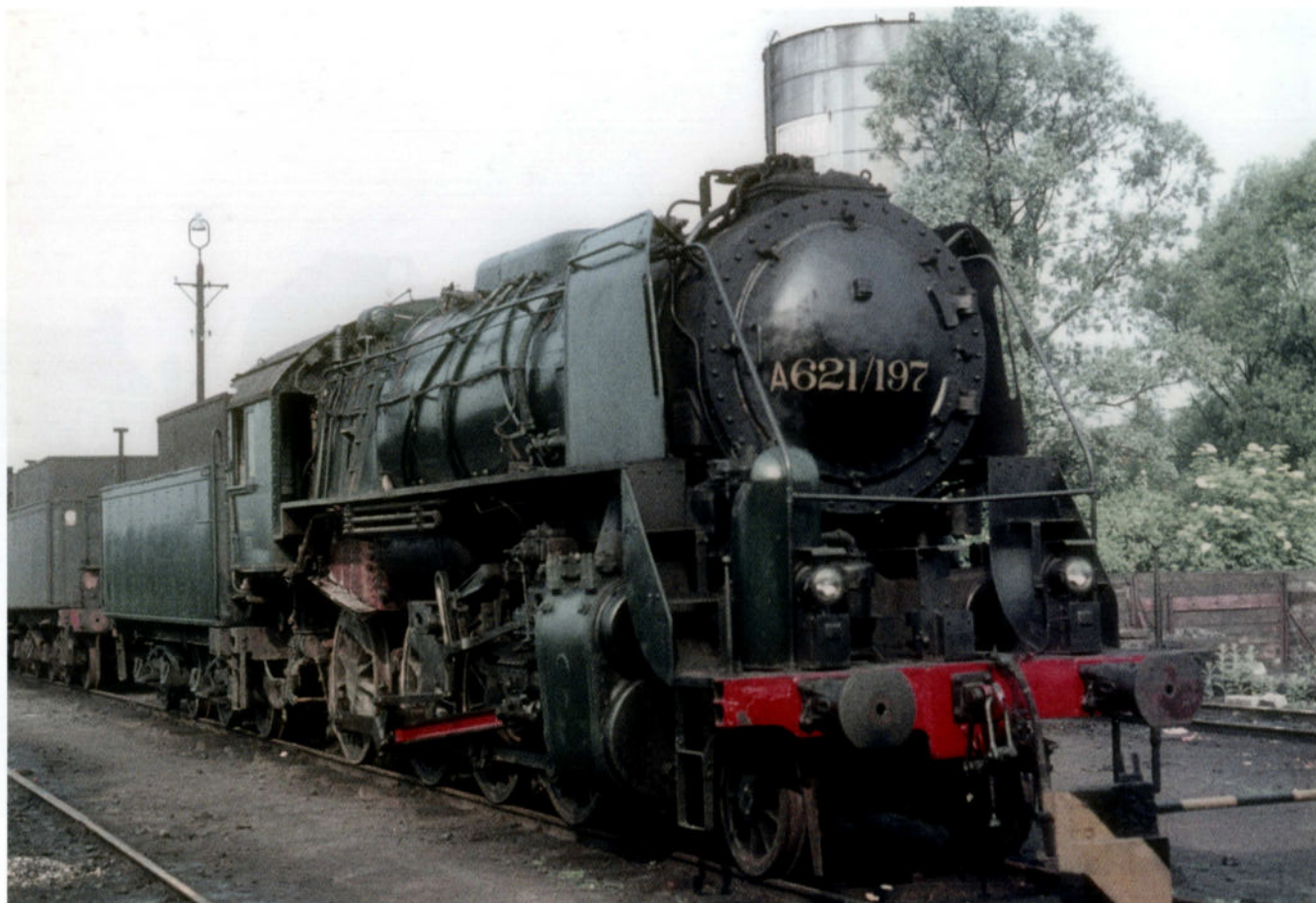
La 29.040 fut l'une des 26 locomotives du type 29 transformées en générateur de vapeur mobile. Renommée A 621/197, elle sera d'abord stationnée à Mons en 1965, pour être transférée en 1966 à Bruxelles-Midi, où elle fut mise définitivement hors service en 1967. La voici en juin 1965, alors qu'elle stationnait à la remise vapeur de Saint-Ghislain.
