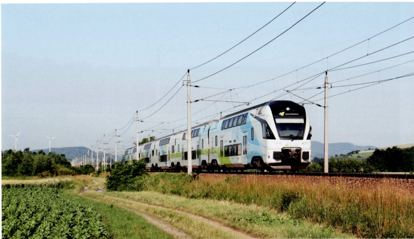
La 4010 003 en route vers Vienne passe à Markersdorf an der Pielach (entre Sankt Pölten et Amstetten), au petit matin du 26 juin 2015. Il s'agit d'un des rares tronçons de la ligne qui n'a pas encore été dédoublé: le trafic à longue distance doit partager ces voies avec le trafic local et les trains de marchandises.
