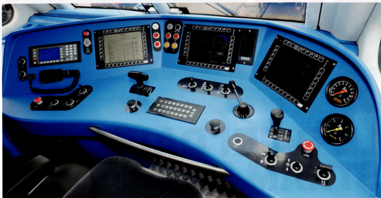
Lors de la transformation effectuée, l'engin a reçu des nouveaux pupitres de conduite, ainsi qu'un système de gestion électronique, ce qui rend sa conduite totalement différente. Ostrava (CZ), le 14 juin 2016. Photo: Quintus Vosman.
