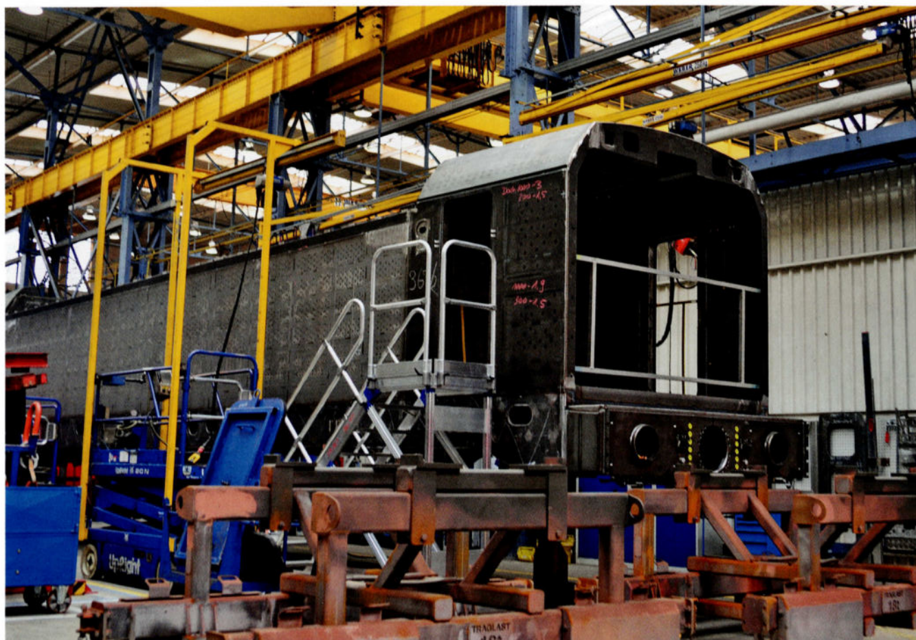
Dans l'un des halls de l'usine, les 'chaudrons' des Vectron sont assemblés par soudage avant d'être mis en peinture; l'assemblage final de la loco se poursuit ensuite.
