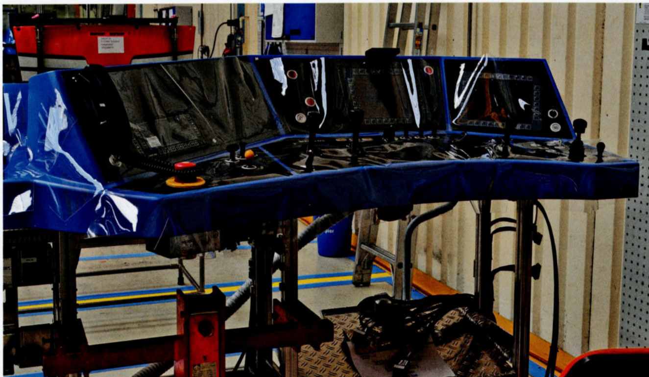
Une 'planche de bord' est prête à être posée sur un pupitre de conduite. L'ensemble est protégé de dégradations au moyen d'un film en plastique.
