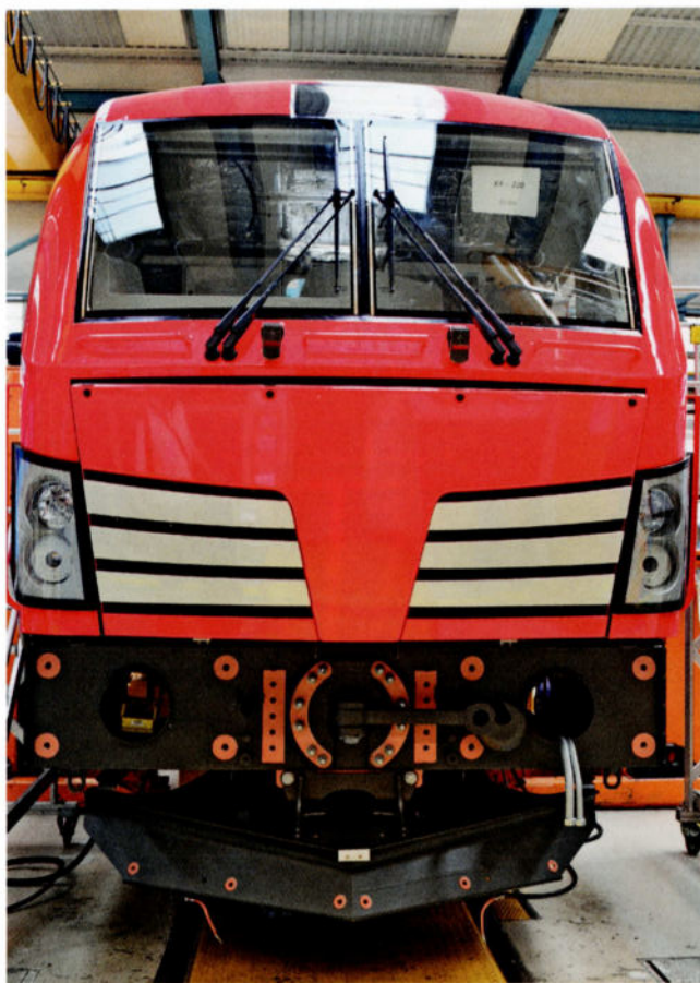
Contrairement à la loco finlandaise, cette loco - encore démunie de ses tampons - a été équipée d'un traditionnel attelage à vis.
