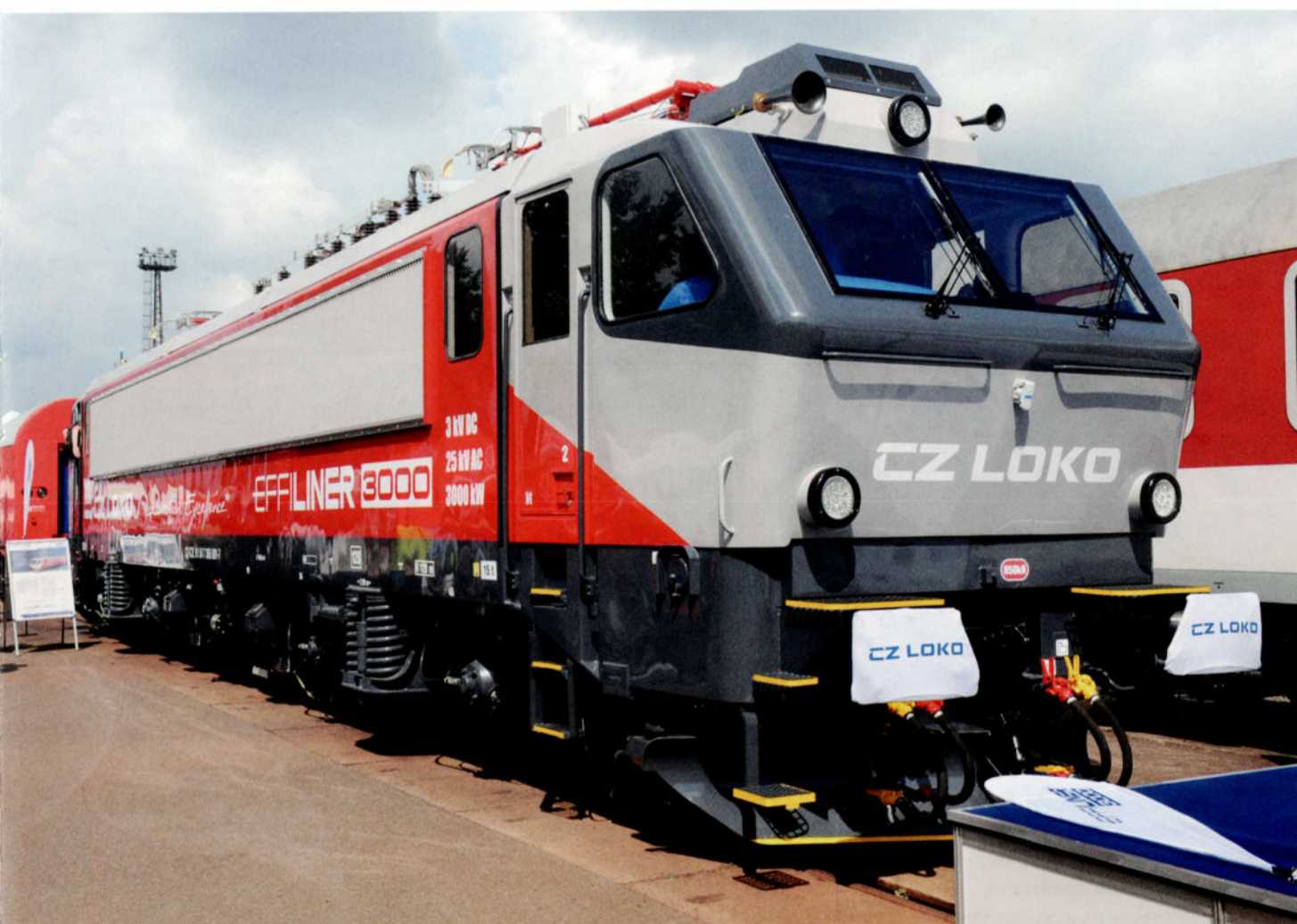
La livrée de cette nouvelle loco de CZ Loko est faite de rouge et de deux tons de gris. Cette loco a été équipée de nouveaux phares à lampes LED, le 3 ème phare central ayant émigré au-dessus de la cabine de conduite. Ostrava (CZ), le 14 juin 2016. Photo: Quintus Vosman.
