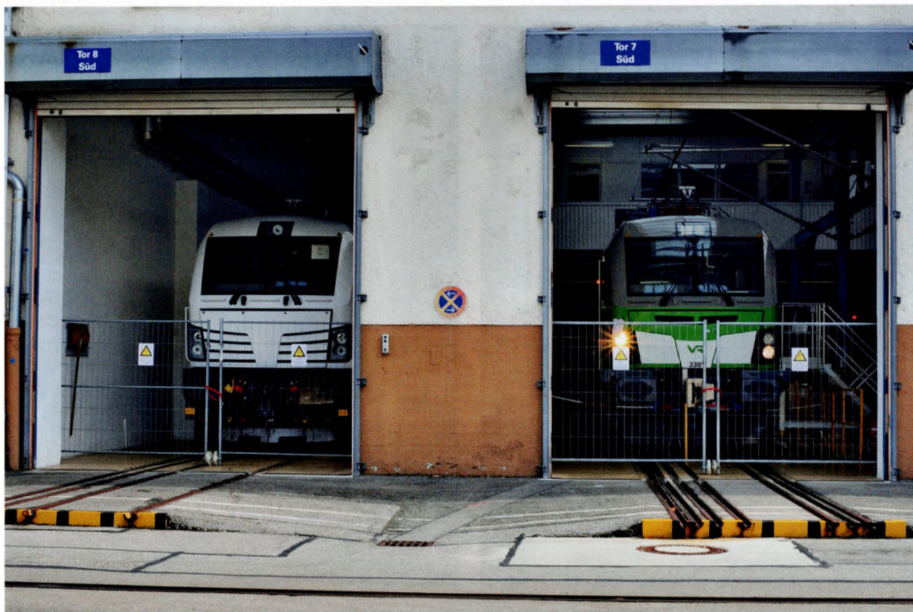
Les stands d'essais à haute tension sont verrouillés pendant les essais; ils sont pourvus de rails à différents écartements, ce qui vient bien à point pour la loco finlandaise (à droite), prévue pour circuler sur des voies à l'écartement russe.
