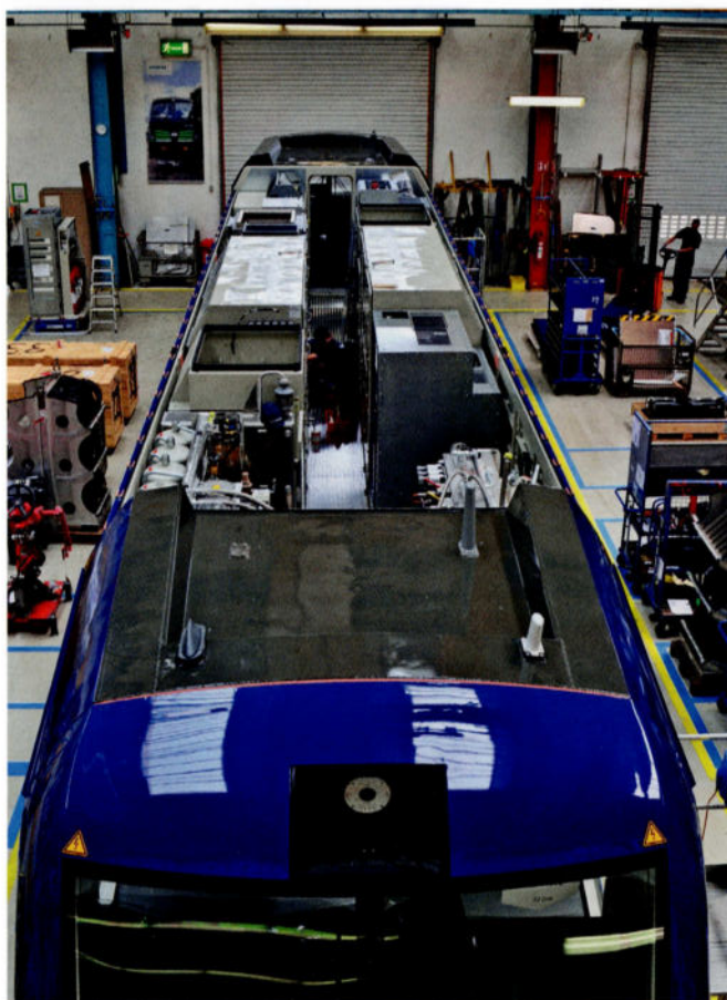
Les armoires contenant l'appareillage électronique ont été posées, ainsi que le compresseur et certains réservoirs à air.
