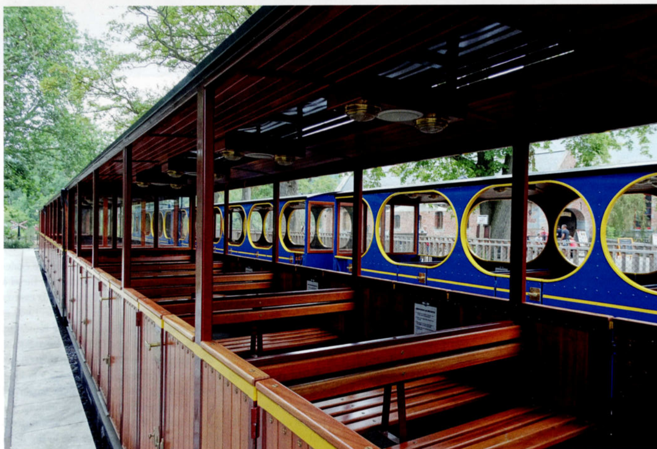
Une vue de détail qui illustre clairement les différences de construction entre les deux rames de baladeuses: la rame brune est en bois verni, tandis que la rame bleue est tôle. Photo: Michel Van Ussel, le 21 juillet 2016.
