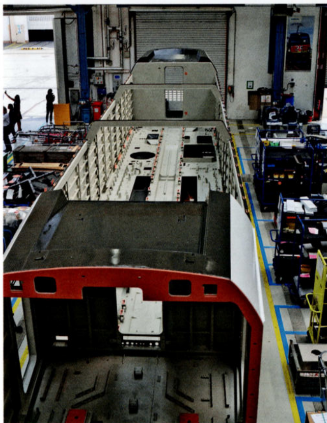
Depuis la galerie, on voit clairement que ce chaudron de loco n'est encore qu'une boîte vide, pourvue des chemins de câble et des points d'appui nécessaires au montage ultérieur de l'appareillage.
