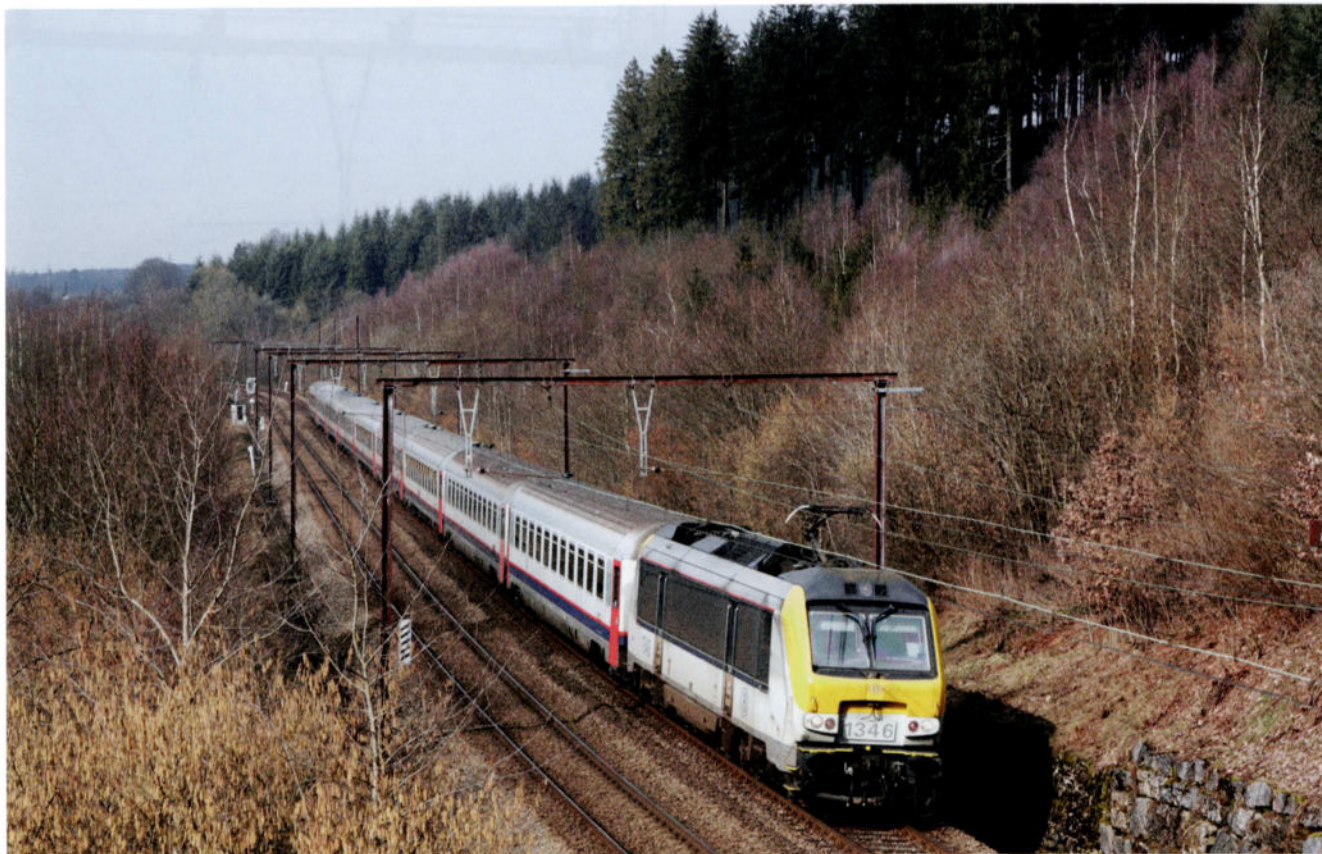
Entre Lavaux et Marbehan sur la ligne 162, les travaux de remplacement des portiques de caténaires 3000 V par des poteaux prévus pour le 25 kV n'ont pas encore débuté. Un environnement ferroviaire 'datant de bon papa' sert encore de décor au passage du train 97 'Iris' à destination de Bâle, composé de neuf voitures SNCB. Les trois premières derrière la 1346 sont limitées à Luxembourg. Mellier, le 11 mars 2016. Photo: Bertrand Montjobaques.
