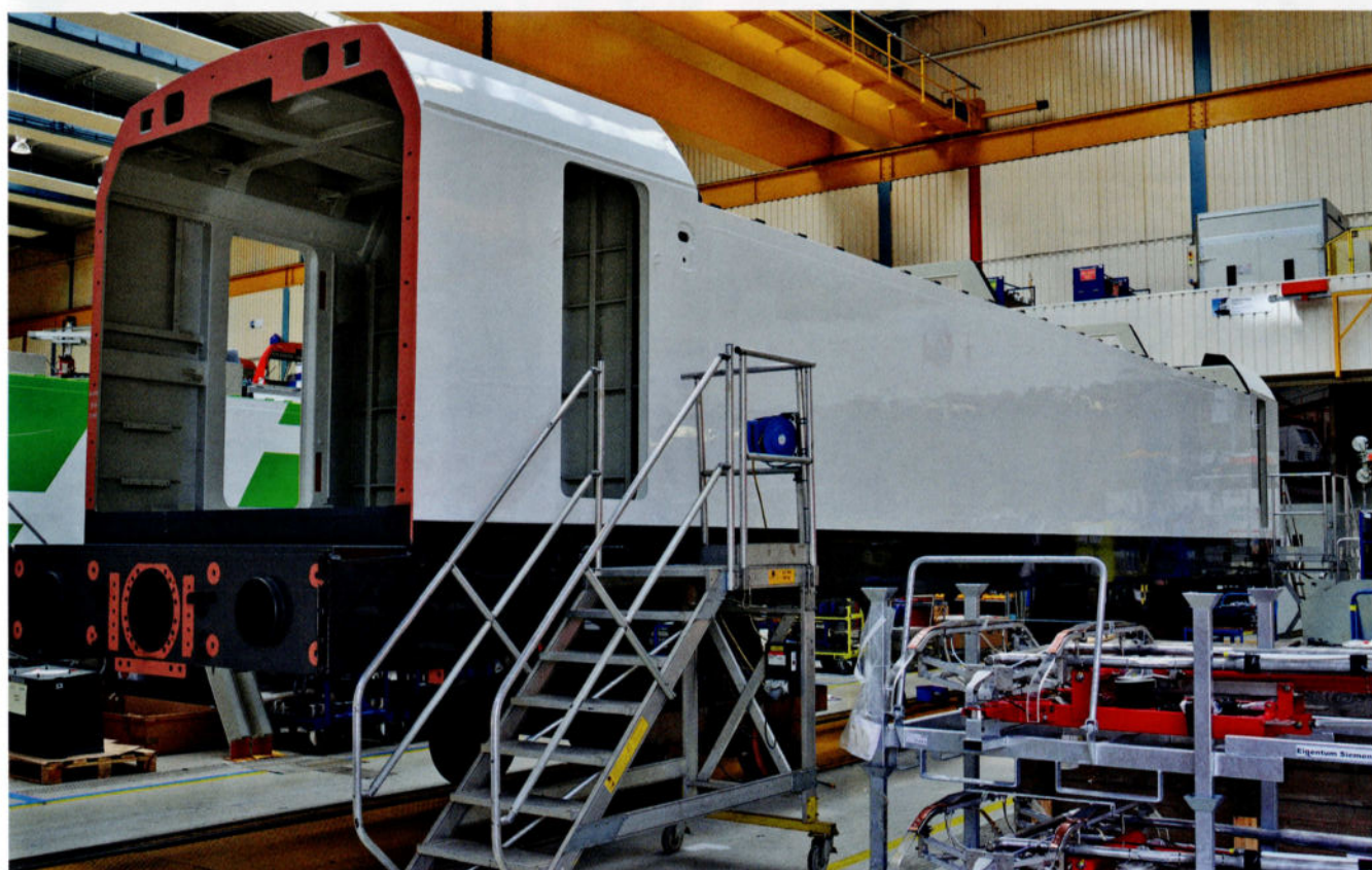
Une caisse de loco déjà peinte attend d'être appareillée dans le hall d'assemblage. A ce stade, la loco n'est encore qu'une boîte vide reposant sur des bogies d'atelier.
