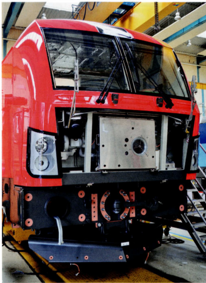
Sur l'autre face de cette loco à la livrée rouge, la plaque d'about du carénage a été déposée, ce qui permet d'apercevoir le refroidisseur de l'ordinateur de bord, disposé sous le pupitre de conduite.
