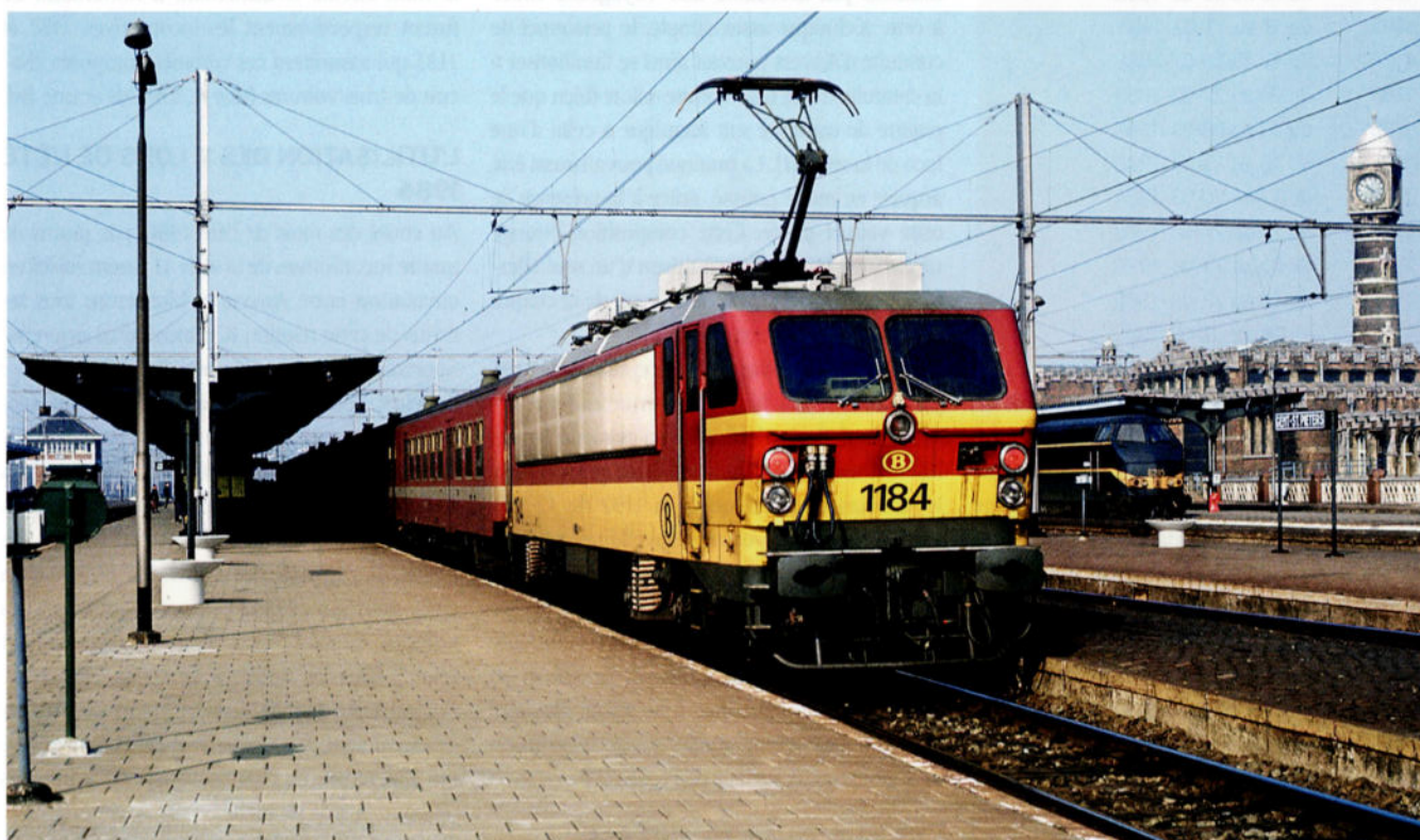
La gare de Gand-St-Pierre, avec sa tour de l'horloge et son ancienne cabine de signalisation au bout des quais. On voit également une série 62 en livrée verte, sans la large bande jaune. La présence d'une série 11 en pousse d'une rame de voitures M4 en livrée bordeaux trahit le fait que nous sommes pendant les huit premiers mois de l'année 1986: la 1184 pousse le train IC 'C' 559 d'Anvers-Central vers Mouscron; quant à la 6285, elle est prête à assurer le train IR 'e' 1708 à destination d'Eeklo. Photo: Carlo Hertogs, le 15 mars 1986.
