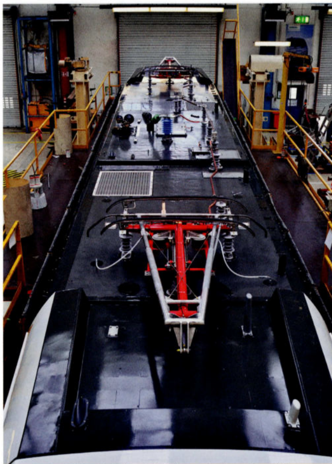
Les pantographes, isolateurs de toiture et autres dispositifs électriques ont été fixés sur le toit: la loco peut désormais être acheminée vers le stand des essais à haute tension.
