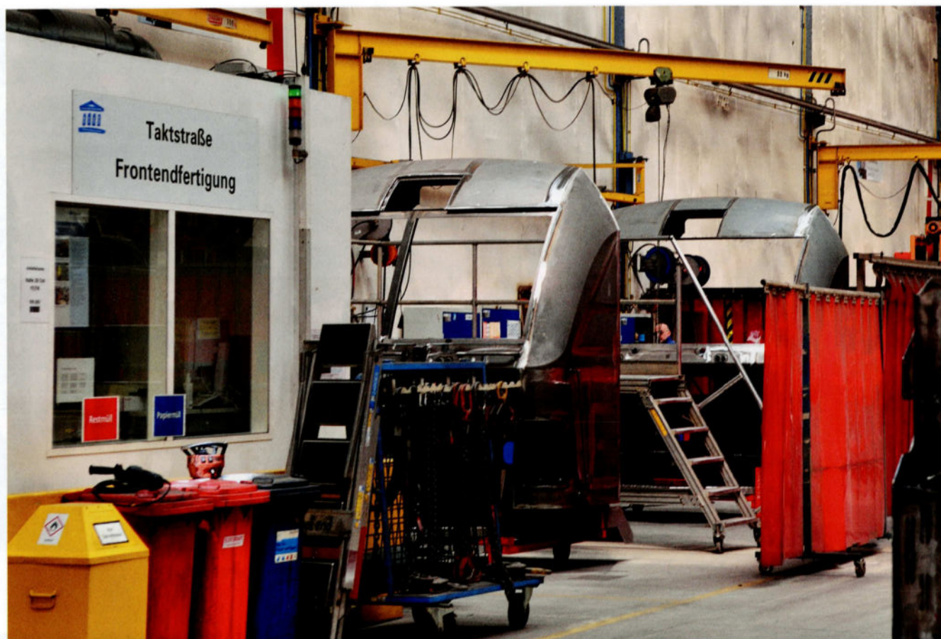
Sur la galerie du premier étage, quelques carénages frontaux attendent d'être posés, après assemblage des postes de conduite.
