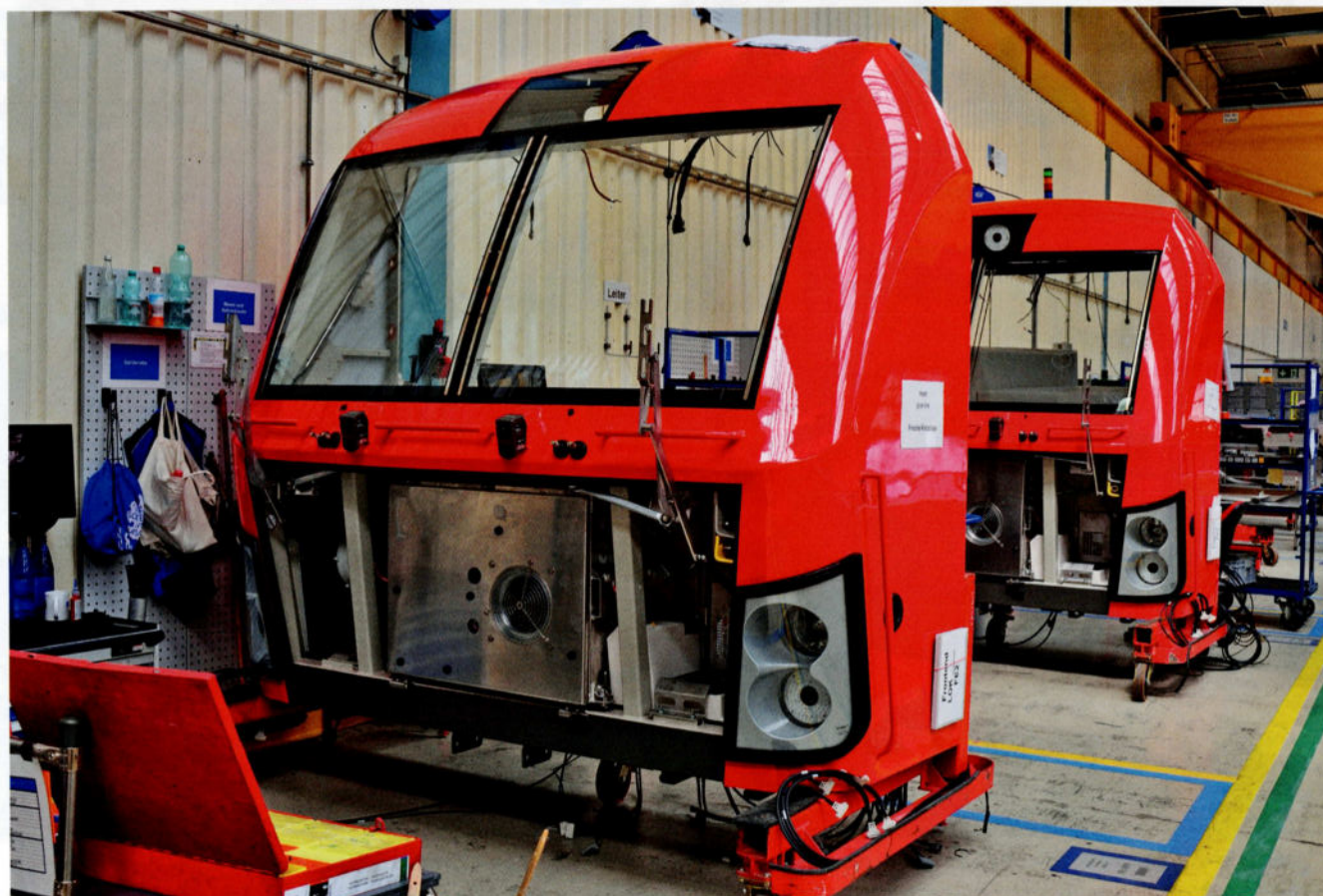
Ces carénages frontaux sont déjà dans un stade d'assemblage plus avancé, car équipés de différents appareils (phares, ordinateur, etc.)
