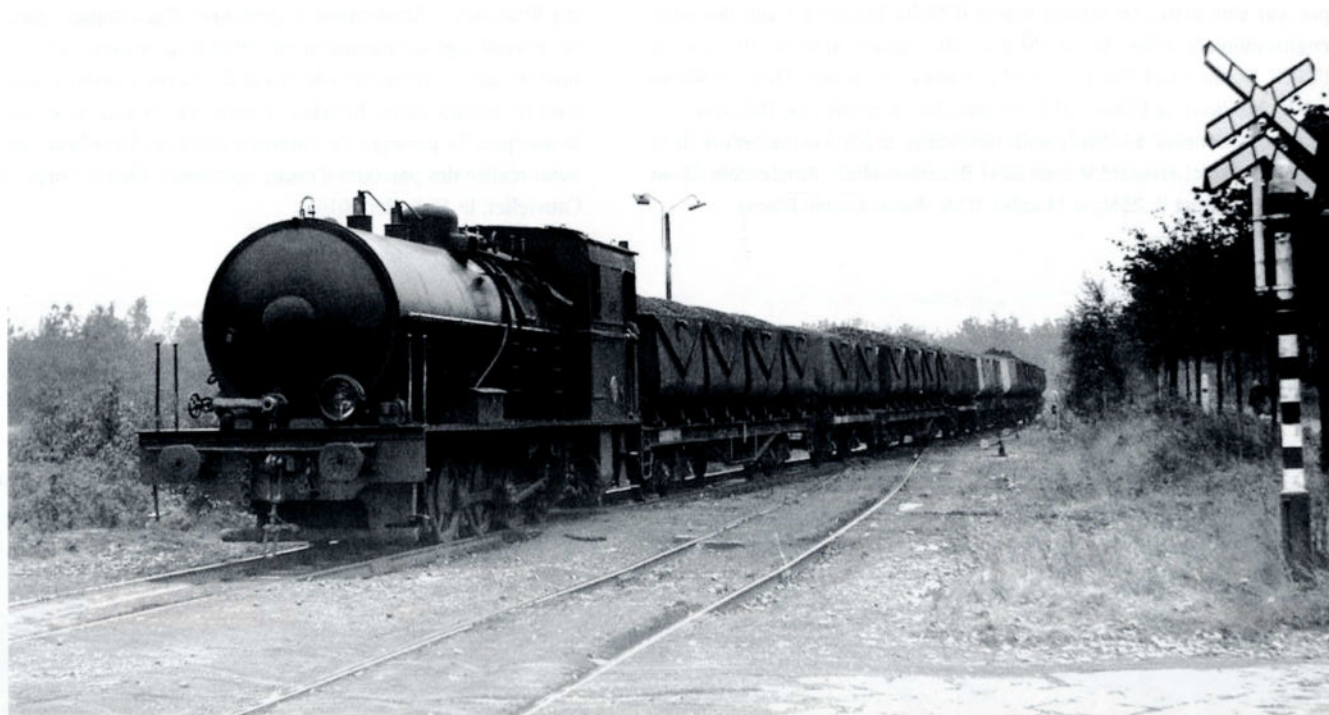
Des photos de locomotives à vapeur sans foyer en activité sont rares. En voici une de la loco n°12 du charbonnage de Beringen, qui remorque une rame de wagons 'Kübel' chargés de charbon entre la mine et le port charbonnier de l'endroit. La chaudière des locomotives sans foyer était remplie de vapeur au moyen d'une installation fixe; ce type de loco était utilisé sur des sites où du feu ne pouvait en aucun cas être produit, sous peine d'explosion. Ceci étant, nous ne disposons pas de beaucoup plus d'infos concernant ce type de locos: un lecteur pourrait-il nous aider?
