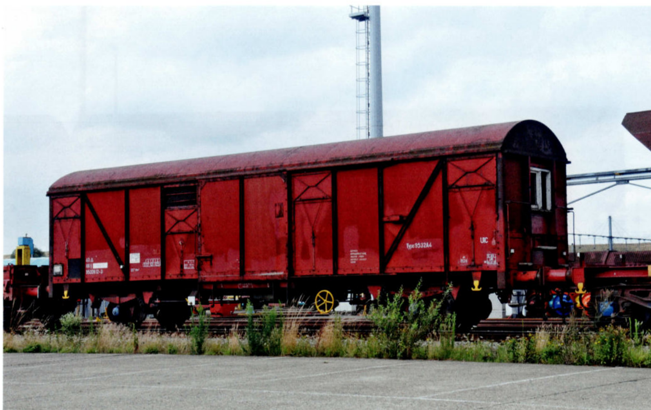
Le wagon 40 \Delta 88 B-Infrabel 953 2 812-3 est toujours en service sous le type 9532 A4 (un ex 2216 A2) et a été transformé en wagon-frein, ce qui se voit à la fenêtre placée dans la face d'about. Ce wagon est garé au CHW Anvers-Nord pour un 'grand entretien', le précédent (valable 3 ans) ayant été effectué le 31-07-12 par LNC (CHW Monceau). Il porte le marquage suivant: 'Service Infrastructure - Wagon frein - District Sud-Est - Liège'. CHW Anvers-Nord, le 4 août 2015.
