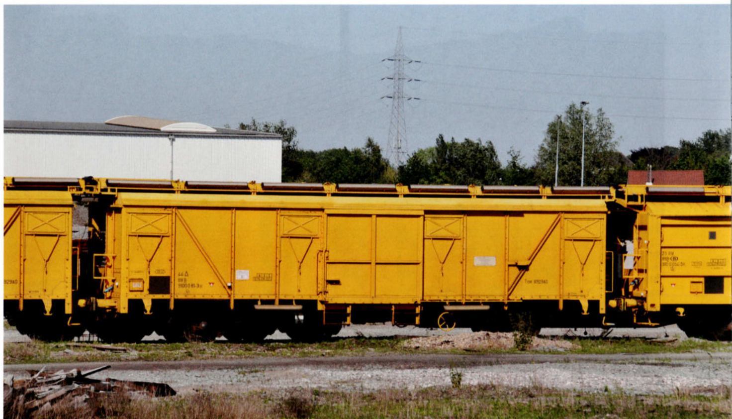
Un wagon de la firme Fabricom-GTI du type 6929 A0, avec code-lettres 'Us'. Ce wagon porte le matricule rare 44 \Delta 88 B- 9100 0 81-3. Il a été équipé d'une série de 18 tubes TL et d'une plate-forme sur le toit pour permettre des travaux aux caténaires. Merelbeke-Formation, le 25 mai 2012.
