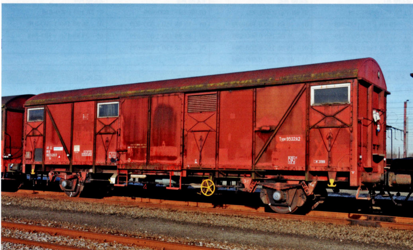
Le wagon 40 \Delta 88 B-Infrabel 953 2 420-5 a été équipé de 3 fenêtres et d'une grille d'aération. Il porte le marquage suivant: 'Gevaar bij heuvelen - Niet stoten' (Danger lors d'un passage en bosse - Ne pas tamponner). CHW Anvers-Nord, le 16 janvier 2012.
