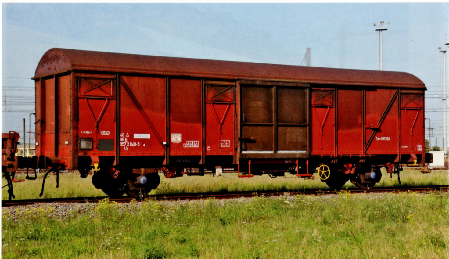
Ce wagon Infrabel portant le code-lettres 'Uy' attend sa prochaine mission; il est pourvu d'un frein à main, de roues à bandages et de couvercles bleus de boîtes d'essieu. Son matricule est le 40 \Delta 88 B-Infrabel 957 2 840-5. Anvers-Nord (faisceau 'B2'), le 6 septembre 2010.
