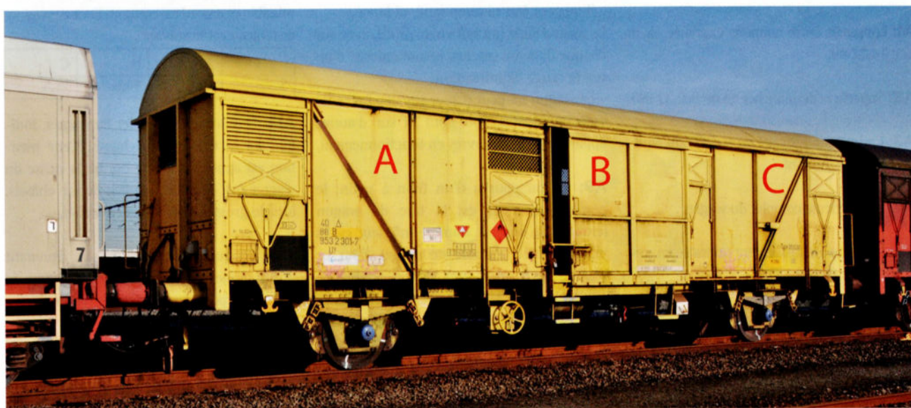
Un wagon Infrabel du type 9532 A1 à code-lettres 'Uy' équipé d'un frein à main et entièrement peint en jaune. Ce wagon présente une grille d'aération supplémentaire sur une face d'about et porte le marquage suivant: 'S.V.C. Wagon générateur Schaerbeek'. Autre originalité: il porte un matricule purement Infrabel: 31.942.491.60. Cette numérotation se retrouve également sur les engins de la Voie Plasser & Theurer. CHW Anvers-Nord, le 16 janvier 2012.
