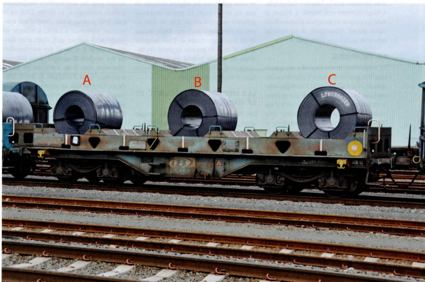
Le wagon 31 RIV 88 SNCB 478 9 432-2 chargé de trois coils identiques, sans marquage. Ce wagon est pourvu d'une main courante sur toute sa largeur, de marchepieds supplémentaires au-dessus des tampons et d'un frein à main. Port d'Anvers (faisceau 'Ijsland'), le 21 février 2010.
