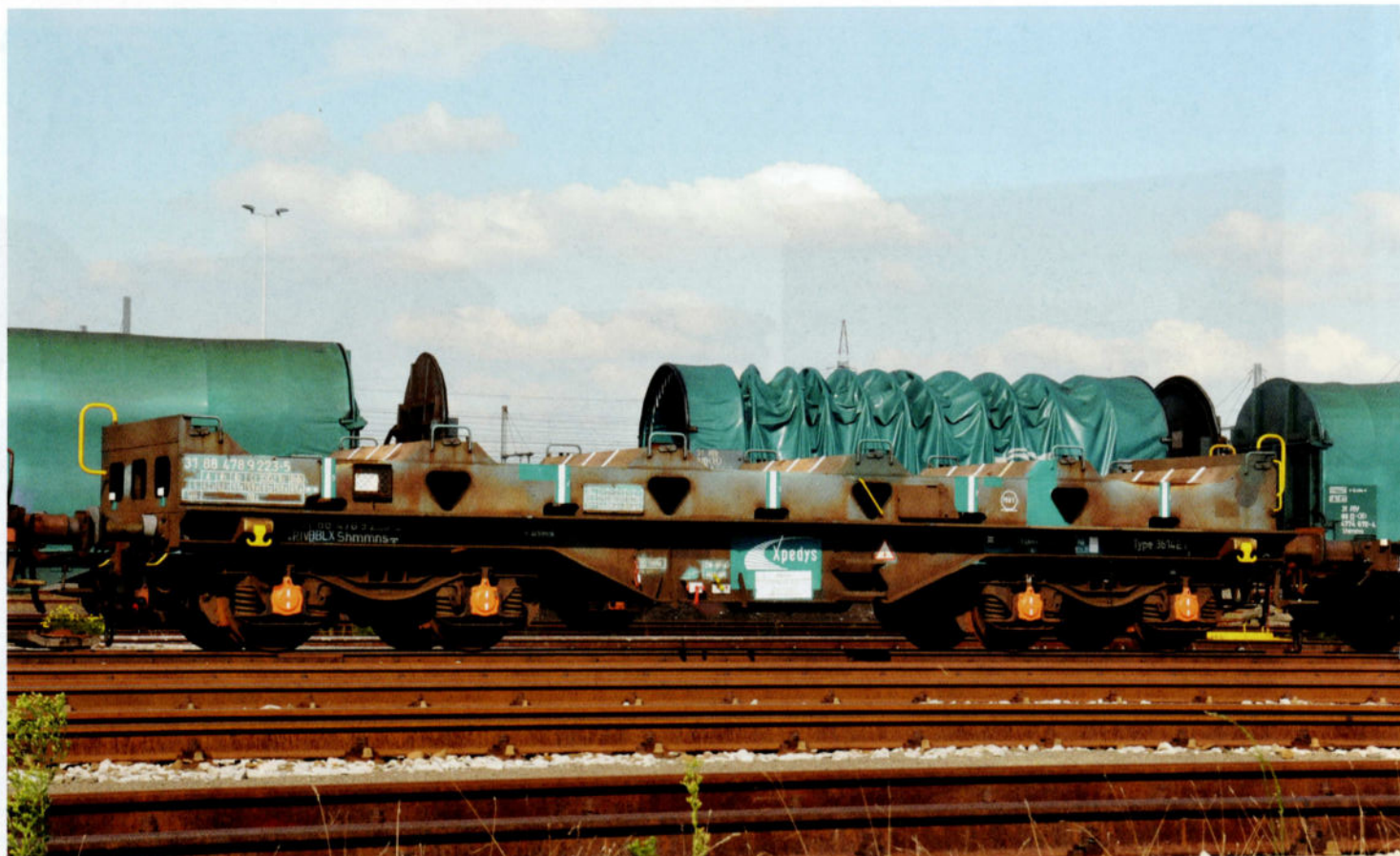
Lors de la révision intermédiaire du wagon 31 RIV 88 B-BLX 478 9 223-5, ses mains courantes pour manœuvres ont été repeintes en jaune; à l'origine, elles l'étaient en blanc, ce qui n'est plus réglementaire. Ce wagon est décoré du premier logo Xpedys; en dessous, un autocollant blanc reprend toutes les données du propriétaire du wagon. Anvers-Nord, le 10 septembre 2015.
