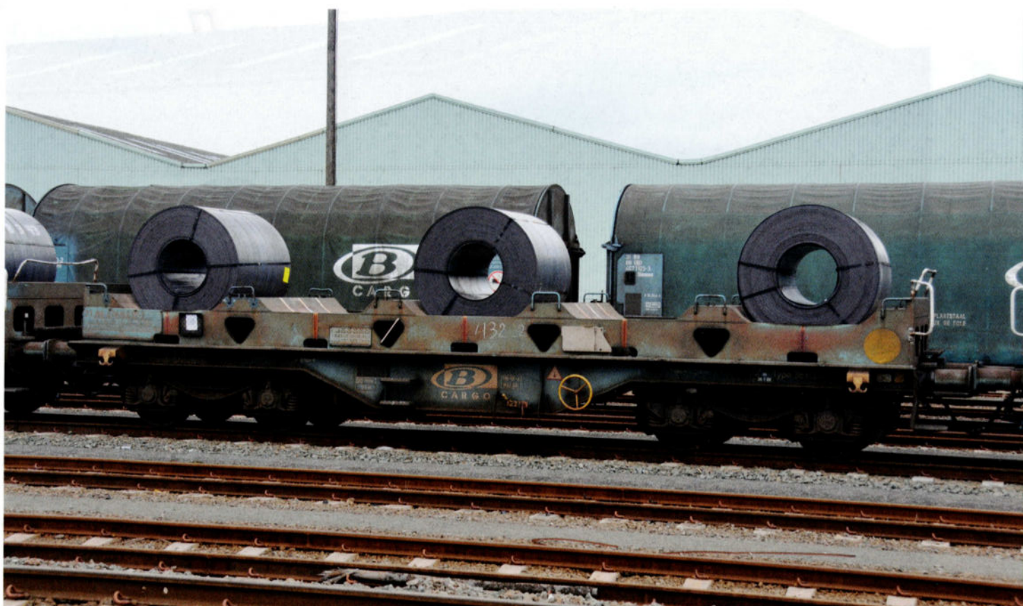
Le wagon 31 RIV 88 SNCB 478 9 432-2 chargé de trois coils identiques, sans marquage. Ce wagon est pourvu d'une main courante sur toute sa largeur, de marchepieds supplémentaires au-dessus des tampons et d'un frein à main. Port d'Anvers (faisceau 'Ijsland'), le 21 février 2010.
