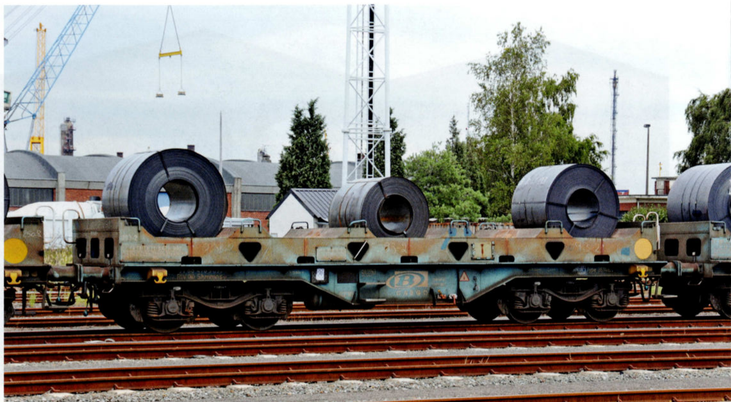
Le wagon 31 RIV 88 SNCB 478 9 093-2 est chargé de trois colis, selon les prescriptions de chargement: les plus lourds sont chargés au-dessus des bogies. Port d'Anvers (faisceau 'Ijsland'), le 27 août 2009.
