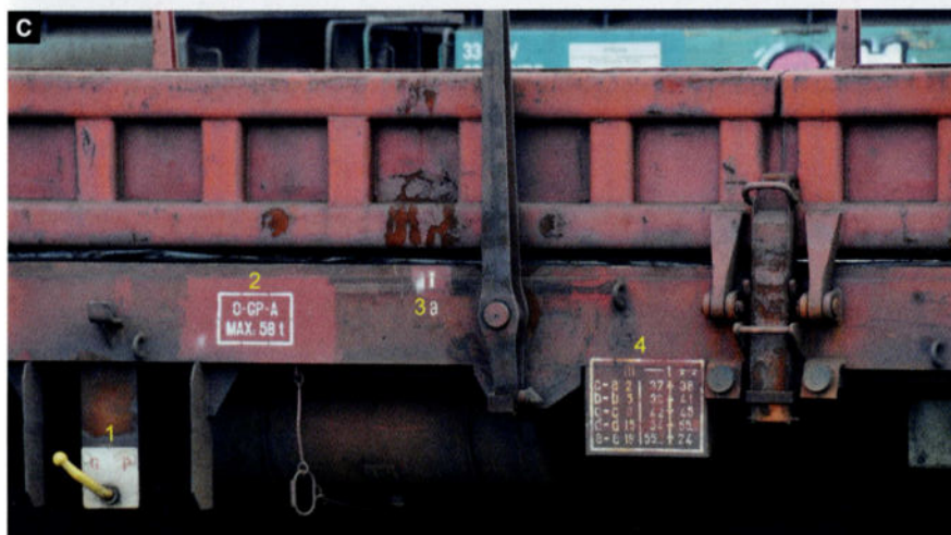
C-3: Le repère de longueur 'a' que l'on retrouve sur le tableau des charges (voir photo 'C-4').
