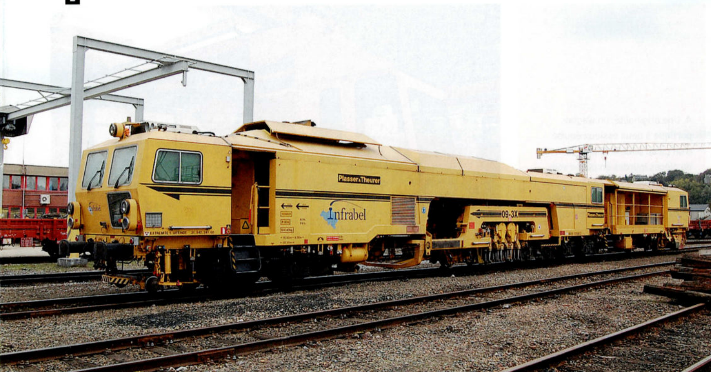
2. Une des quatre bourreuses-niveleuses-dresseuses du type 09-3X de fabrication Plasser & Theurer (° 2009) en service chez Infrabel. Cet imposant engin peut circuler à la vitesse maximale de 100 km/h, tant en traction autonome que remorqué.
