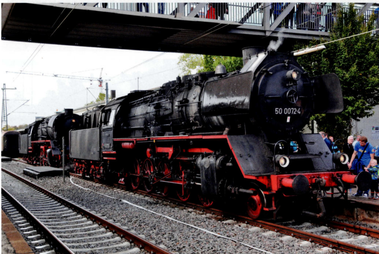
La 050 0072-4 de l'ex-Allemagne de l'Est fit partie d'une série de 70 locomotives, transformées à partir de 1966 pour être chauffées au fuel et immatriculées dans un premier temps dans la série 50 50. Lors de l'instauration de la numérotation digitale, cette série devint la 50 00. Un élément caractéristique des locos transformées par la DR était le réchauffeur de forme conique, placé à l'avant de la chaudière.
