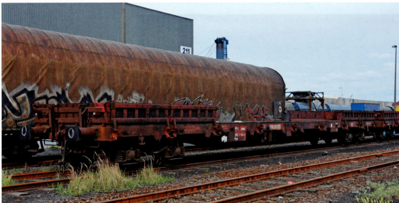
Le wagon 84 Δ 88 B 392 3 753-6 est un des rares de cette série à ne plus être équipé de ranchers. Comme il n'est pas chargé, on voit clairement le profilé triangulaire en métal soudé sur le plancher, qui sert à maintenir les conteneurs en place. Port d'Anvers (faisceau Groenland), le 7 avril 2014.
