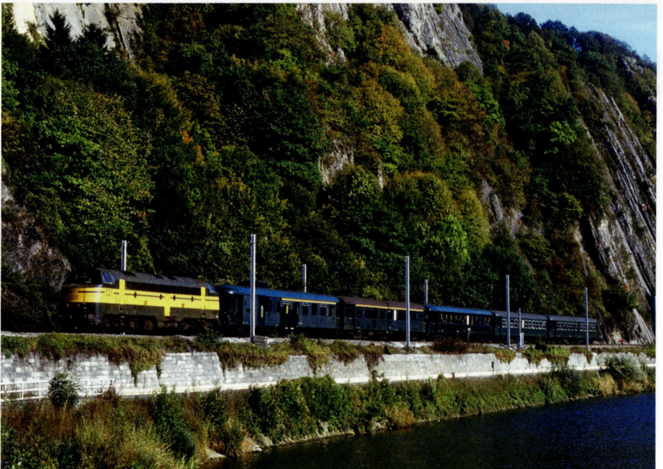
La 5211 se fraie un passage entre les parois rocheuses de la vallée de la Meuse à Yvoir, alors qu'elle est en route de Dinant vers Namur, en tête d'une rame de voitures K. Les poteaux supports des caténaires sont déjà plantés; l'achèvement de l'électrification de la ligne en 1986 aura pour effet d'y bannir les 'gros nez' au profit des automotrices électriques. Photo: Max Delie, le 20 octobre 1985.
