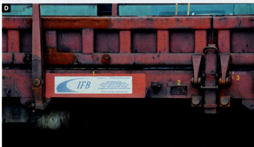
B-1: Tare du wagon non équipé de frein à main (25.000 kg). En-dessous, l'abréviation symbolique de l'atelier et la date des dernières mesures effectuées par cet atelier: LCS (AC Cuesmes) 07-02-07.
