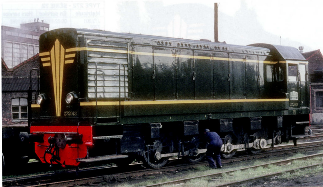
En juin 1963, la 272.013 venait de bénéficier d'une révision à Anvers-Dam, à l'occasion de laquelle cette loco avait été repeinte et la belle plaque de constructeur présente sur le poste de conduite nettoyée. Autre signe de sa sortie récente de révision: les bielles polies. Après quelques services, elles redeviendront vite noires, suite à l'huile et aux poussières. Photo: Max Delie.
