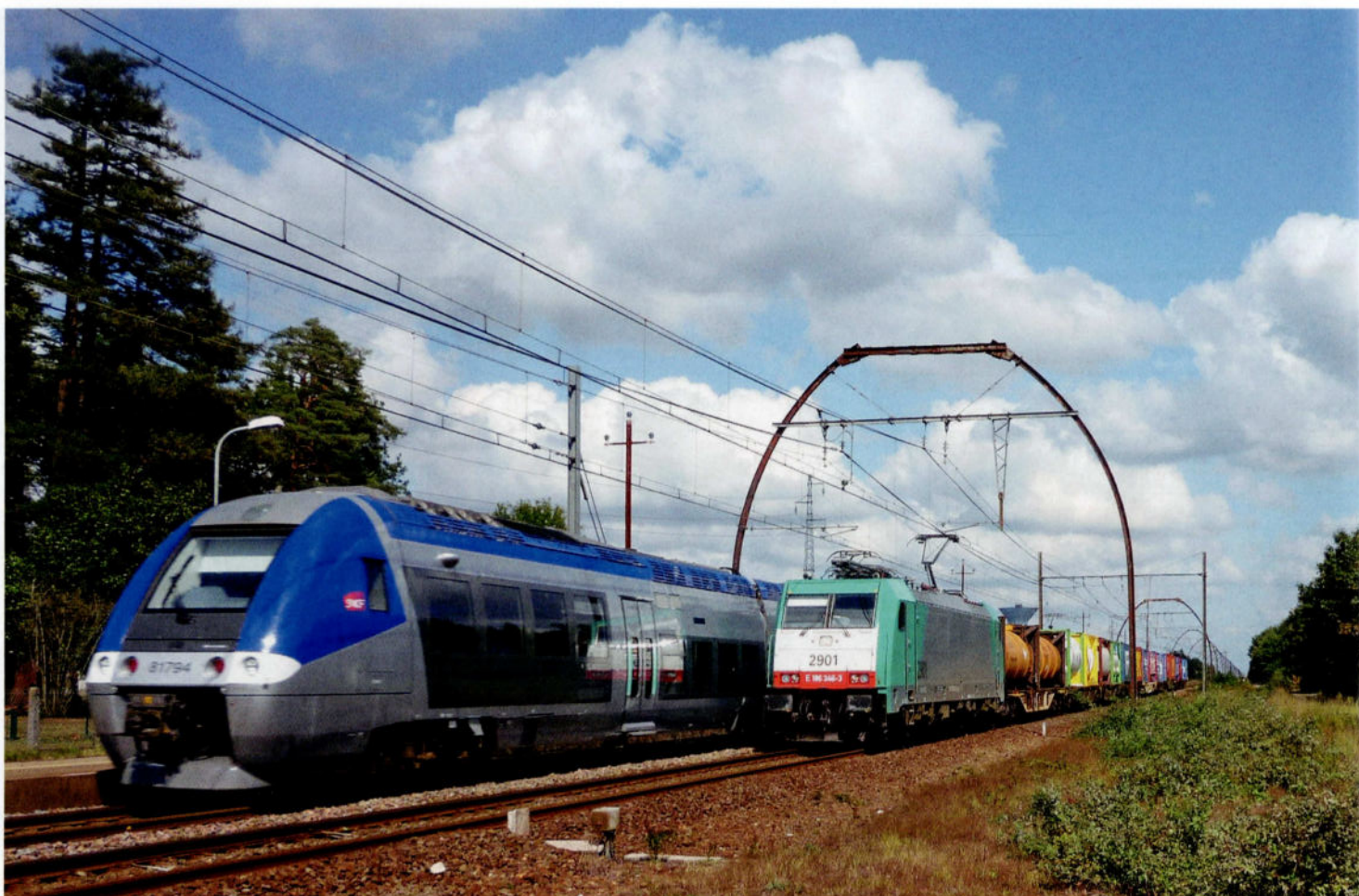
Marcheprime (F), à 20 km au sud de Bordeaux, sur la ligne vers Dax et Irun, le 12 septembre 2010: remorqué par la 2901 SNCF, le train 43194/5 Ronet - Irun y croise le TER 866606 Mont-de-Marsan - Bordeaux. Remarquez les supports de caténaires en forme d'ogive, typiques de l'ancien réseau français 'PO-Midi'. Photo: Luc Ninane.
