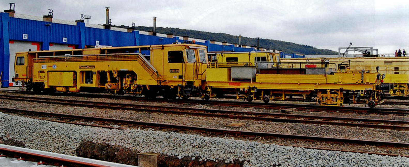
1. La bourreuse-niveleuse-dresseuse (BND) de fabrication Plasser & Theurer (° 1995) immatriculée 99 88 9424262-2, l'une des trois BND du type U08-275 que possède Infrabel. A l'arrière-plan, le hall de maintenance du CLI de Ronet, l'ancien atelier de traction SNCB: remarquez sur le toit les anciennes chiffres en fer forgé datant de la vapeur et qui répertoriaient les voies de l'atelier!
