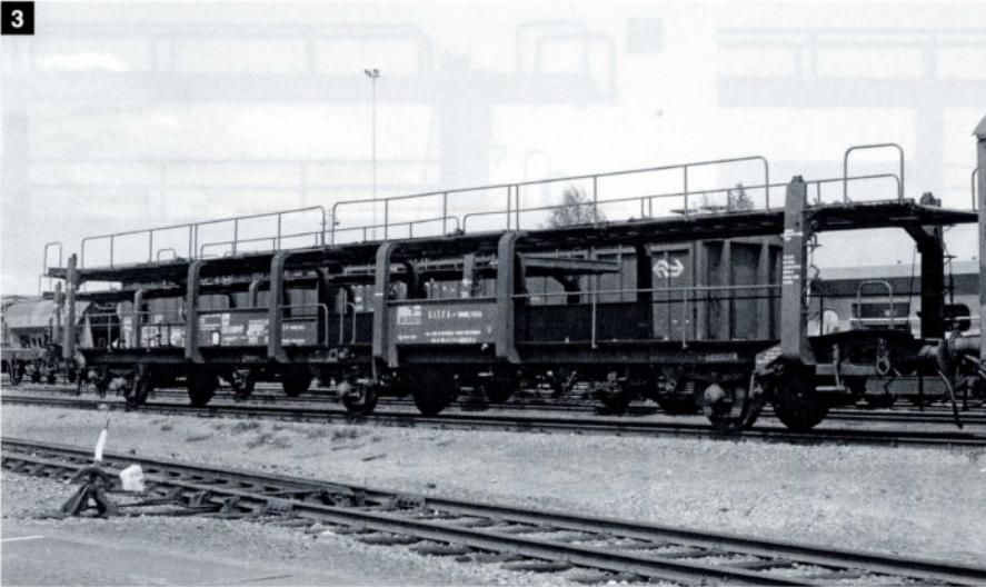
3. Le wagon porte-autos 'Laekkms' 23 RIV 84 NS 426 5 030-1 [P] à Amersfoort, le 27.05.1985. Le marquage [P] derrière le matricule indique qu'il s'agit d'un wagon de particulier, en l'occurrence de la SITFA - TORINO/ITALIA.
