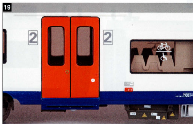
18. Pendant les circulations, les marchepieds sous les portes d'accès sont repliés. Le cercle rond destiné à la commande des portes au moyen d'une clé est généralement de teinte métallique et non en blanc, comme sur cette photo.
