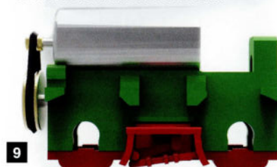
9. La dernière version du projet. On voit clairement les trous en forme de 'C' pour les essieux et la plaque de garde, avec représentation de la timonerie de frein.
