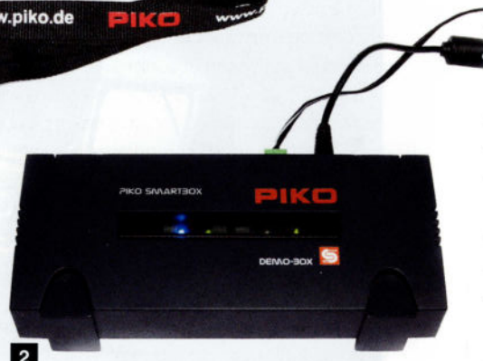
2. La Smart Box relie le système aux rails et assure l'alimentation en énergie. Le statut de cette box peut être lu grâce à une série de Leds. La Led bleue indique une liaison active avec le Smart Controller, la Led jaune à gauche est celle pour le courant continu et la Led jaune à droite indique que l'alimentation est active.
